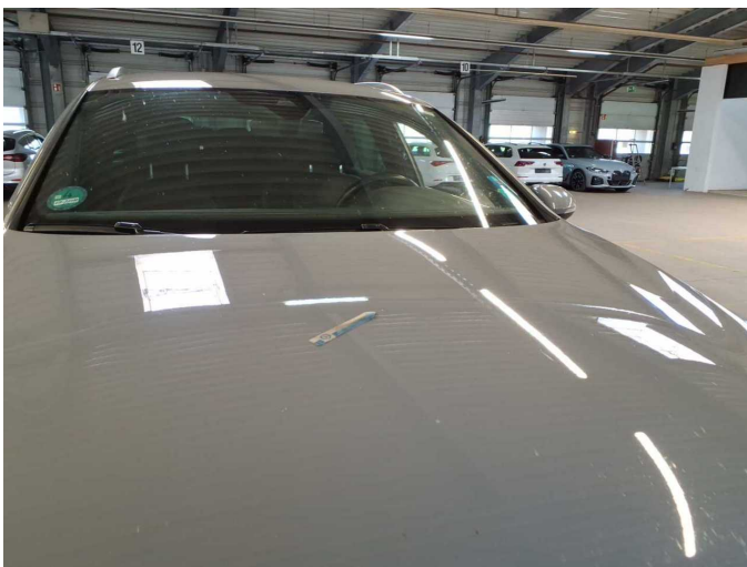
Damage 7: Bonnet: Bonnet (teilweise lackieren) - Dent / paintcoat damage - Paint
