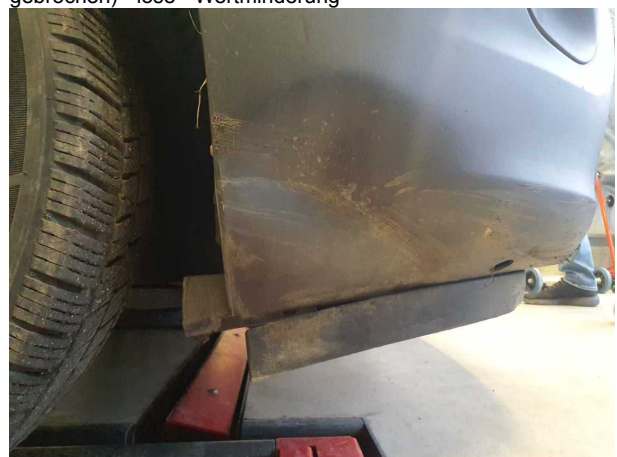
Beschädigung #13: Karosserie: Unterbodenverkleidung (Teils gebrochen) - lose - Wertminderung
