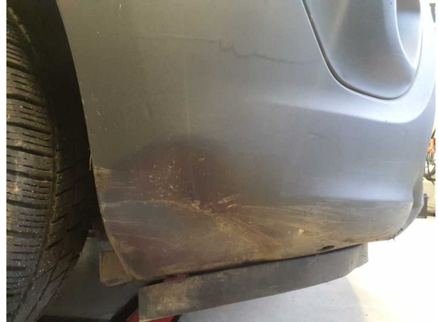
Beschädigung #15: Stossfänger vorn: Stossfänger vorn (unlackiert) - verformt - erneuern
