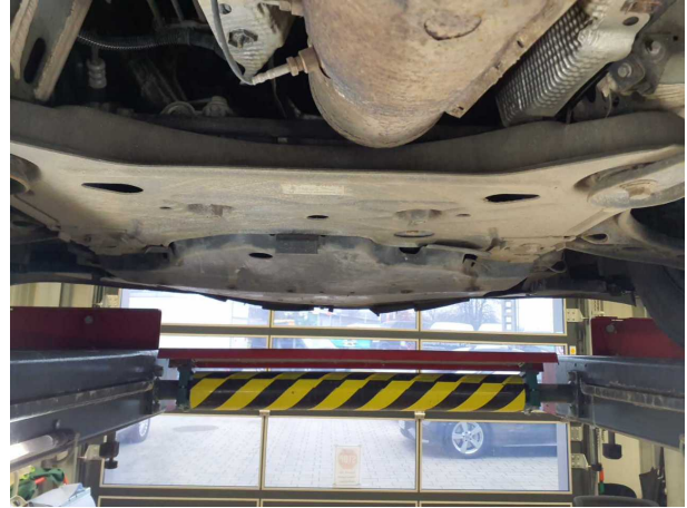
Beschädigung #13: Karosserie: Unterbodenverkleidung (Teils gebrochen) - lose - Wertminderung
