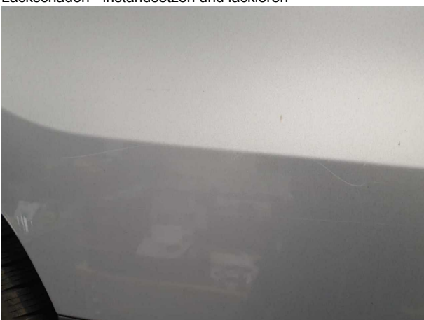
Beschädigung #11: Seitenwand rechts: Seitenwand - Delle / Lackschaden - instandsetzen und lackieren
