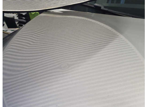
Beschädigung #8: Motorhaube: Motorhaube - Delle / Lackschaden - instandsetzen und lackieren
