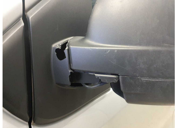
Beschädigung #2: Außenspiegel links: Außenspiegel - beschädigt - erneuern
