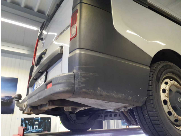
Beschädigung #6: Stossfänger hinten: Stossfänger hinten (unlackiert) - beschädigt - erneuern
