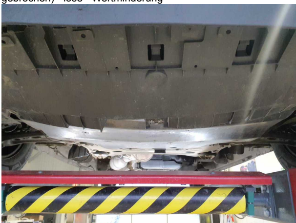
Beschädigung #13: Karosserie: Unterbodenverkleidung (Teils gebrochen) - lose - Wertminderung
