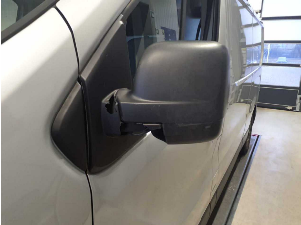
Beschädigung #2: Außenspiegel links: Außenspiegel - beschädigt - erneuern
