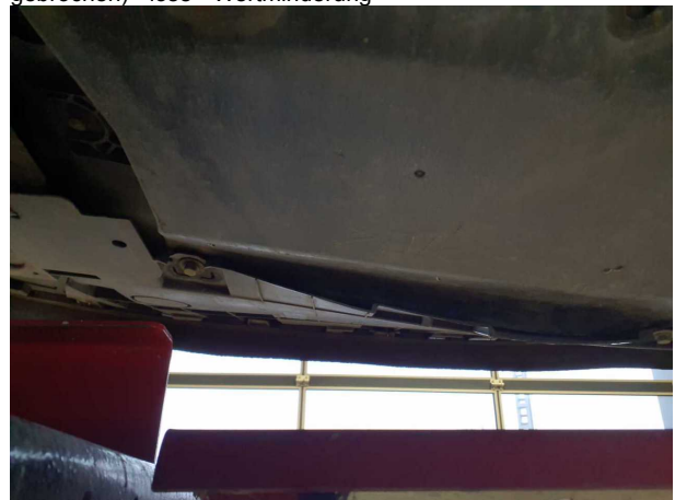
Beschädigung #13: Karosserie: Unterbodenverkleidung (Teils gebrochen) - lose - Wertminderung
