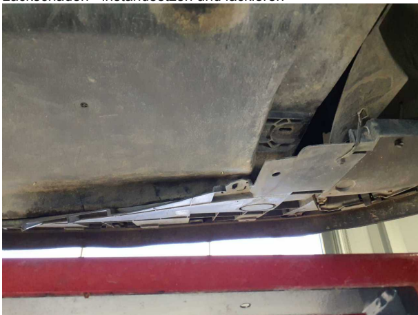
Beschädigung #13: Karosserie: Unterbodenverkleidung (Teils gebrochen) - lose - Wertminderung
