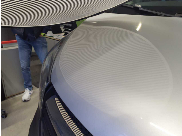
Beschädigung #8: Motorhaube: Motorhaube - Delle / Lackschad... - instandsetzen und lackieren
