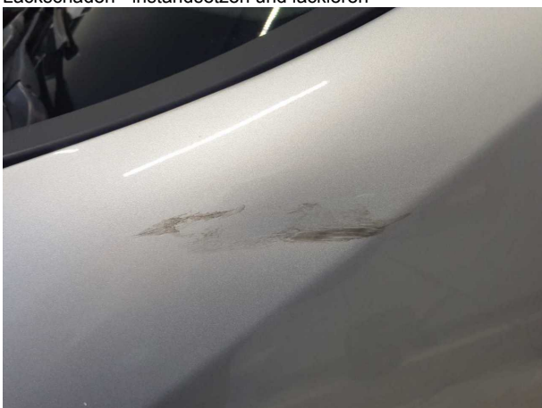
Beschädigung #9: Kotflügel links: Kotflügel links - Delle / Lackschaden - instandsetzen und lackieren
