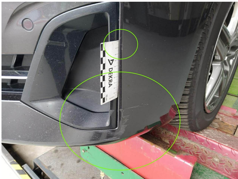
Bild 17 : Stoßfänger vorne Lackierung, verschrammt, lackieren mit Lackaufbau
