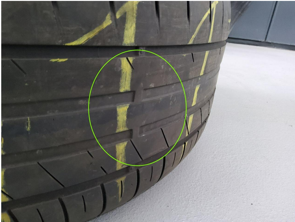
Bild 35 : Achse 1, Reifen 2 Links 1 <2mm Restprofil
