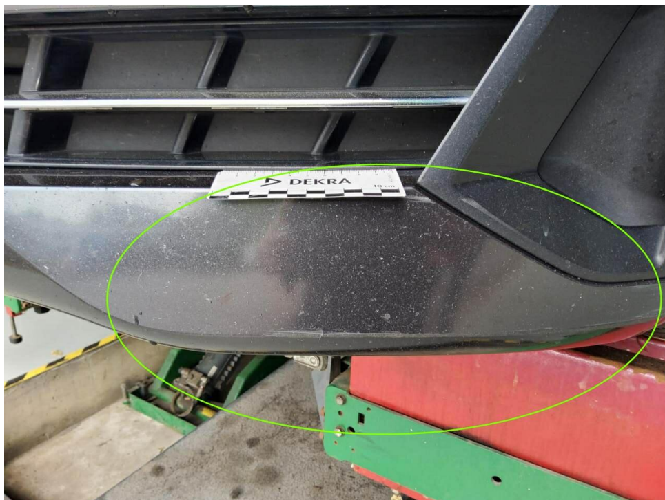
Bild 16 : Stoßfänger vorne Lackierung, verschrammt, lackieren mit Lackaufbau
