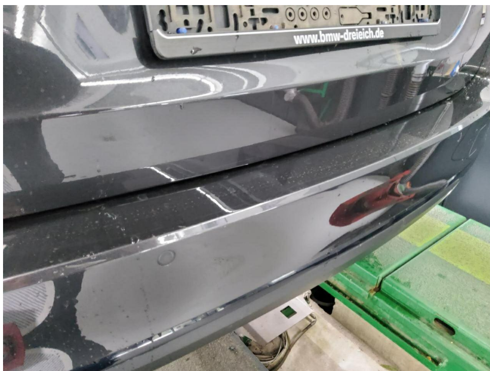
Bild 20 : Stoßfänger hinten Lackierung, zerkratzt, polieren
