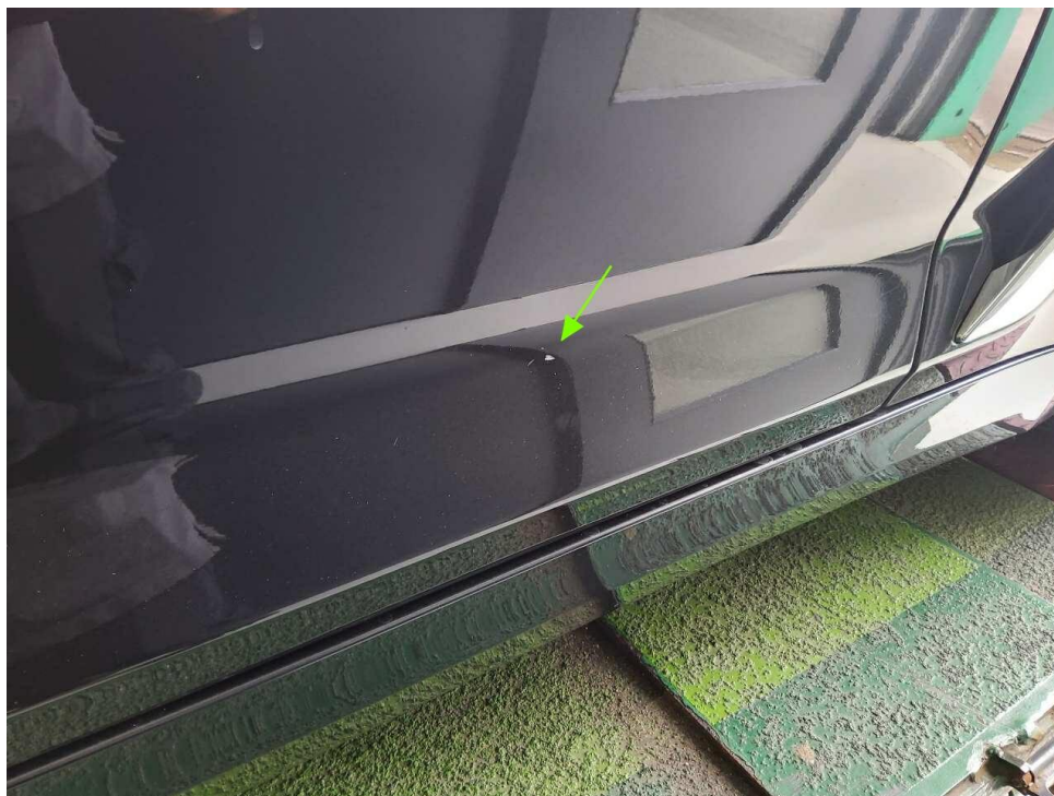
Bild 33 : Tür VR Steinschlag
