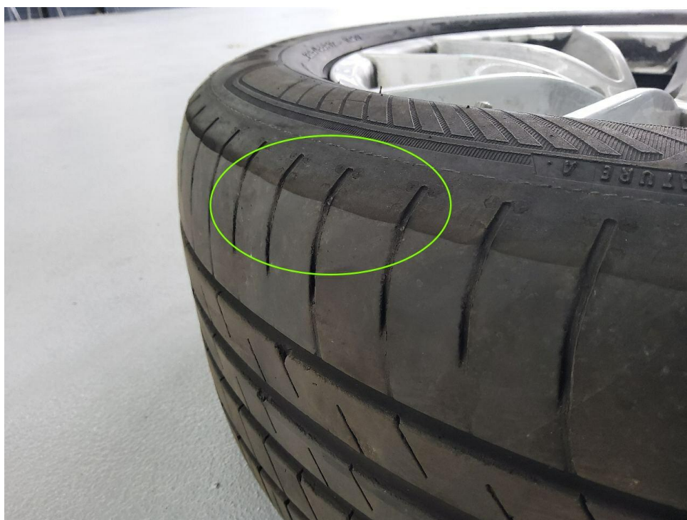
Bild 38 : Achse 2, Reifen 2 Rechts 1 Außenschultern verschlissen
