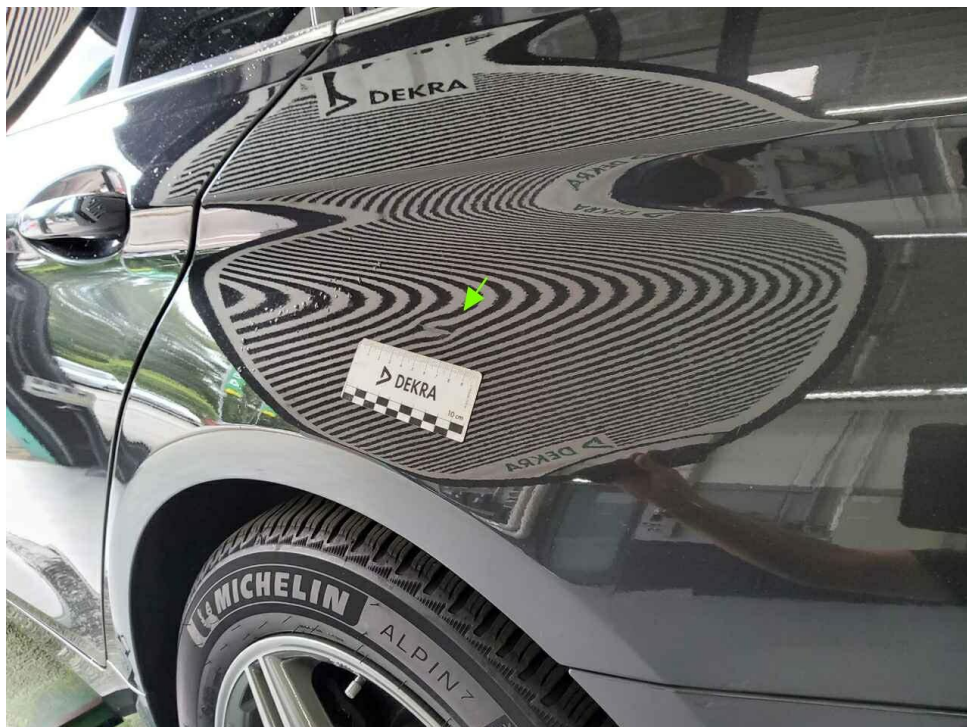
Bild 22 : Seitenteil hinten links, eingedellt, instandsetzen und lackieren mit Lackaufbau
