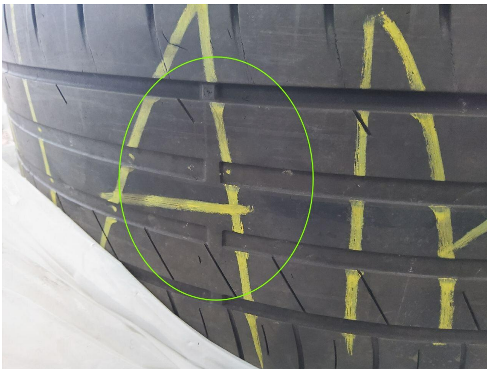
Bild 36 : Achse 1, Reifen 2 Rechts 1 <2mm Restprofil
