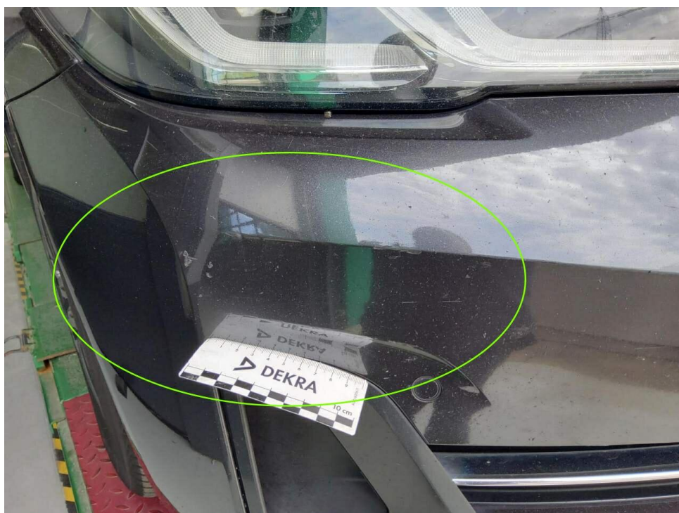
Bild 18 : Stoßfänger vorne Lackierung, verschrammt, lackieren mit Lackaufbau
