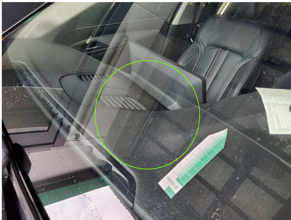
Bild 30 : Frontscheibe übermäßige Steinschläge/ Absplitterung/ Kratzer
