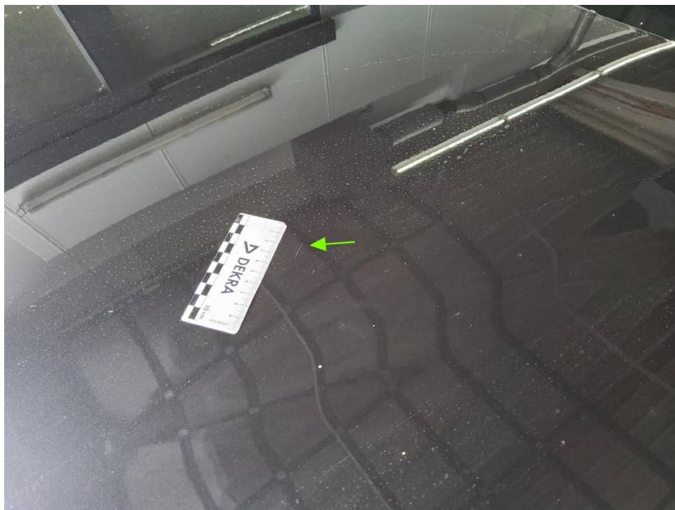
Bild 25 : Motorhaube Lackierung, zerkratzt, polieren
