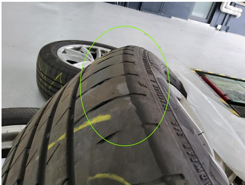
Bild 37 : Achse 2, Reifen 2 Links 1 Außenschultern verschlissen
