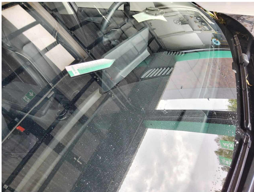
Bild 31 : Frontscheibe übermäßige Steinschläge/ Absplitterung/ Kratzer
