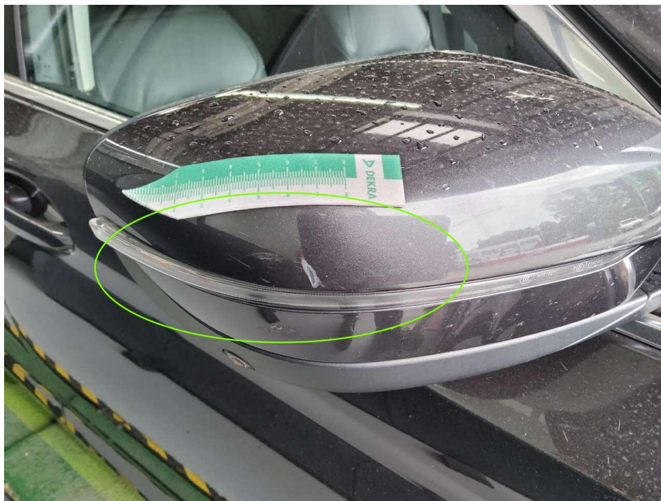
Bild 14 : Außenspiegel rechts Lackierung, verschrammt, smart repair
