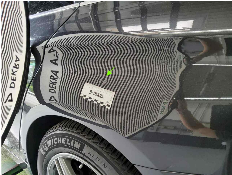
Bild 21 : Seitenteil hinten links, eingedellt, instandsetzen und lackieren mit Lackaufbau
