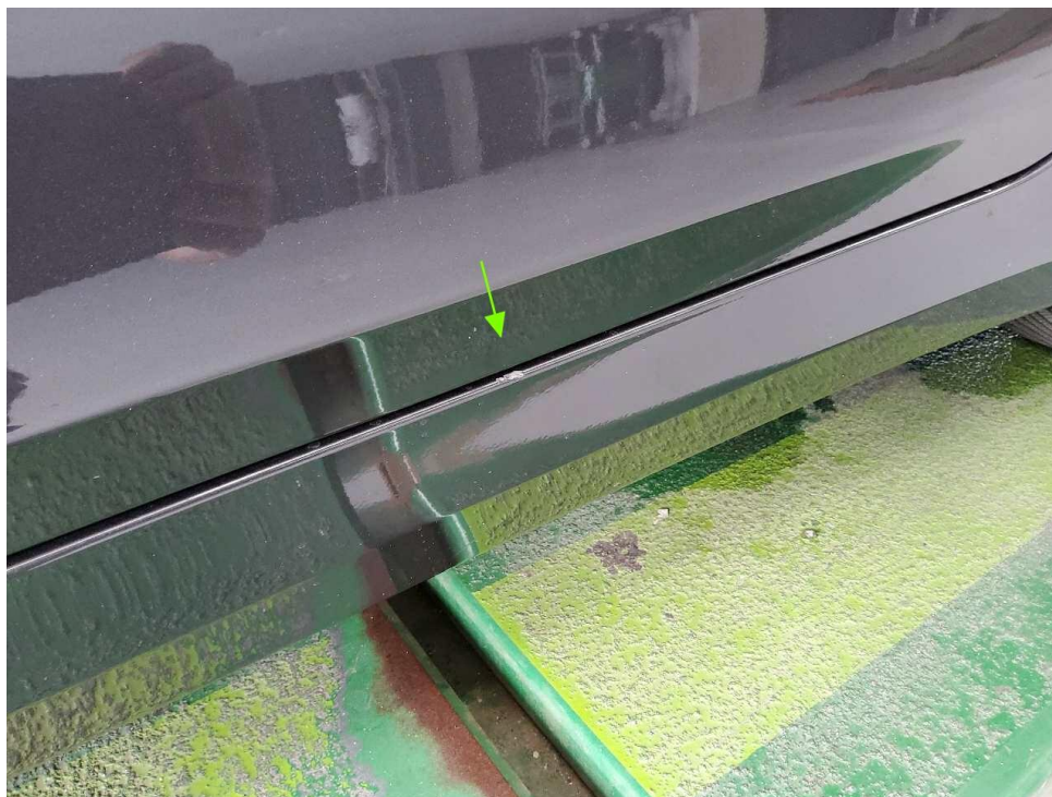
Bild 34 : Schwellerblende links zerkratzt auslegen
