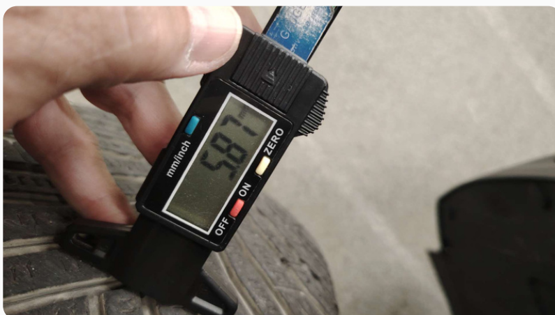
Photo mesure usure pneu avant gauche
