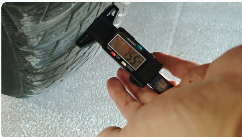
Photo mesure usure pneu arrière gauche
