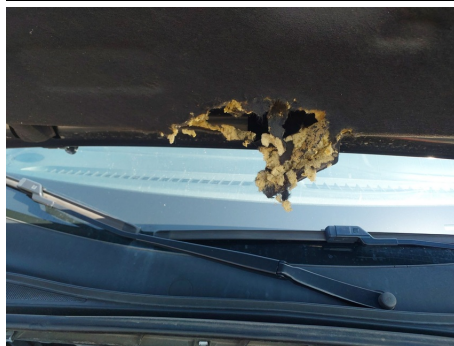
Rivestimento insonorizzazione cofano / - / Rotto
