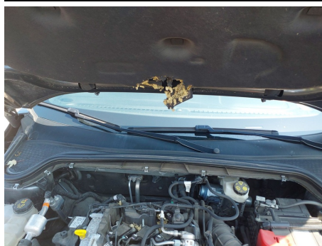
Rivestimento insonorizzazione cofano / - / Rotto
