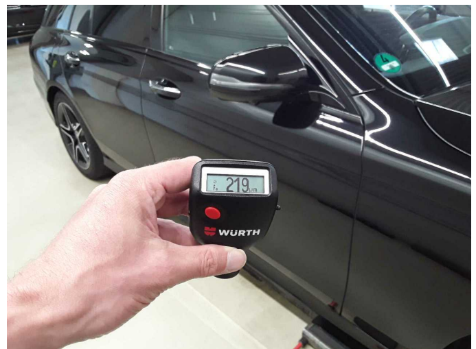
Door - front right side: 219 µm
