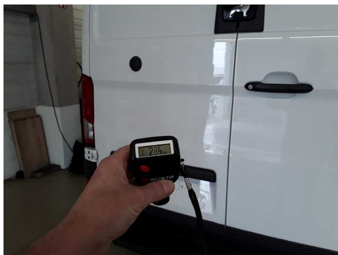
Boot lid / rear door: 284 µm
