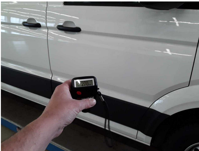
Door - front right side: 270 µm
