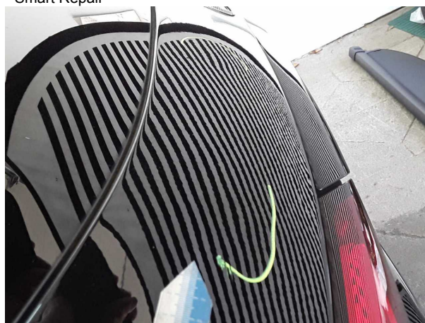
Beschädigung #7: Heckklappe/-tür: Heckklappe - Delle(n) - sanft instandsetzen
