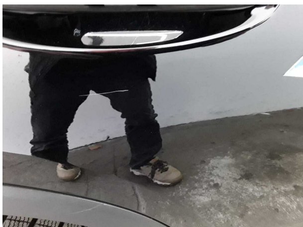
Beschädigung #9: Tür hinten rechts: Tür - Kratzer - lackieren
