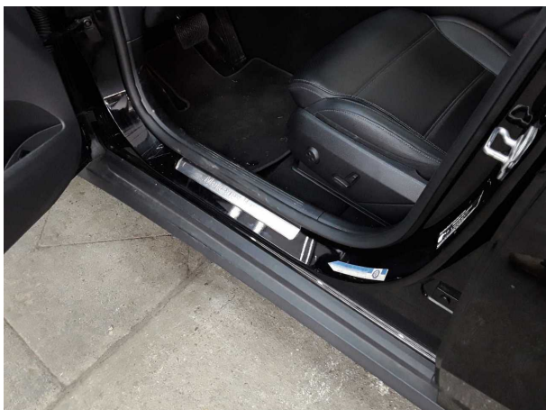
Beschädigung #2: Schweller links: Einstieg - Kratzer - Smart Repair
