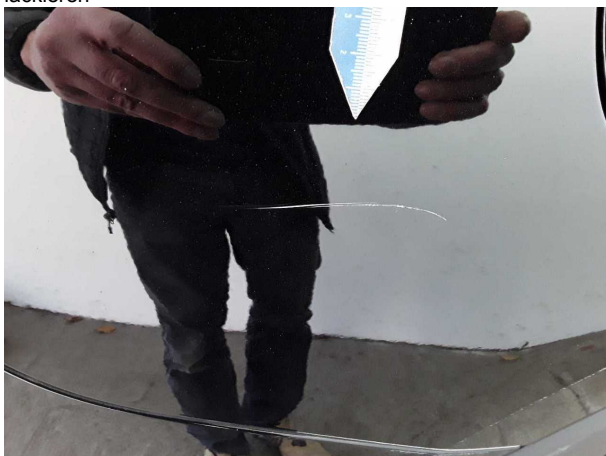
Beschädigung #11: Seitenwand rechts: Seitenwand - Kratzer - lackieren
