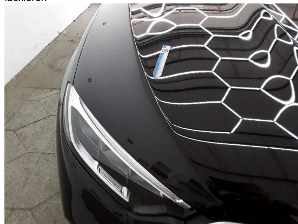
Beschädigung #12: Motorhaube: Motorhaube - Steinschlag - lackieren
