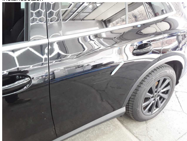
Beschädigung #8: Tür hinten links: Tür - Kratzer - lackieren
