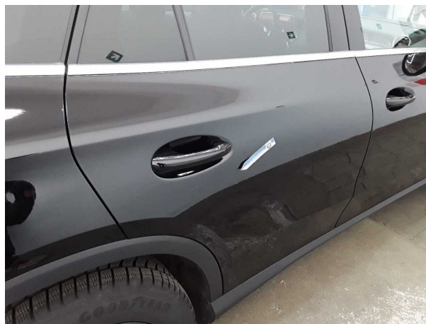
Beschädigung #9: Tür hinten rechts: Tür - Kratzer - lackieren
