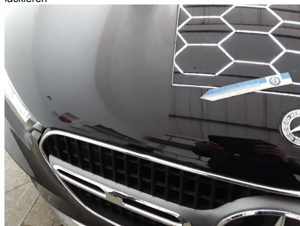
Beschädigung #12: Motorhaube: Motorhaube - Steinschlag - lackieren
