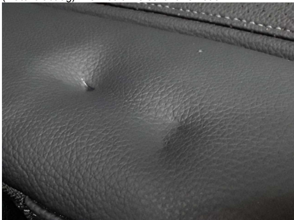
Beschädigung #5: Sitz hinten: Rücksitz (verformt) - beschädigt - Smart Repair
