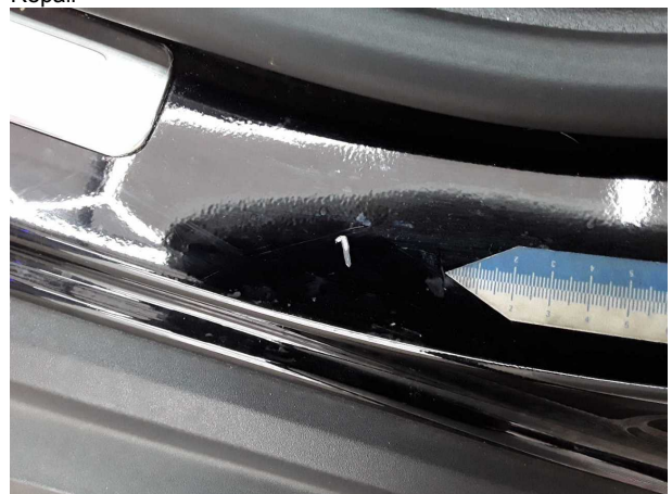
Beschädigung #2: Schweller links: Einstieg - Kratzer - Smart Repair
