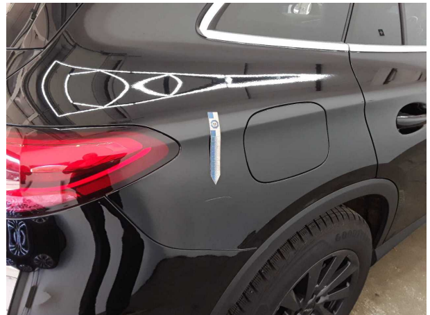
Beschädigung #11: Seitenwand rechts: Seitenwand - Kratzer - lackieren
