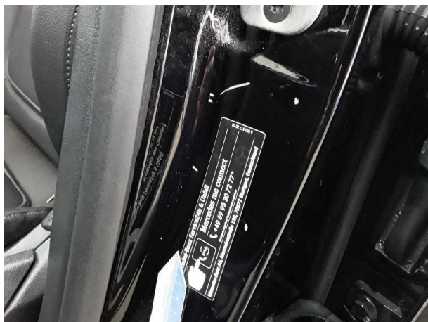
Beschädigung #6: Karosserie: B-Säule links - Delle / Lackschaden - Smart Repair
