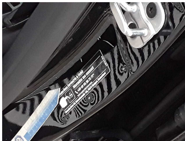
Beschädigung #6: Karosserie: B-Säule links - Delle / Lackschad... - Smart Repair
