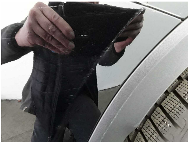
Beschädigung #10: Stossfänger hinten: Stossfänger hinten - Kratzer - lackieren
