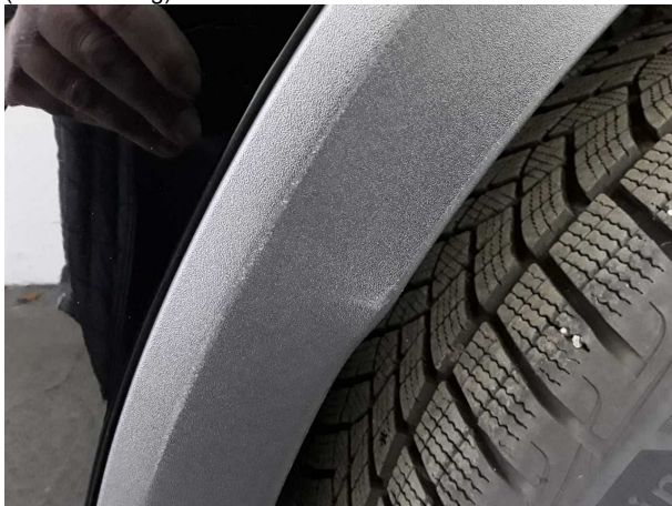
Beschädigung #4: Seitenwand rechts: Radhausverbreiterung (Materialabtrag) - verkratzt / verschürft - erneuern
