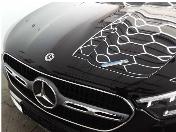
Beschädigung #12: Motorhaube: Motorhaube - Steinschlag - lackieren
