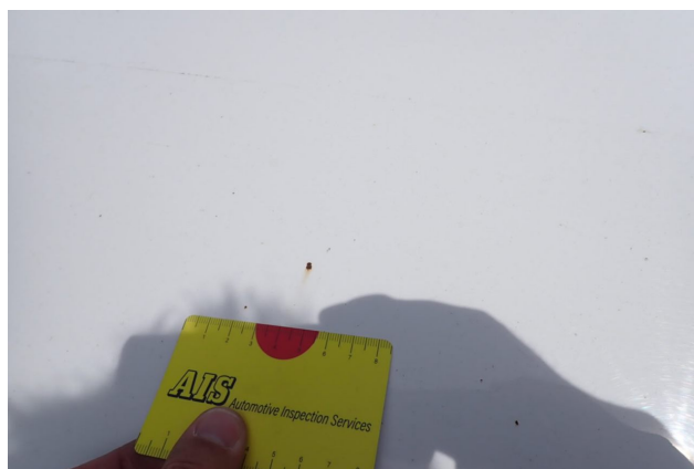
Beschädigung 3: Motor: Motorabdeckung - Steinschlag - kein Abzug
