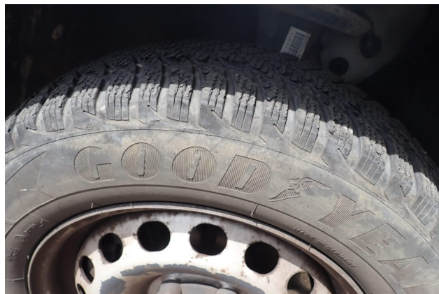
Beschädigung 1: Rad/Reifen: Reifen vorn - beschädigt - erneuern
