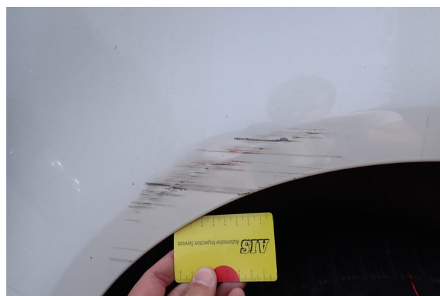
Beschädigung 19: Seitenwand rechts: Seitenwand - Delle / Lackschaden - instandsetzen und lackieren
