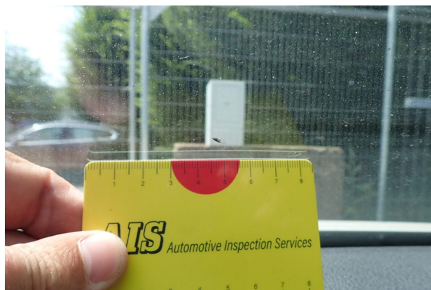
Beschädigung 10: Verglasung: Frontscheibe - Steinschlag - Smart Repair
