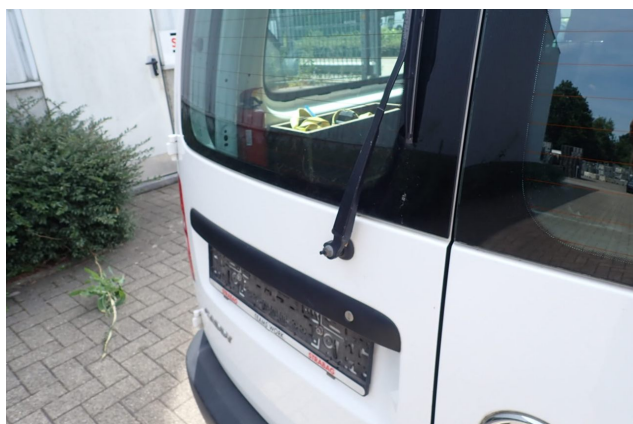
Beschädigung 6: Fahrerhaus: Blende unter Scheibenwischer - fehlt - erneuern
