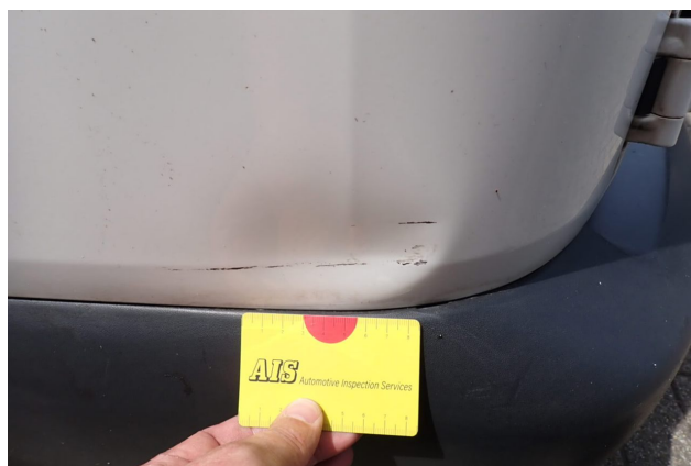
Beschädigung 17: Seitenwand links: Radhausverbreiterung - Delle / Lackschaden - instandsetzen und lackieren
