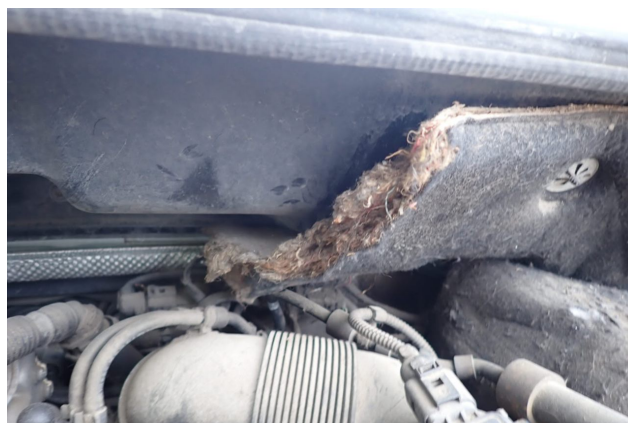
Beschädigung 4: Motorhaube: Dämmmatte - beschädigt - kein Abzug
