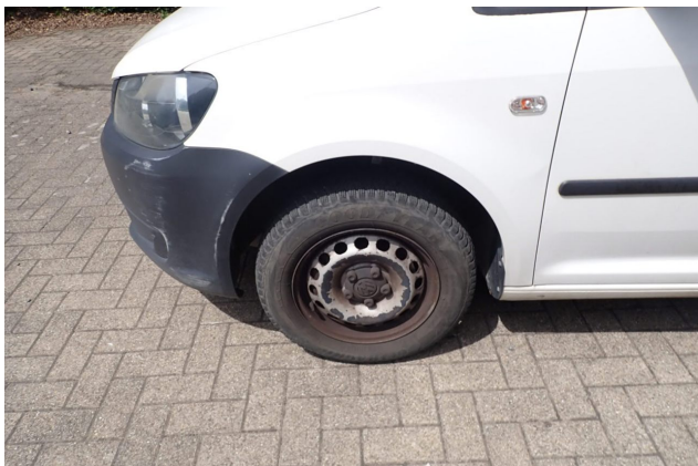
Beschädigung 1: Rad/Reifen: Reifen vorn - beschädigt - erneuern
