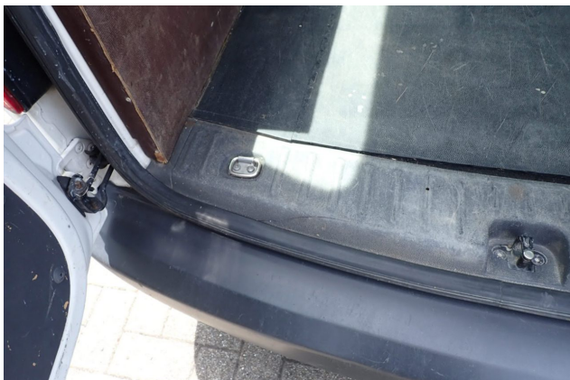
Beschädigung 8: Karosserie: Dichtung Heckdeckel /-tür - gebrochen / gerissen - erneuern
