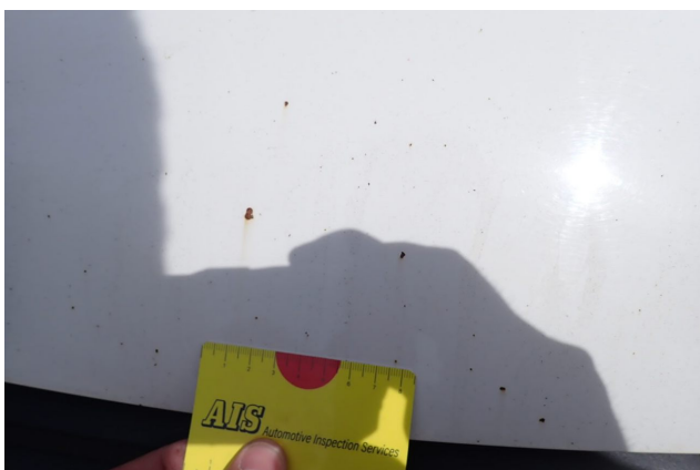
Beschädigung 3: Motor: Motorabdeckung - Steinschlag - kein Abzug
