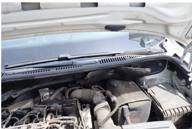
Beschädigung 4: Motorhaube: Dämmmatte - beschädigt - kein Abzug
