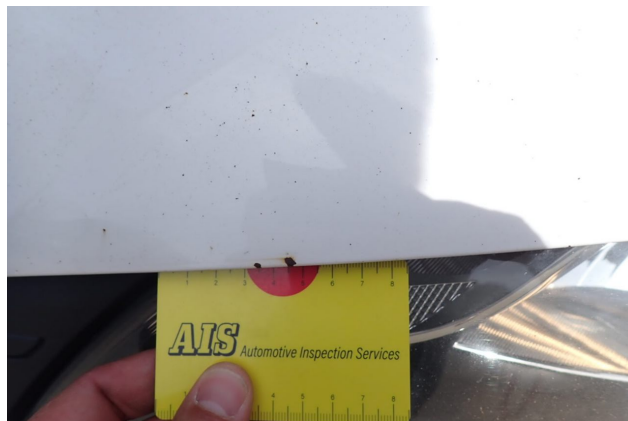
Beschädigung 3: Motor: Motorabdeckung - Steinschlag - kein Abzug
