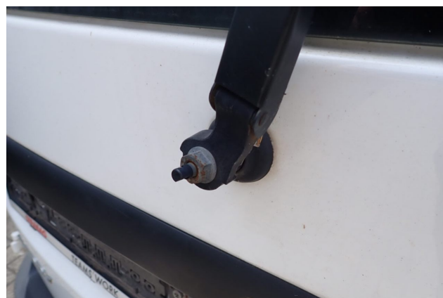
Beschädigung 6: Fahrerhaus: Blende unter Scheibenwischer - fehlt - erneuern
