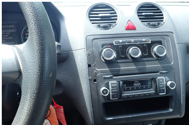
Gebrauchsspur 3: Instrumententafel: Mittelkonsole vorn - Löcher - kein Abzug
