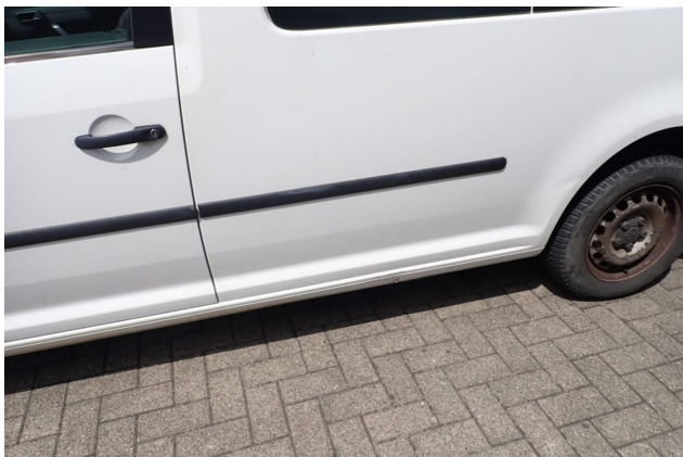
Beschädigung 11: Schweller links: Schweller - Delle / Lackschaden - instandsetzen und lackieren
