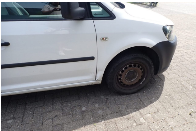
Beschädigung 16: Kotflügel rechts: Kotflügel rechts - Delle / Lackschaden - instandsetzen und lackieren
