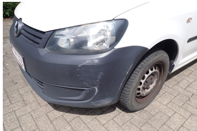
Beschädigung 18: Stossfänger vorn: Stossfänger vorn (unlackiert) - verkratzt / verschürft - erneuern
