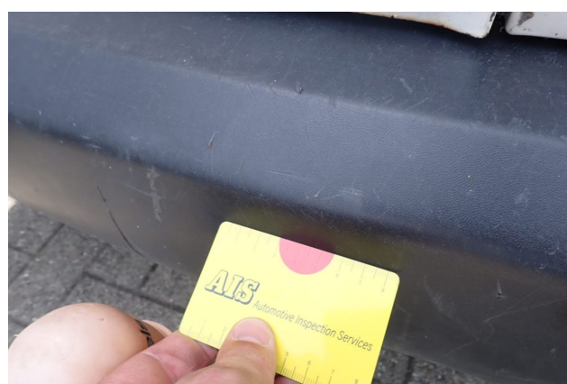
Gebrauchsspur 2: Stossfänger hinten: Stossfänger hinten (unlackiert) - verkratzt / verschürft - kein Abzug
