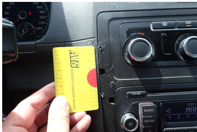
Gebrauchsspur 3: Instrumententafel: Mittelkonsole vorn - Löcher - kein Abzug
