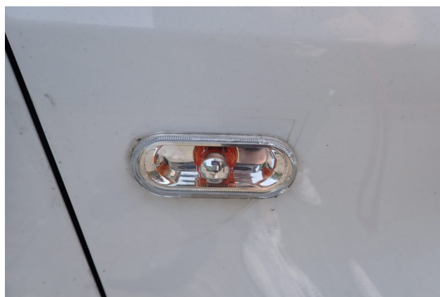
Beschädigung 9: Blinkleuchte: Blinkleuchte vorn rechts - gebrochen / gerissen - erneuern
