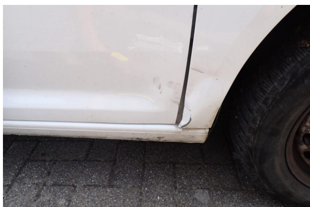
Beschädigung 15: Tür vorn rechts: Tür - Delle / Lackschaden - instandsetzen und lackieren
