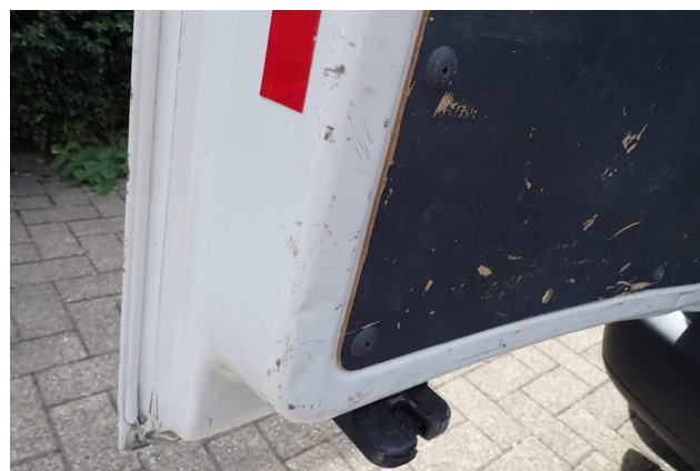
Beschädigung 14: Heckklappe/-tür: Hecktür links - Delle / Lackschaden - instandsetzen und lackieren
