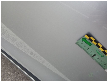
Porta / Anteriore Sinistro / Ammaccato vernice incisa
