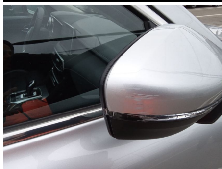
Calotta retrovisore / Anteriore Destro / Graffio
