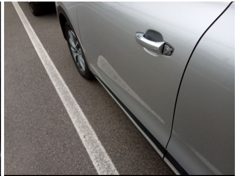
Porta / Anteriore Sinistro / Ammaccato vernice incisa
