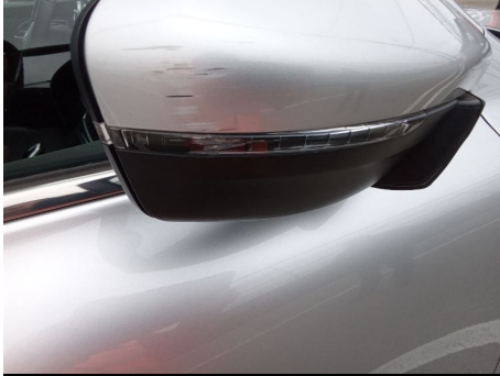
Indicatore di direzione / Anteriore Destro / Graffio
