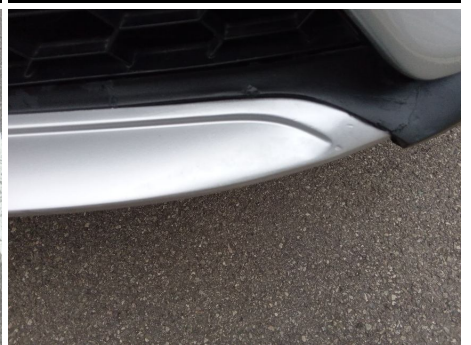
Spoiler / Anteriore / Ammaccato vernice incisa
