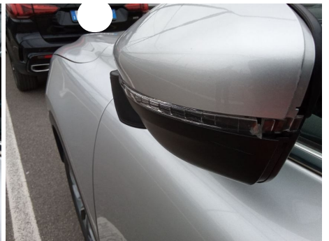
Indicatore di direzione / Anteriore Sinistro / Rotto
