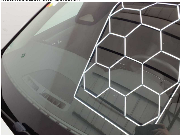
Beschädigung #7: Verglasung: Frontscheibe - Steinschlag - erneuern
