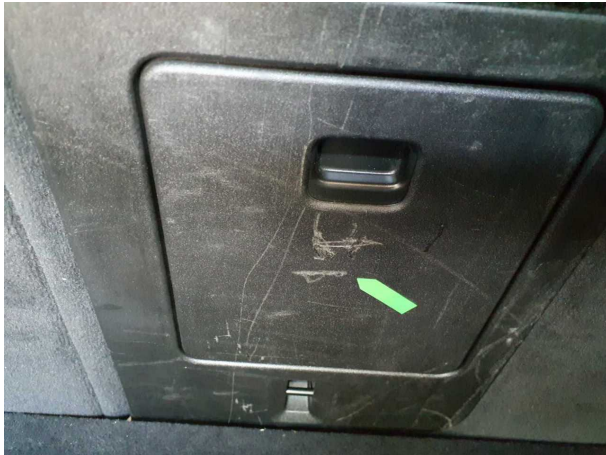
Beschädigung #3: Sitz hinten: Rücksitz (Armlehne Verkleidung) - verkratzt / verschürft - erneuern
