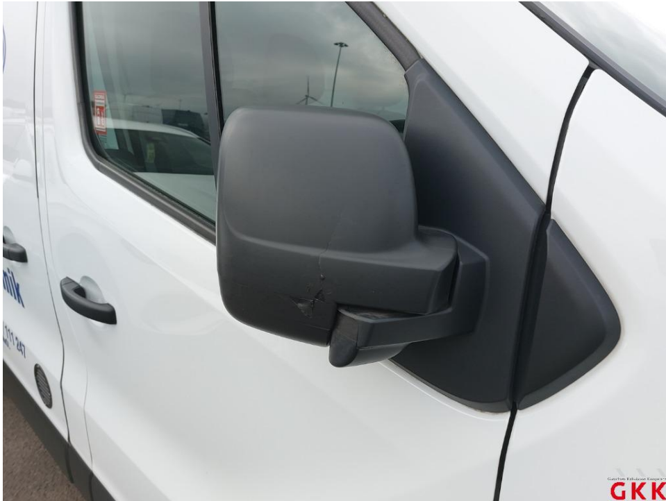
Bild 31. Spiegelgehäuse rechts, Kappe -unlackiert-, gerissen, ersetzen
