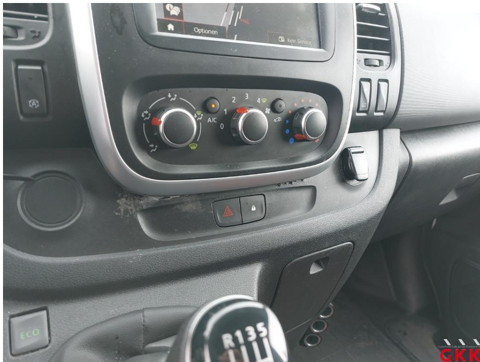
Bild 34. Armaturenbrett, Blende, beschädigt, ersetzen
