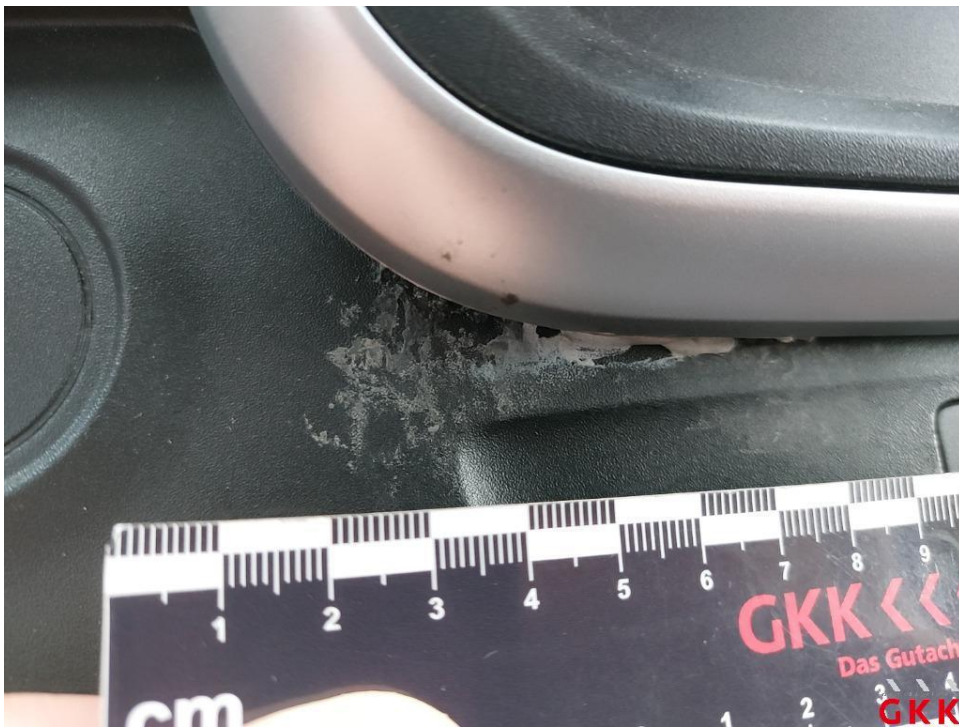
Bild 36. Armaturenbrett, Blende, beschädigt, ersetzen
