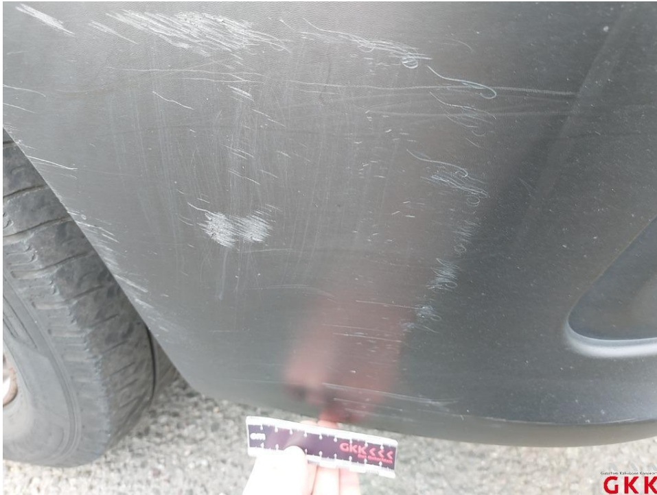
Bild 23. Stoßfänger vorne, Verkleidung -teillackiert-, beschädigt, ersetzen
