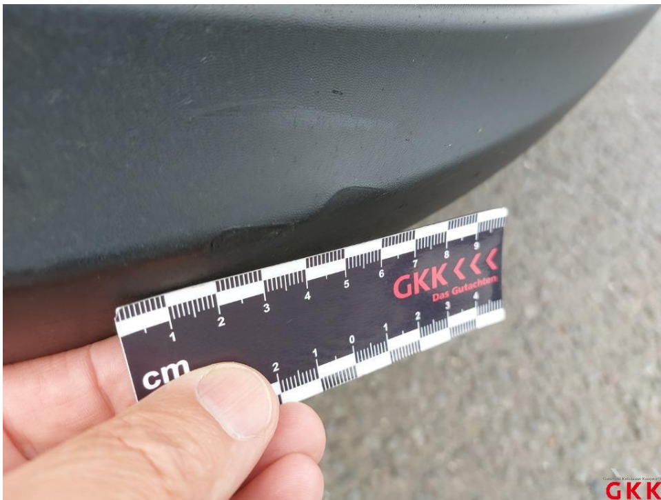
Bild 22. Stoßfänger vorne, Verkleidung -teillackiert-, beschädigt, ersetzen
