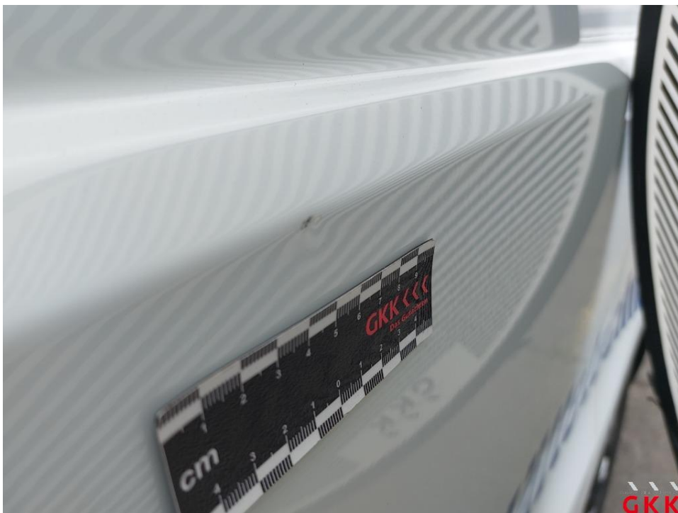
Bild 19. Seitenwand links, vorne, beschädigt, instand setzen - lackieren
