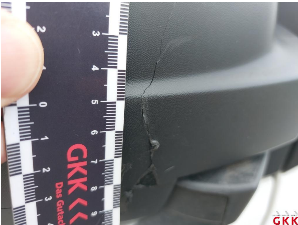
Bild 32. Spiegelgehäuse rechts, Kappe -unlackiert-, gerissen, ersetzen
