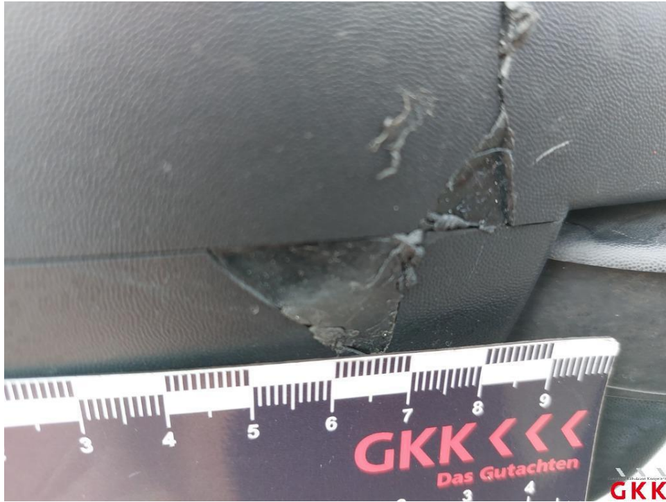
Bild 33. Spiegelgehäuse rechts, Kappe -unlackiert-, gerissen, ersetzen
