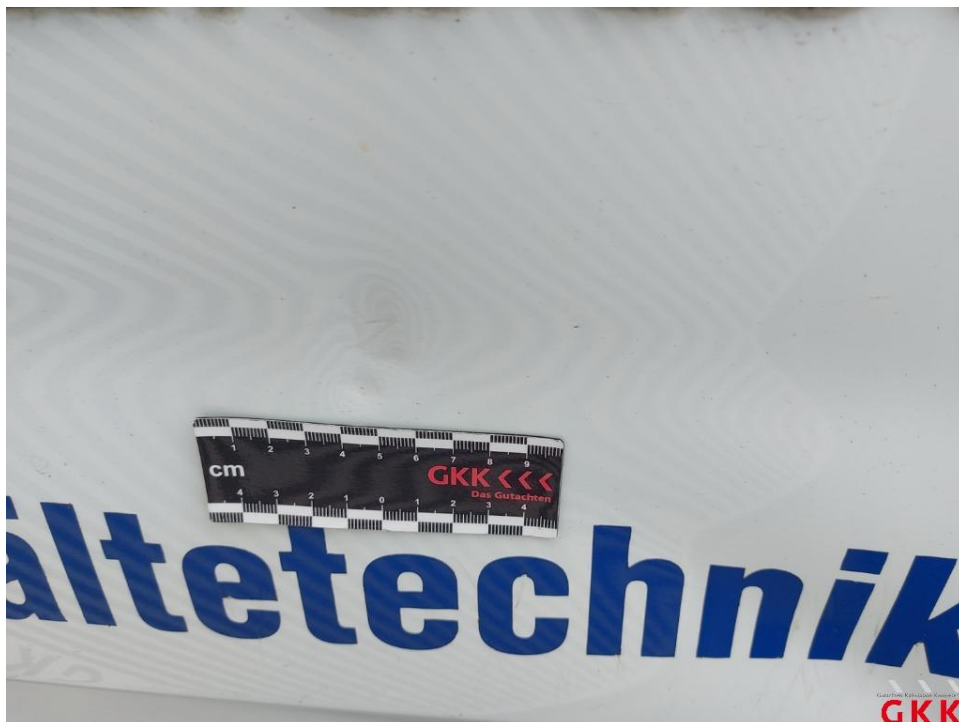
Bild 25. Hecktür rechts, beschädigt, ersetzen
