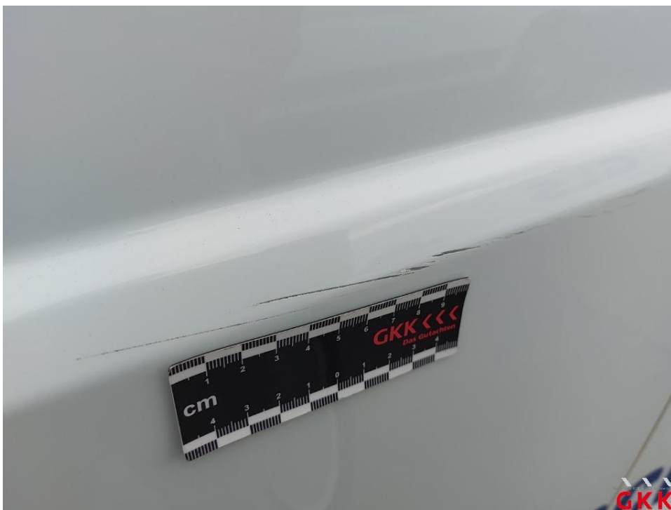
Bild 20. Seitenwand links, vorne, beschädigt, instand setzen - lackieren
