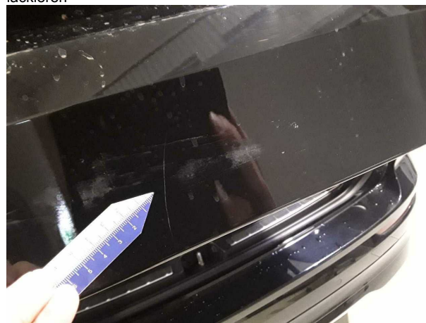
Beschädigung #7: Heckklappe/-tür: Heckklappe - Kratzer - lackieren
