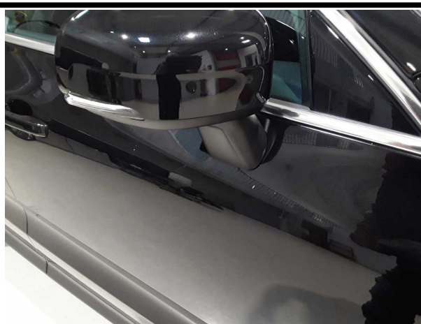
Beschädigung #5: Karosserie: Karosserie (Harzflecken) - Lackmangel - aufbereiten
