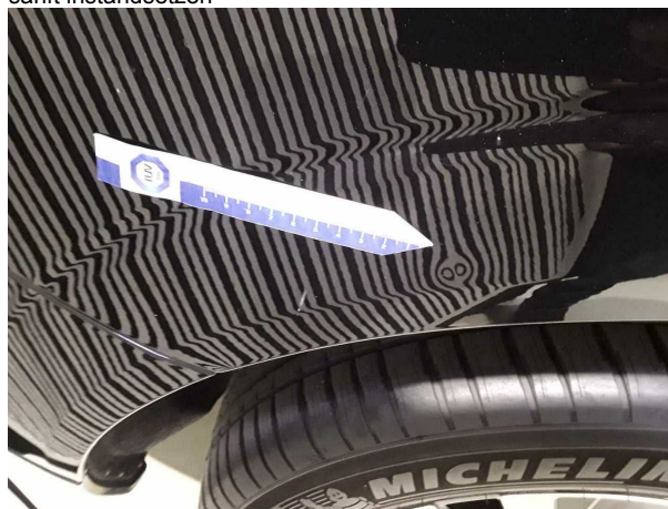
Beschädigung #2: Seitenwand rechts: Seitenwand - Delle(n) - sanft instandsetzen
