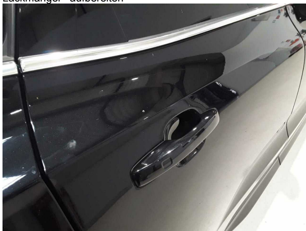
Beschädigung #5: Karosserie: Karosserie (Harzflecken) - Lackmangel - aufbereiten
