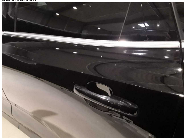
Beschädigung #5: Karosserie: Karosserie (Harzflecken) - Lackmangel - aufbereiten
