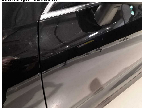
Beschädigung #5: Karosserie: Karosserie (Harzflecken) - Lackmangel - aufbereiten
