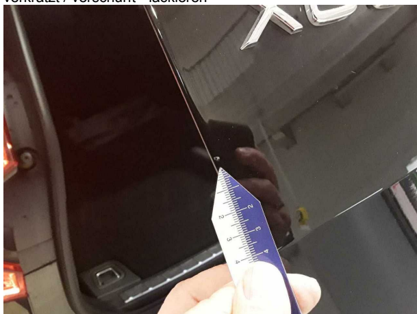
Beschädigung #7: Heckklappe/-tür: Heckklappe - Kratzer - lackieren
