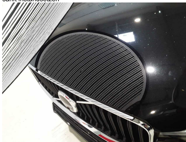
Beschädigung #3: Motorhaube: Motorhaube - Delle(n) - sanft instandsetzen
