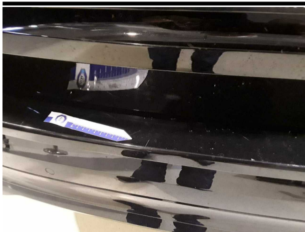
Beschädigung #6: Stossfänger hinten: Stossfänger hinten - verkratzt / verschürft - lackieren
