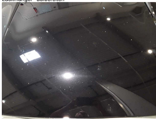
Beschädigung #5: Karosserie: Karosserie (Harzflecken) - Lackmangel - aufbereiten
