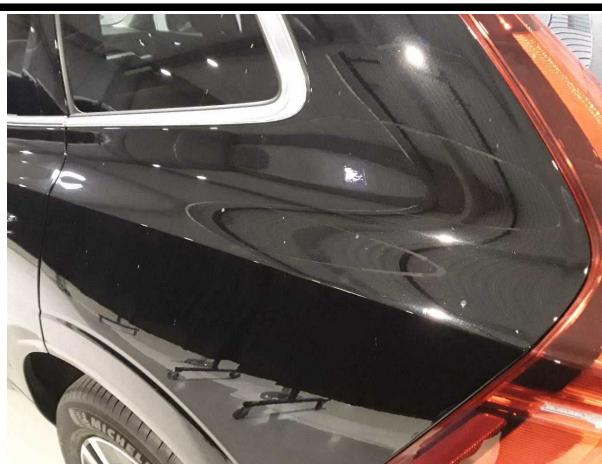
Beschädigung #5: Karosserie: Karosserie (Harzflecken) - Lackmangel - aufbereiten
