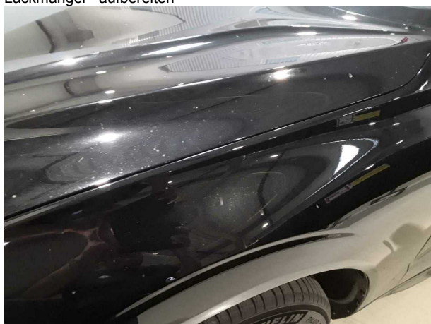
Beschädigung #5: Karosserie: Karosserie (Harzflecken) - Lackmangel - aufbereiten
