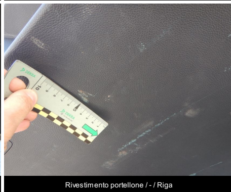
Rivestimento portellone / Posteriore Sinistro / Riga
