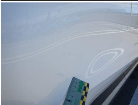
Porta / Posteriore Destro / Difetto di Esecuzione
