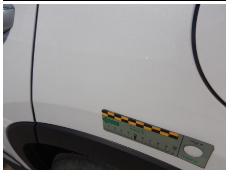
Parafango / Posteriore Sinistro / Rientranza
