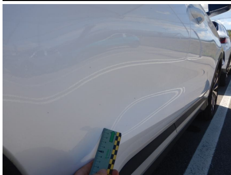
Porta / Posteriore Destro / Difetto di Esecuzione
