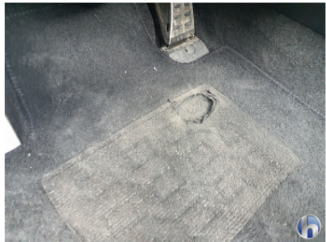
3. Fußraum Innenraum links vorne Loch - Erneuern
