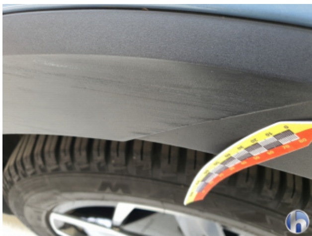
6. Radlaufverbreiterung li.hi. Beschädigt - Erneuern
