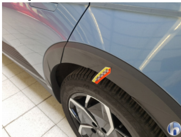
6. Radlaufverbreiterung li.hi. Beschädigt - Erneuern
