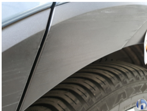
6. Radlaufverbreiterung li.hi. Beschädigt - Erneuern
