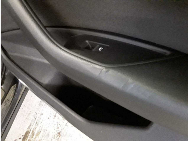
Beschädigung #2: Verkleidungen/Abdeckungen: Türverkleidung hinten rechts (Druckstellen) - kein Abzug
