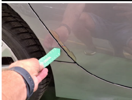
Door / Back Right / Non Compliant
