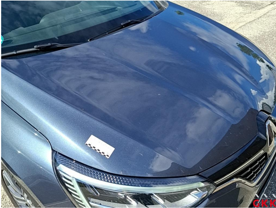
Bild 29. Motorhaube, Steinschlag und Kratzer, auslegen, schleifen, polieren
