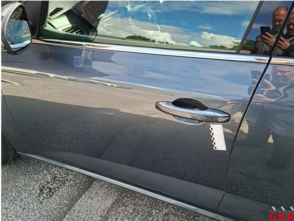
Bild 27. Tür vorne links, beschädigt, instand setzen - lackieren
