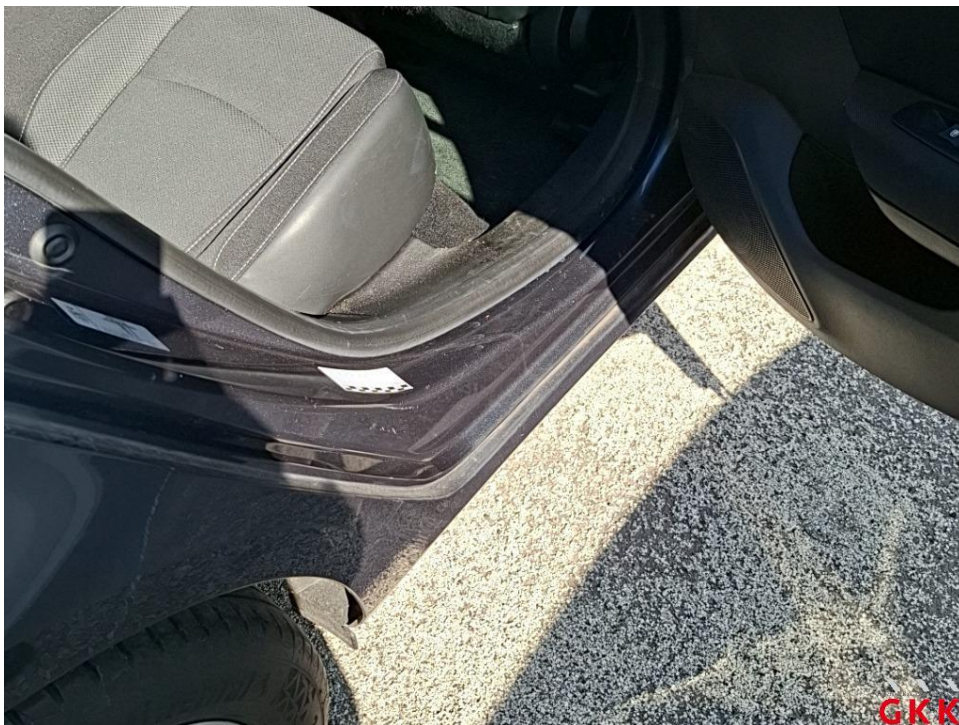
Bild 40. Tür hinten rechts, Einstieg, verkratzt, auslegen, schleifen, polieren
