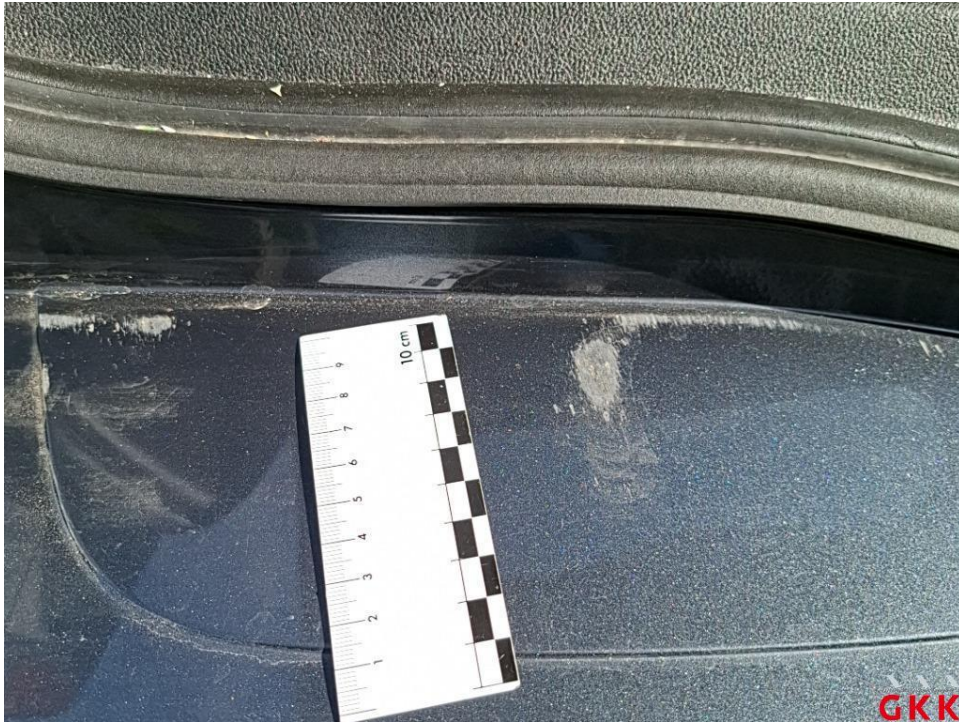
Bild 15. Stoßfänger hinten, Verkleidung -lackiert-, verkratzt, lackieren
