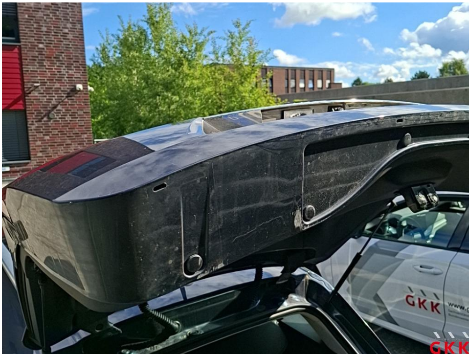
Bild 12. Heckklappe, Blende -lackiert-, verkratzt, lackieren
