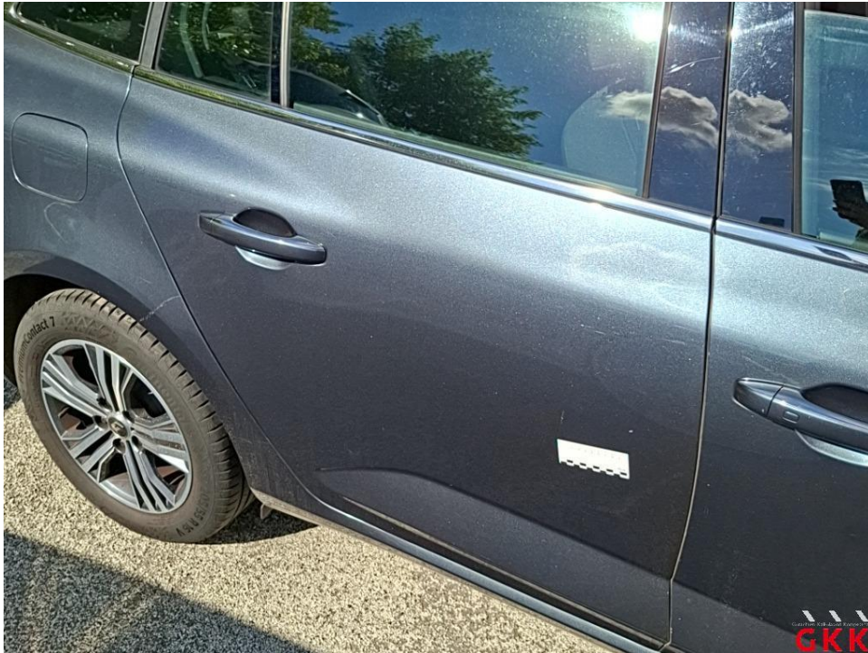
Bild 35. Tür hinten rechts, verkratzt, lackieren
