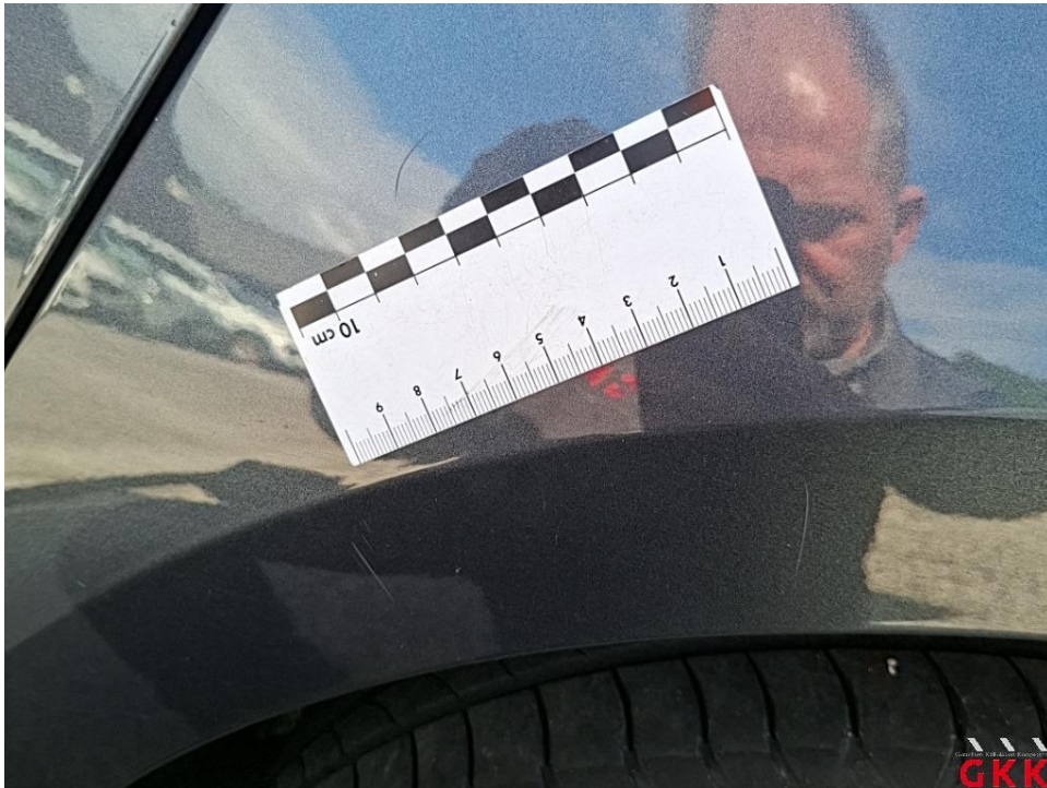
Bild 24. Seitenwand links, verkratzt, auslegen, schleifen, polieren
