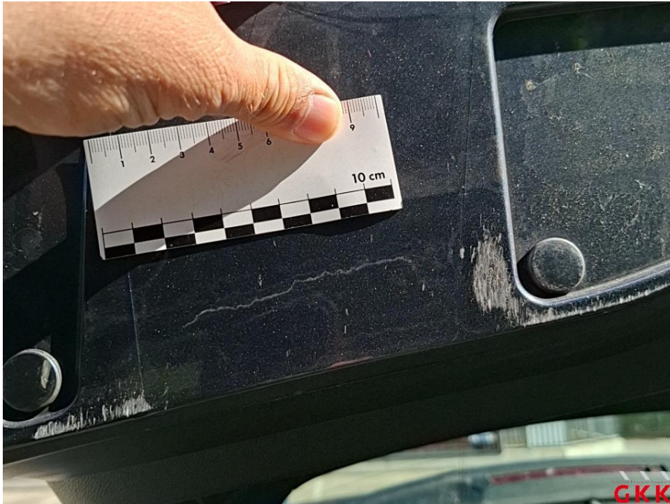
Bild 13. Heckklappe, Blende -lackiert-, verkratzt, lackieren
