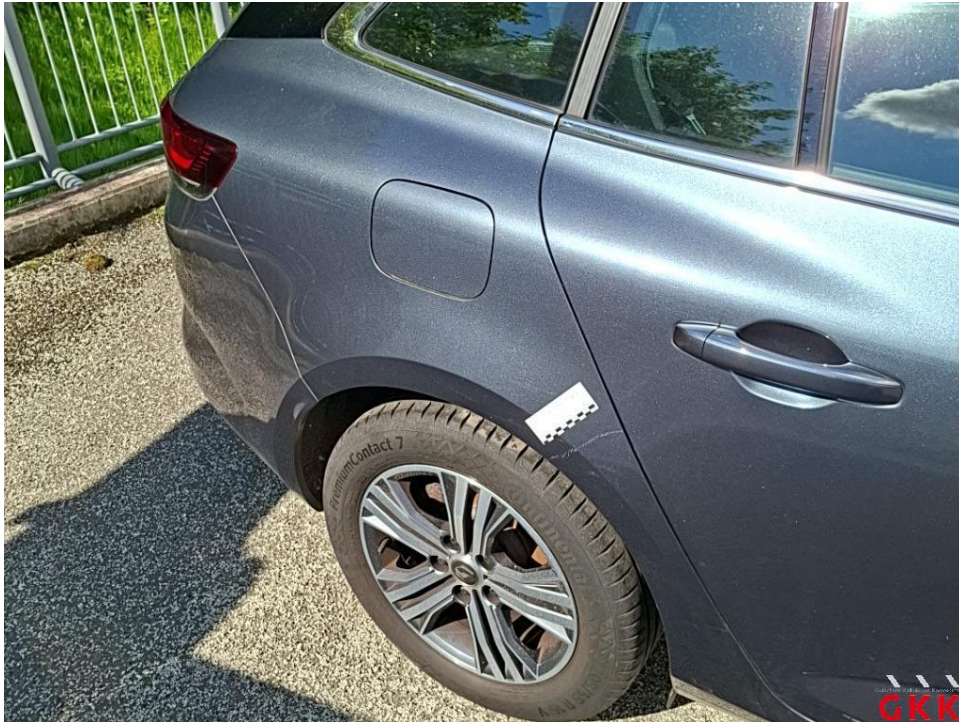
Bild 37. Seitenwand rechts, verkratzt, lackieren
