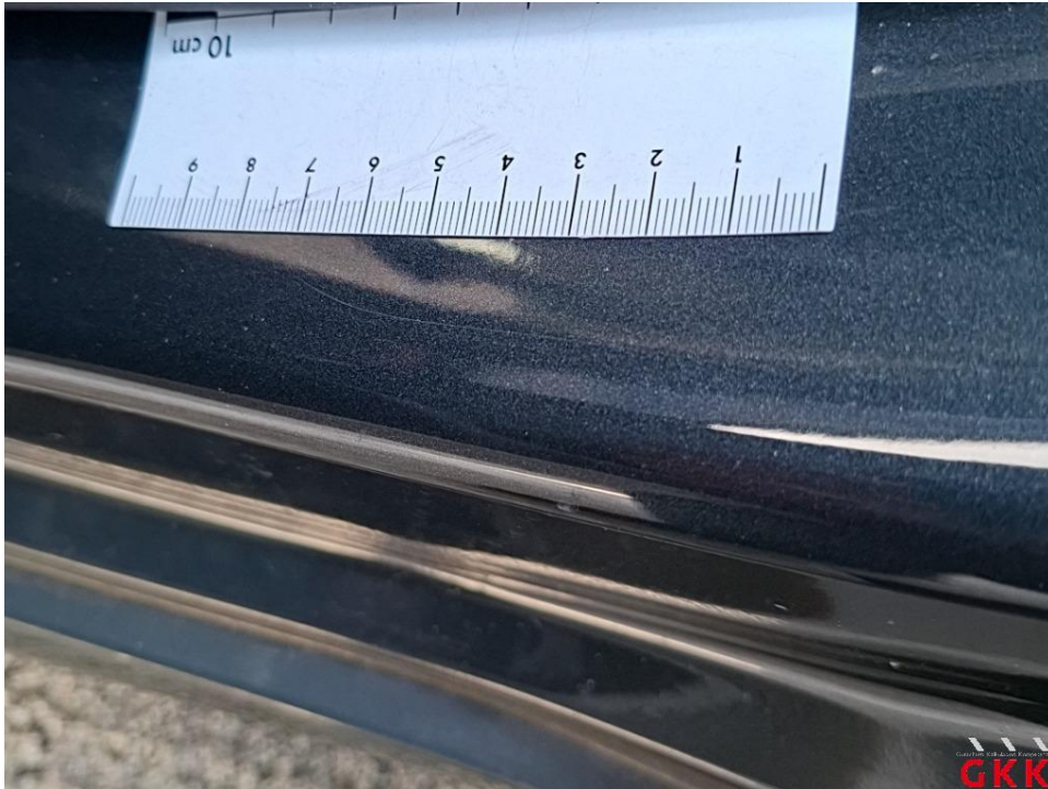
Bild 21. Tür hinten links, Einstieg, verkratzt, Smartrepair
