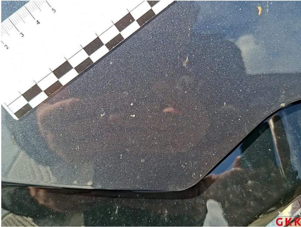
Bild 31. Motorhaube, Steinschlag und Kratzer, auslegen, schleifen, polieren
