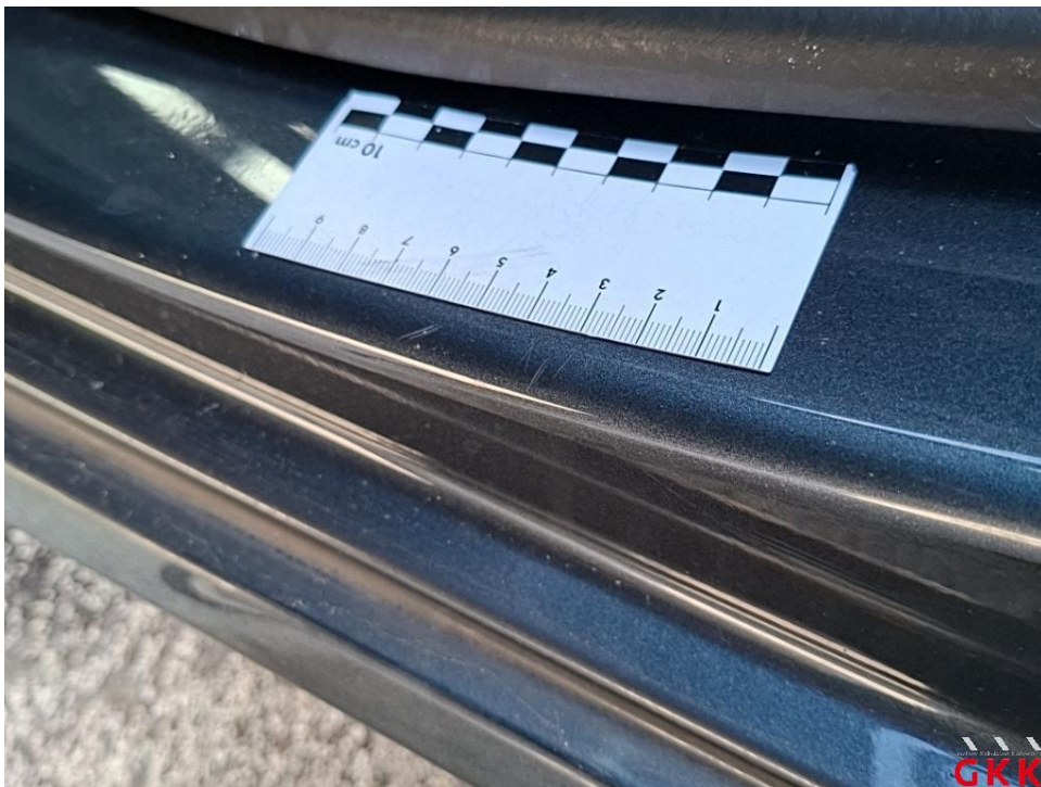
Bild 22. Tür hinten links, Einstieg, verkratzt, Smartrepair
