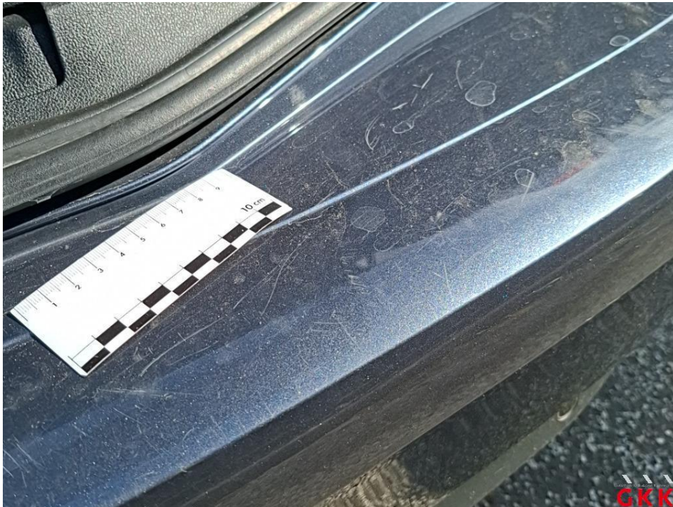
Bild 16. Stoßfänger hinten, Verkleidung -lackiert-, verkratzt, lackieren
