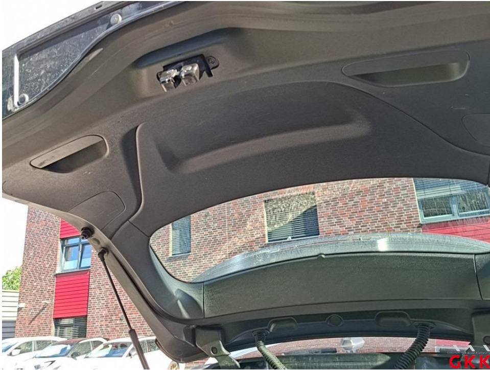
Bild 17. Heckklappe, Innenverkleidung, verkratzt, ersetzen
