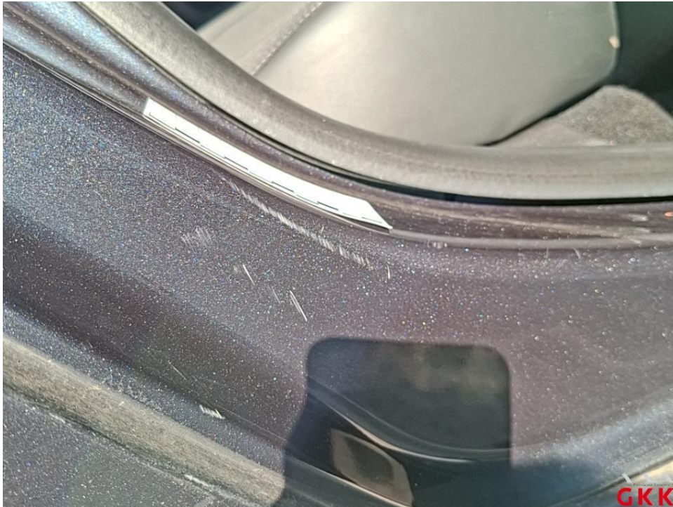
Bild 41. Tür hinten rechts, Einstieg, verkratzt, auslegen, schleifen, polieren
