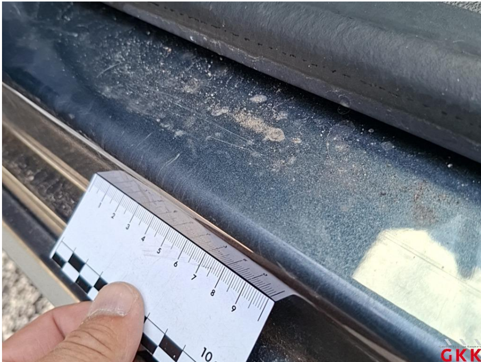
Bild 44. Tür vorne links, Einstieg, verkratzt, lackieren
