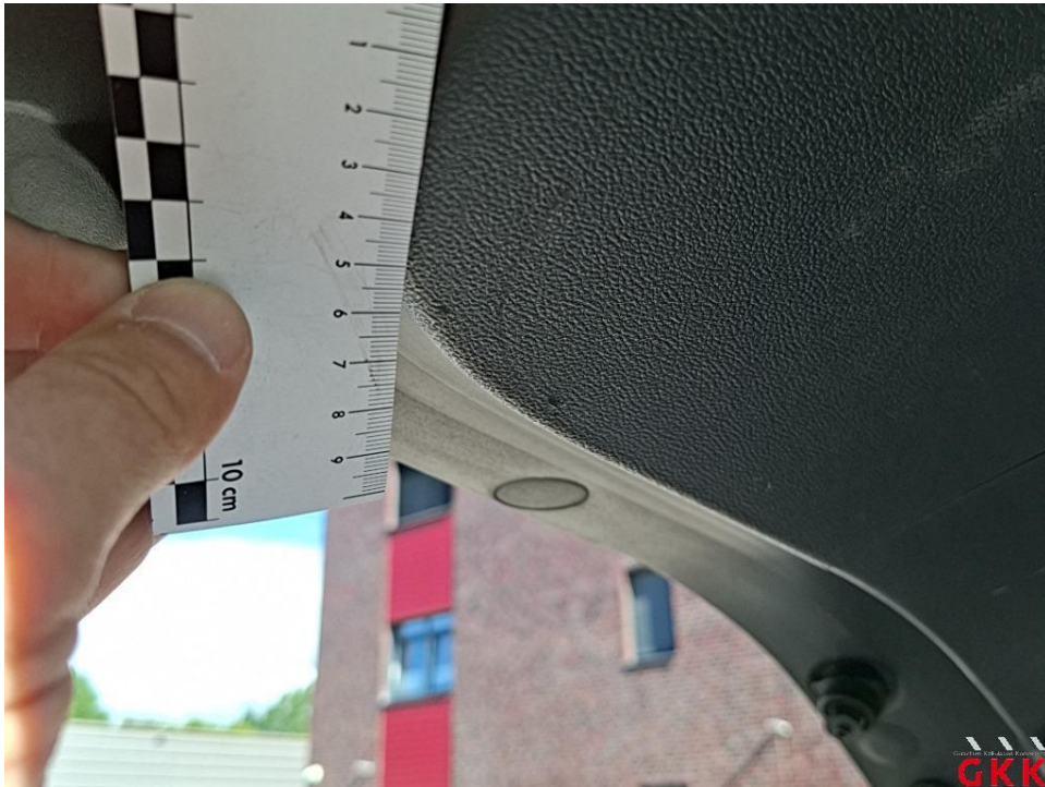
Bild 18. Heckklappe, Innenverkleidung, verkratzt, ersetzen
