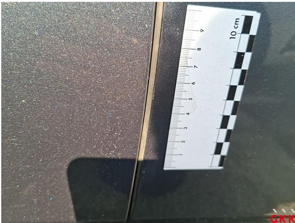
Bild 34. Tür vorne rechts, Kante, verkratzt, auslegen, schleifen, polieren
