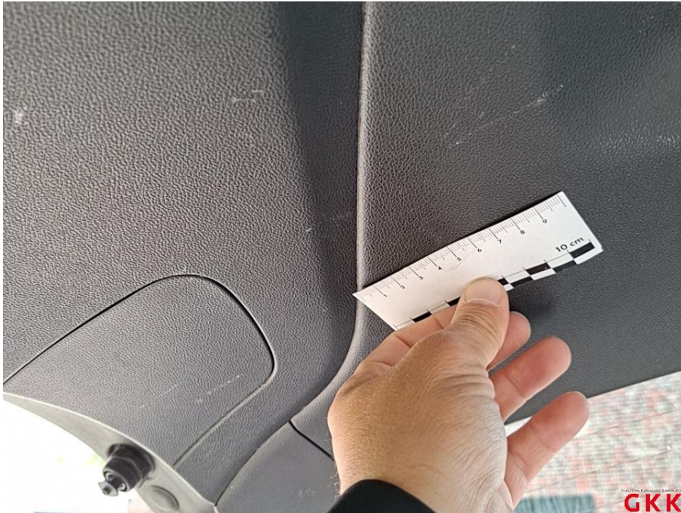
Bild 19. Heckklappe, Innenverkleidung, verkratzt, ersetzen
