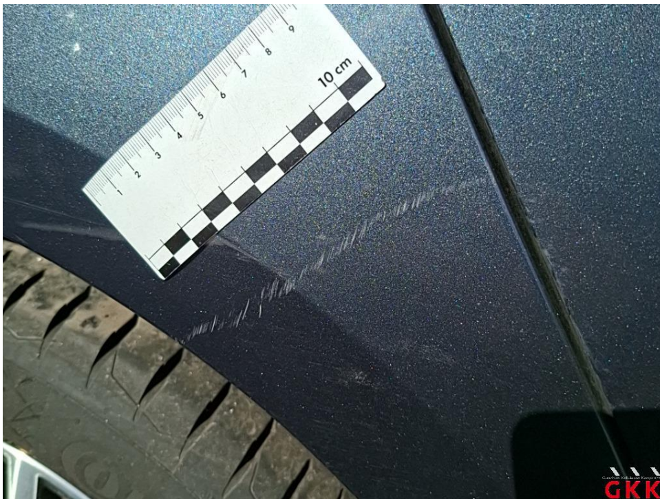
Bild 38. Seitenwand rechts, verkratzt, lackieren
