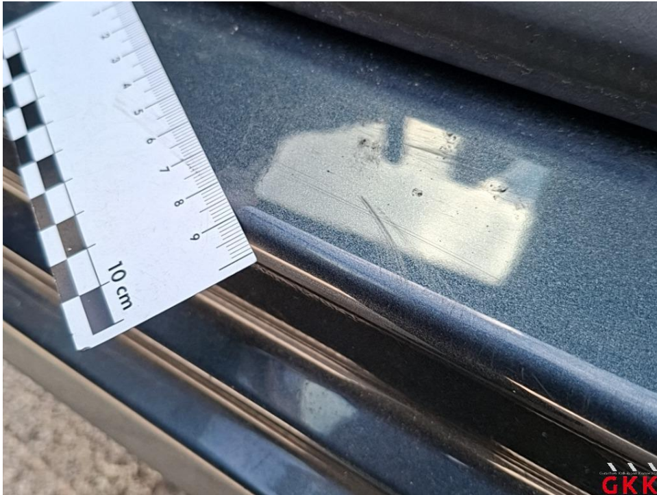
Bild 43. Tür vorne links, Einstieg, verkratzt, lackieren
