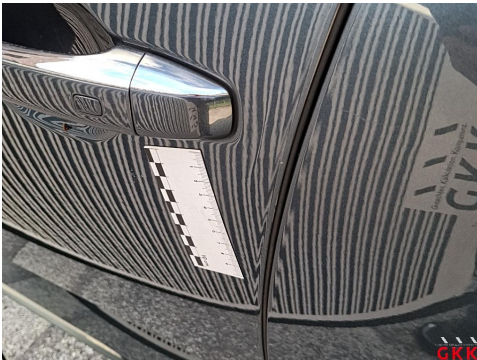
Bild 28. Tür vorne links, beschädigt, instand setzen - lackieren
