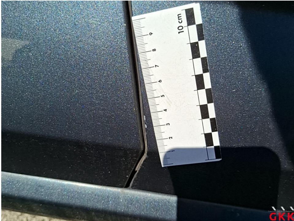
Bild 33. Tür vorne rechts, Kante, verkratzt, auslegen, schleifen, polieren
