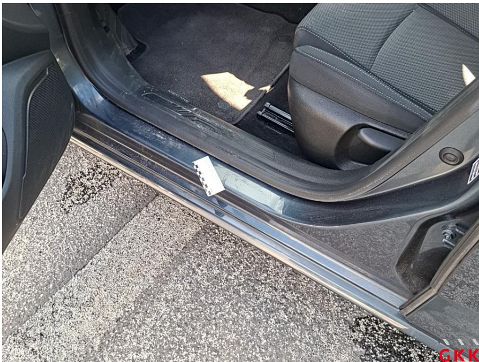
Bild 42. Tür vorne links, Einstieg, verkratzt, lackieren
