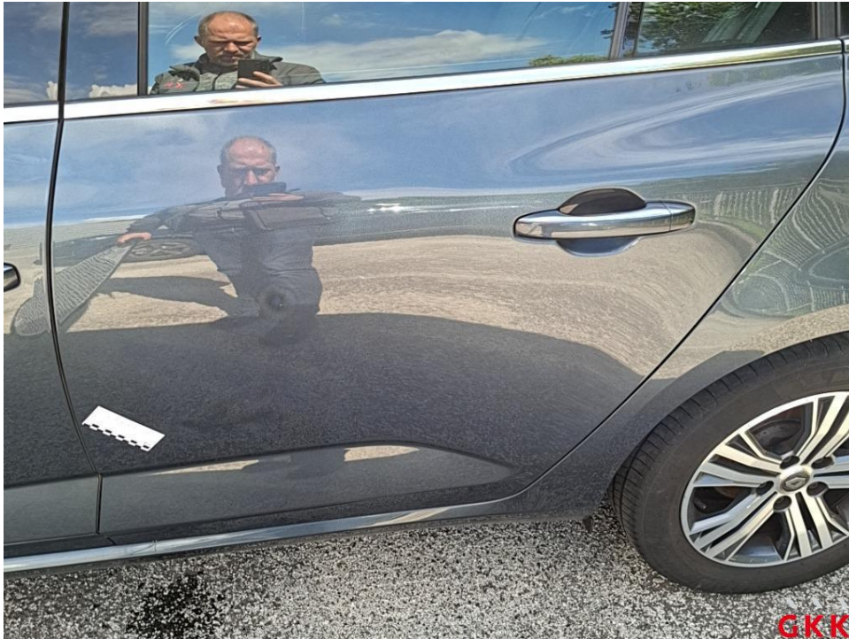
Bild 25. Tür hinten links, verkratzt, auslegen, schleifen, polieren
