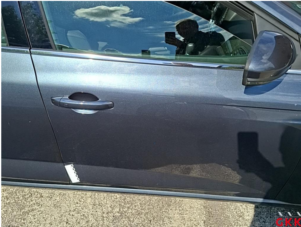
Bild 32. Tür vorne rechts, Kante, verkratzt, auslegen, schleifen, polieren
