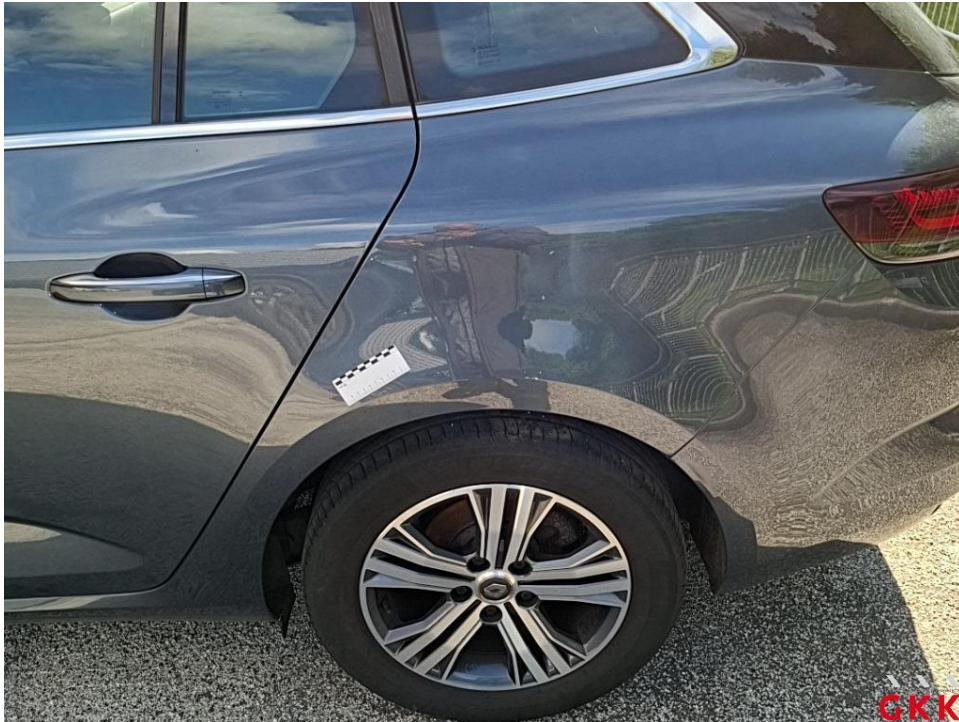
Bild 23. Seitenwand links, verkratzt, auslegen, schleifen, polieren
