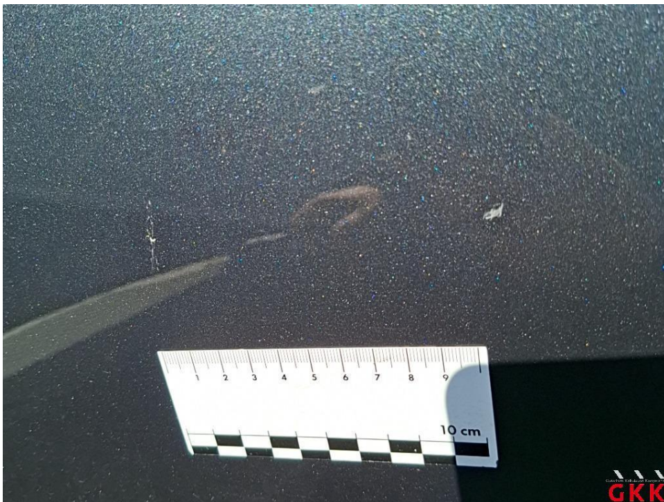
Bild 36. Tür hinten rechts, verkratzt, lackieren
