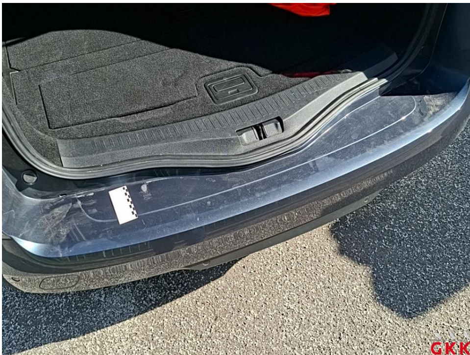
Bild 14. Stoßfänger hinten, Verkleidung -lackiert-, verkratzt, lackieren
