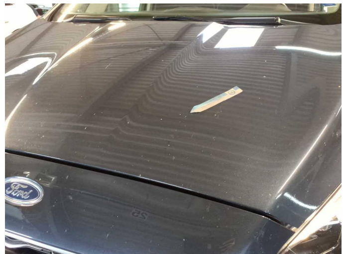
Damage 16: Bonnet: Bonnet (Sandstrahleffekt) - Stone chips - Paint
