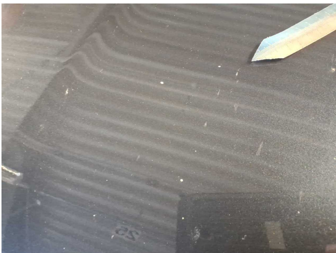
Damage 16: Bonnet: Bonnet (Sandstrahleffekt) - Stone chips - Paint
