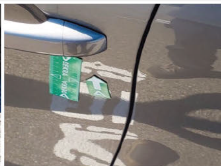
Porte / Avant Gauche / Enfoncement
