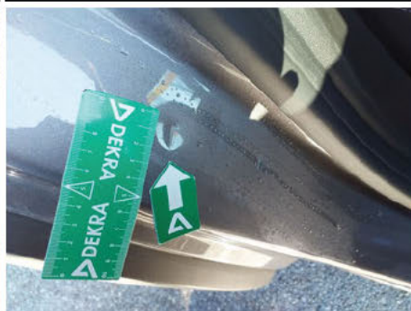
Entrée de porte / Arrière Droit / Enfoncement
