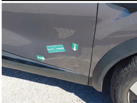
Porte / Avant Droit / Enfoncement
