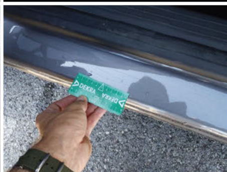
Entrée de porte / Avant Gauche / Rayure
