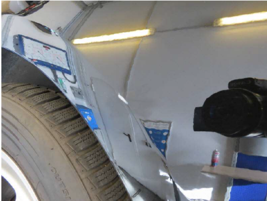
Bild 29 Kotflügel vorn links Eindellung, im Lack beschädigt
