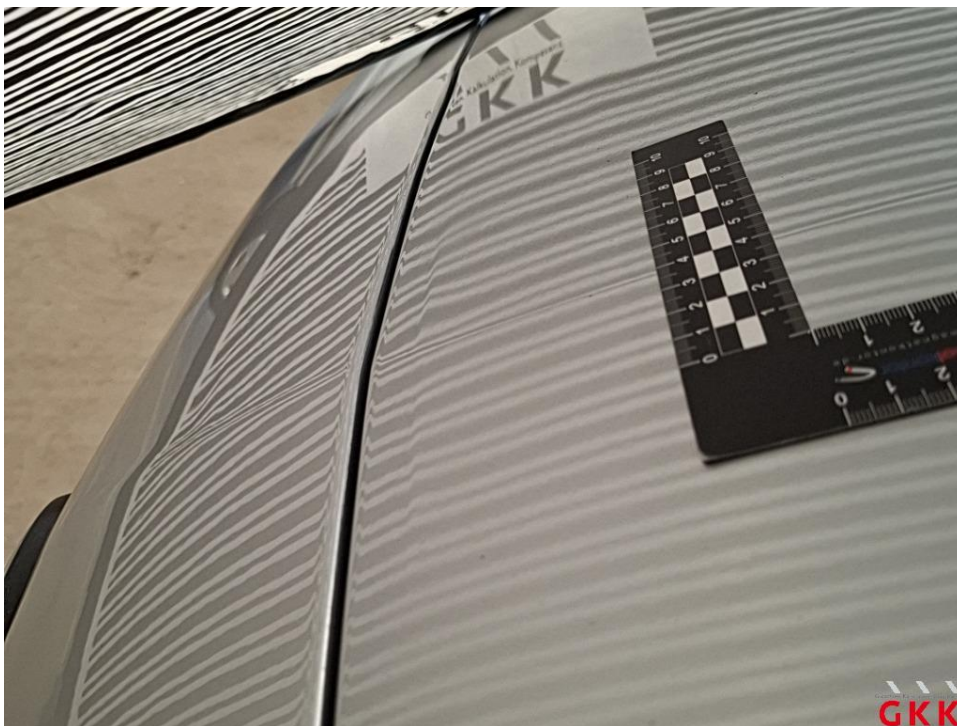
Bild 16 Motorhaube, beschädigt, instand setzen - lackieren
