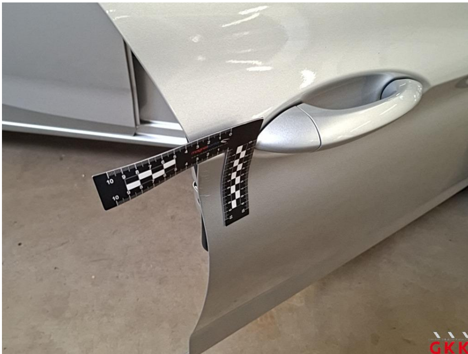
Bild 18 Tür vorne rechts, verkratzt, lackieren
