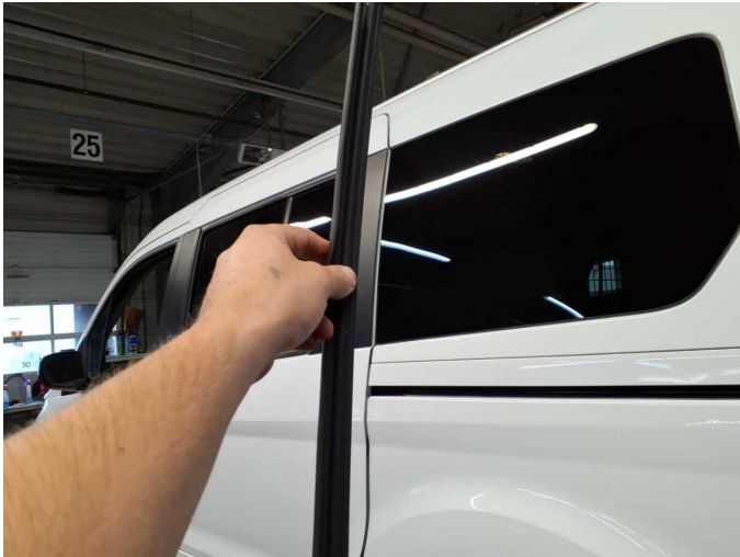
Damage 2: Sliding door - left side: Sliding door with glass panel (Dichtung ab) - Loose - Replace
