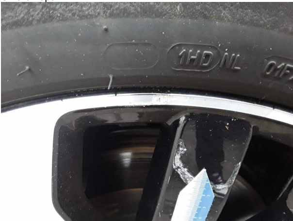
Beschädigung #2: Rad/Reifen: Leichtmetallfelge hinten rechts - Kratzer - erneuern
