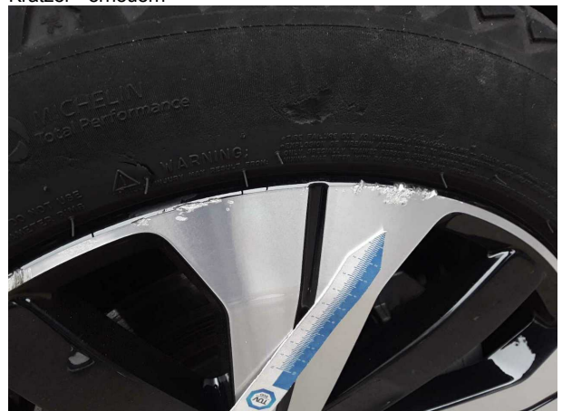
Beschädigung #3: Rad/Reifen: Leichtmetallfelge vorn rechts - Kratzer - erneuern
