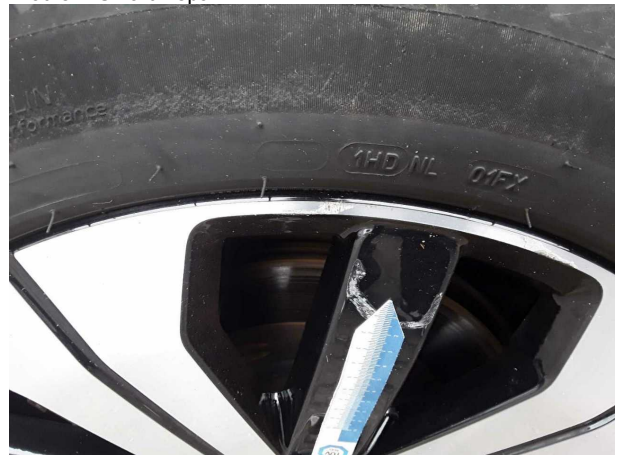
Beschädigung #2: Rad/Reifen: Leichtmetallfelge hinten rechts - Kratzer - erneuern
