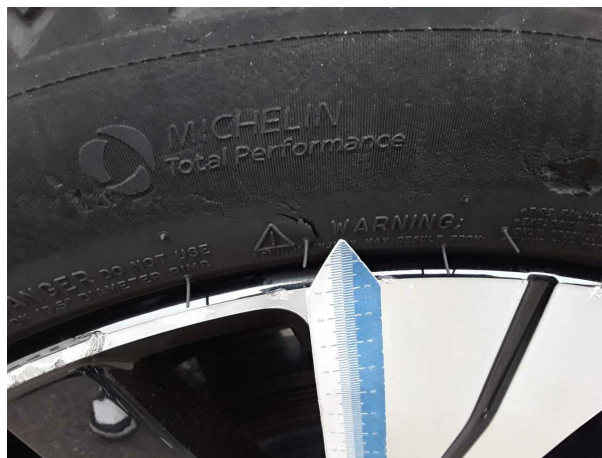
Beschädigung #4: Rad/Reifen: Reifen vorn (beschädigt) - verschlissen - erneuern
