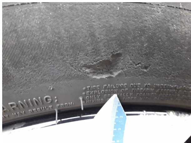
Beschädigung #4: Rad/Reifen: Reifen vorn (beschädigt) - verschliss... - erneuern
