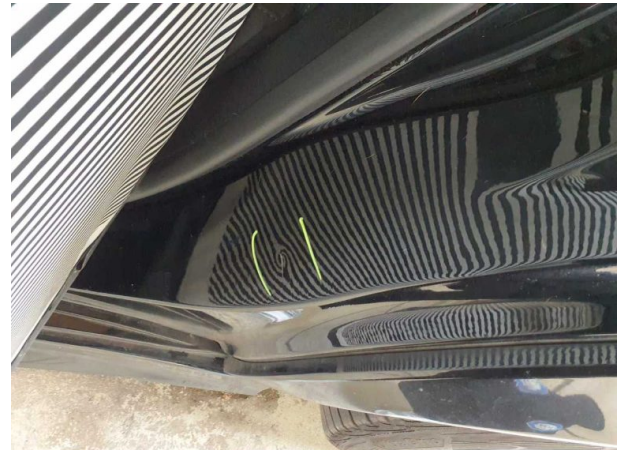
Beschädigung #6: Seitenwand links: Einstieg - Delle / Lackschaden - instandsetzen und lackieren
