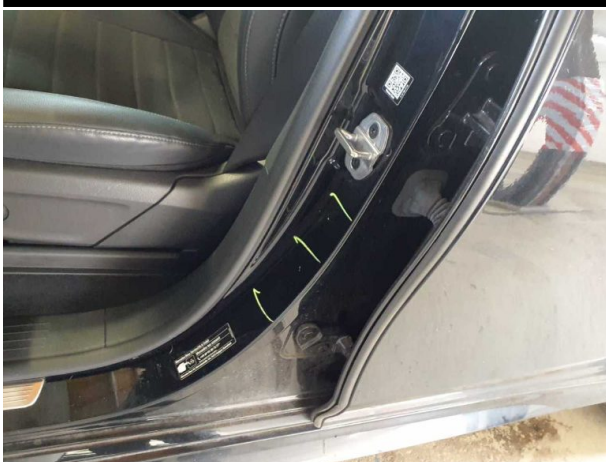
Beschädigung #5: Seitenwand links: Einstieg - Delle(n) - instandsetzen und lackieren
