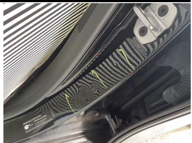
Beschädigung #5: Seitenwand links: Einstieg - Delle(n) - instandsetzen und lackieren
