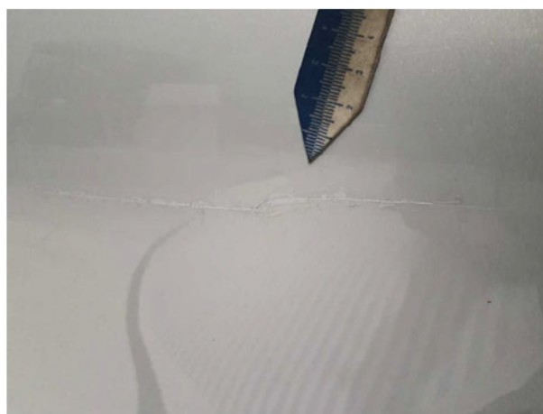
Beschädigung #6: Tür hinten links: Tür - verkratzt / verschürft - lackieren
