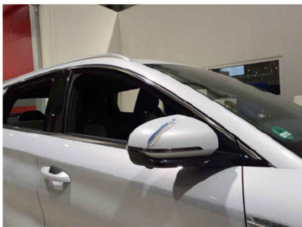
Beschädigung #5: Blinkleuchte: Spiegel rechts - Abrieb - erneuern
