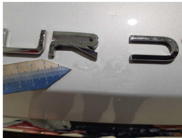
Beschädigung #7: Heckklappe/-tür: Heckklappe - verkratzt / verschürft - lackieren
