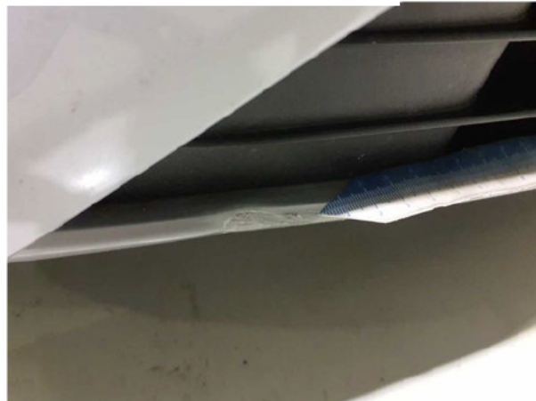
Beschädigung #4: Stossfänger vorn: Spoiler - verformt - erneuern
