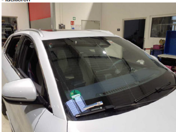
Beschädigung #8: Verglasung: Frontscheibe - gebrochen / gerissen - erneuern
