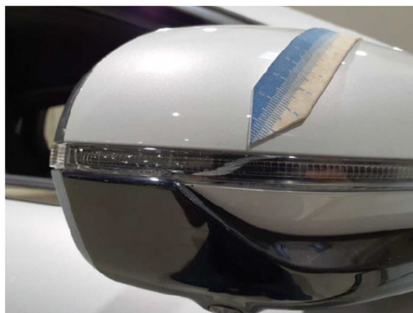
Beschädigung #5: Blinkleuchte: Spiegel rechts - Abrieb - erneuern
