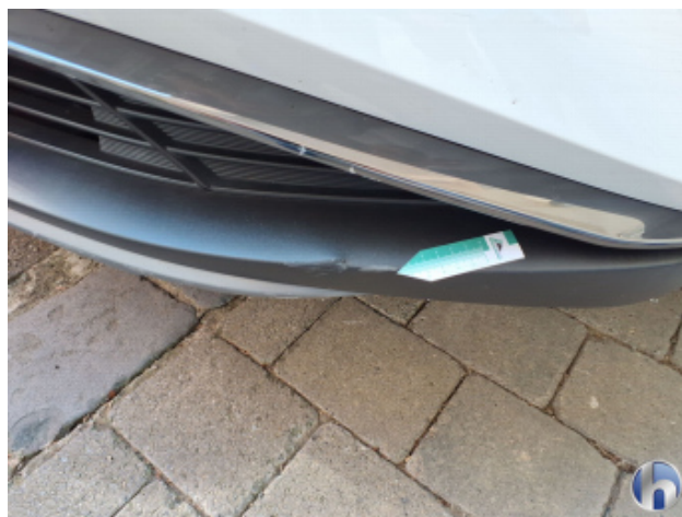
2. Stoßfänger Vorne Verdellt - Erneuern
