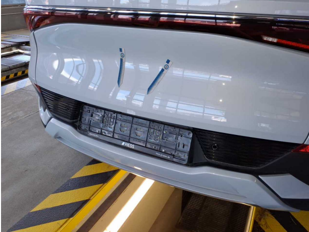
Beschädigung #1: Heckklappe/-tür: Heckklappe - Kratzer - auslegen / polieren
