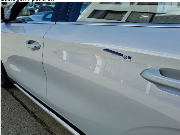
Beschädigung #3: Tür hinten links: Tür - Delle / Lackschaden - sanft instandsetzen
