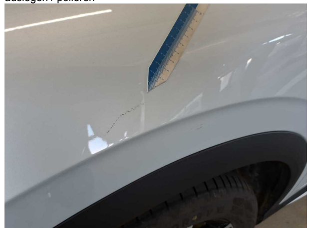
Beschädigung #2: Kotflügel links: Kotflügel links - Lackmangel - auslegen / polieren
