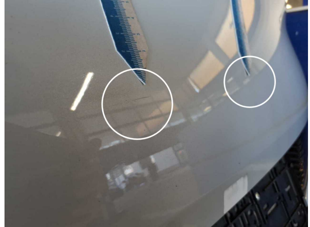
Beschädigung #1: Heckklappe/-tür: Heckklappe - Kratzer - auslegen / polieren
