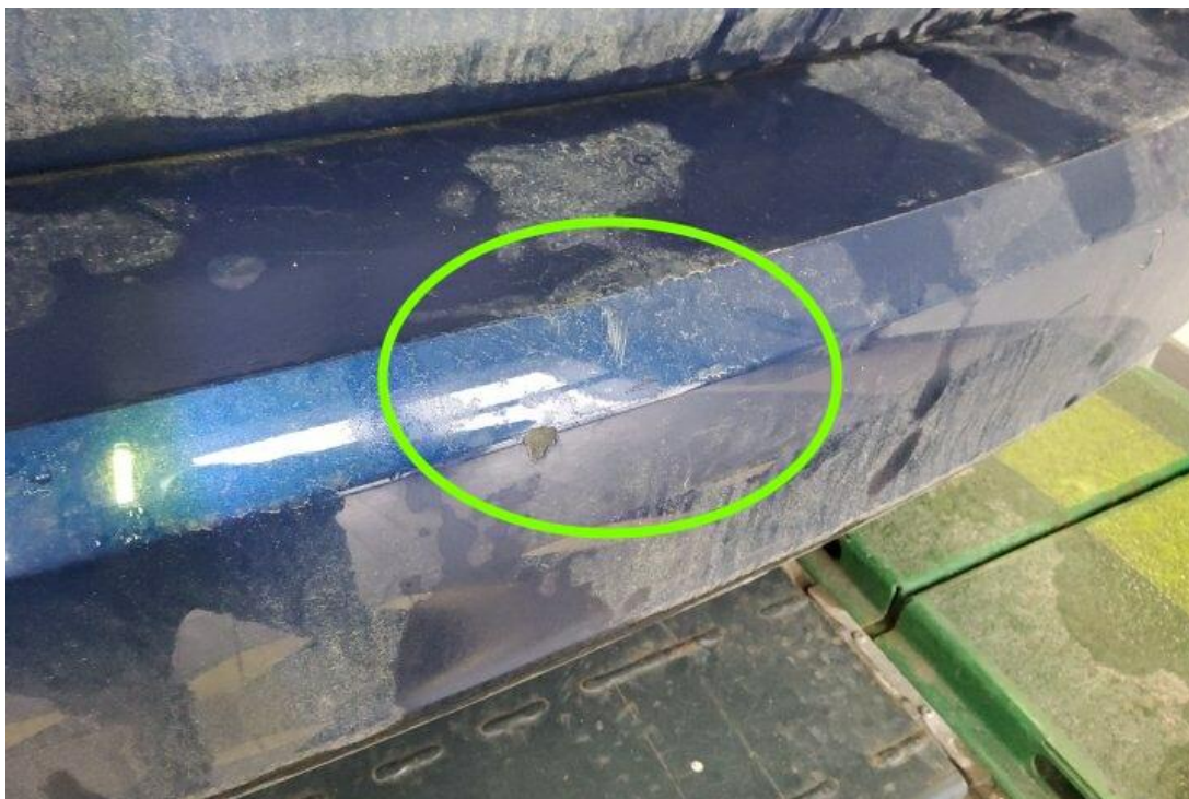
Bild 19 : Stoßfänger hinten Lackierung, verschrammt, lackieren mit Lackaufbau
