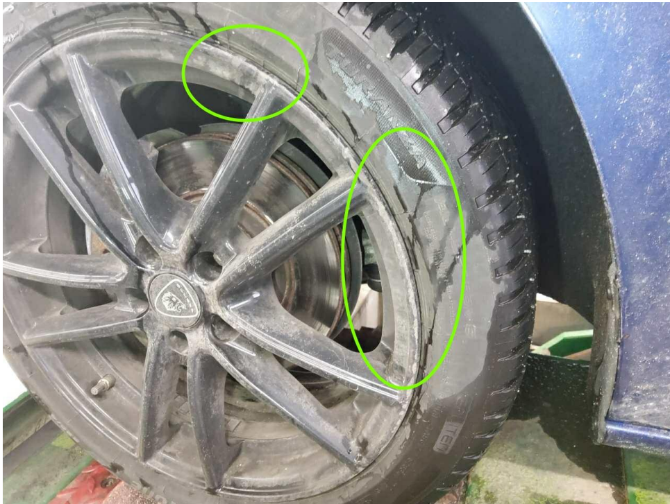
Bild 22 : Felge vorne links, zerkratzt, smart repair
