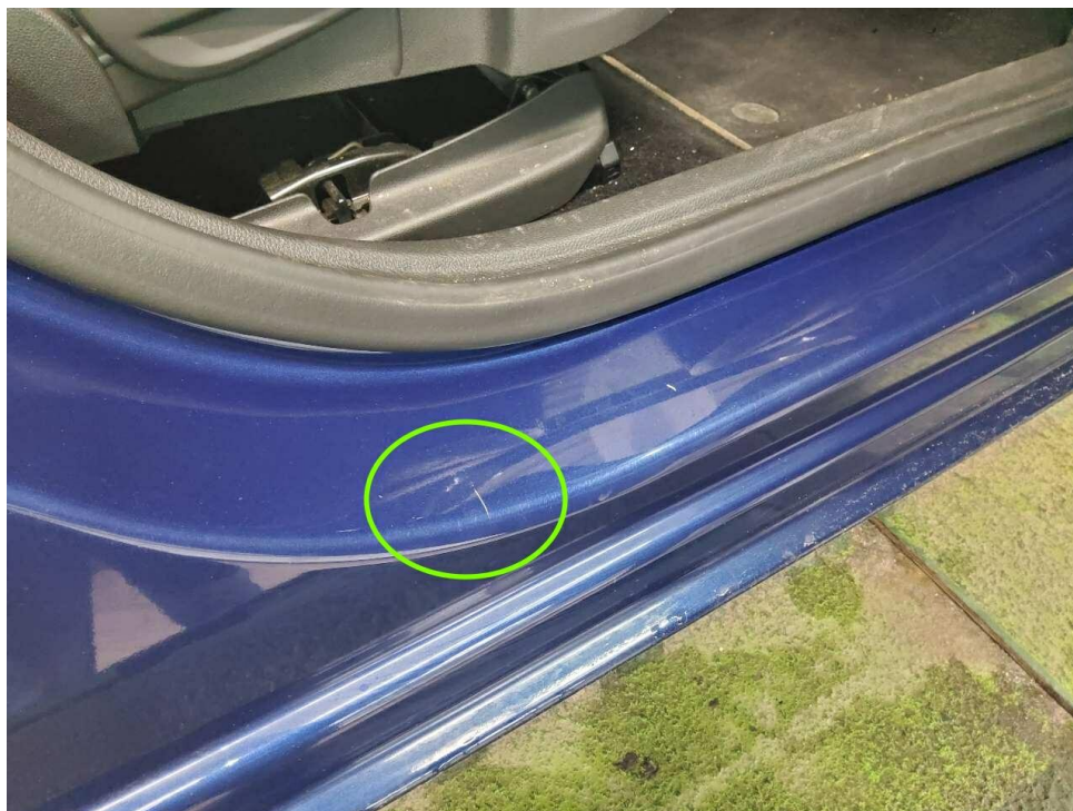
Bild 13 : Tür vorne rechts Einstieg, verschrammt, smart repair
