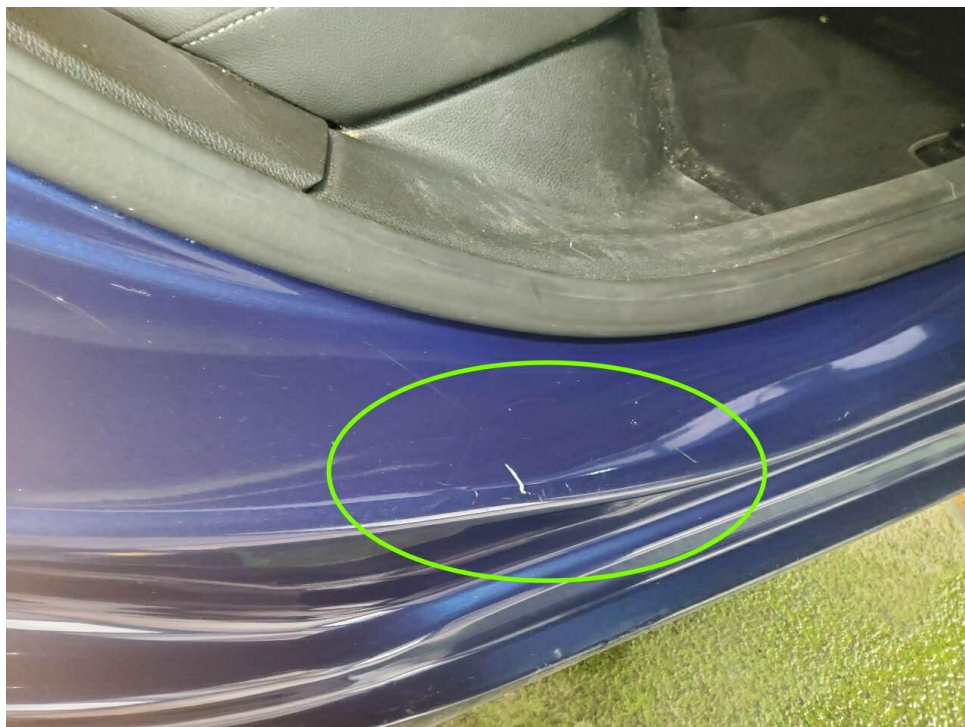
Bild 14 : Tür hinten rechts Einstieg, verschrammt, smart repair
