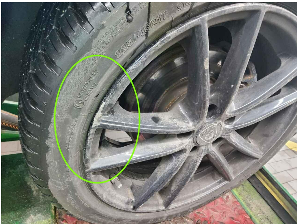
Bild 23 : Felge vorne rechts Lackierung, zerkratzt, smart repair
