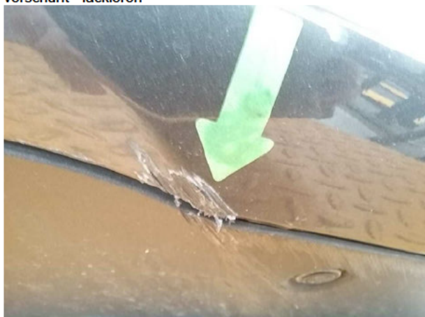
Beschädigung #3: Stossfänger vorn: Stossfänger vorn - verkratzt / verschürft - lackieren
