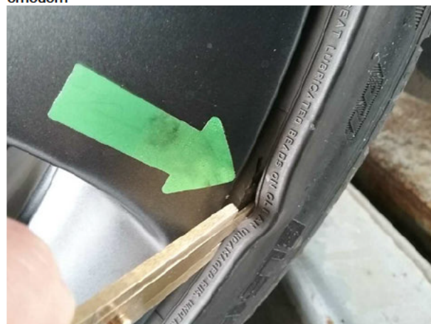
Beschädigung #2: Rad/Reifen: Reifen vorn links - beschädigt - erneuern
