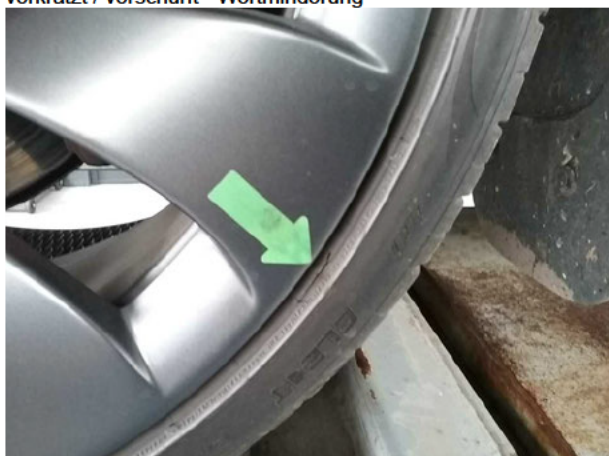
Beschädigung #2: Rad/Reifen: Reifen vorn links - beschädigt - erneuern
