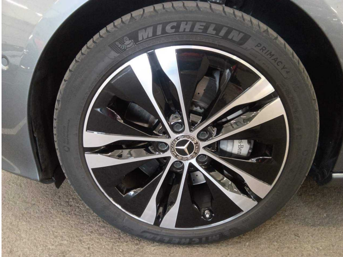
Damage 6: Wheel / tyres: Alloy rim - front left side (Mit Materialabtrag) - Scratch(es) - Replace
