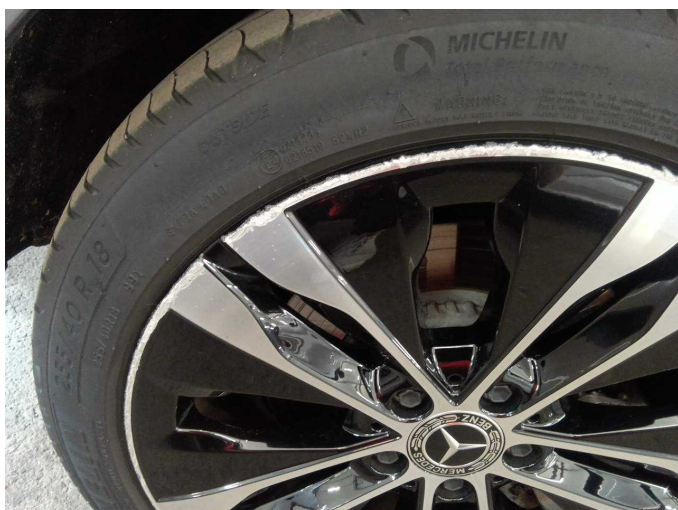
Damage 8: Wheel / tyres: Alloy rim - rear right side (Großflächig verkratzt) - Scratched - Replace
