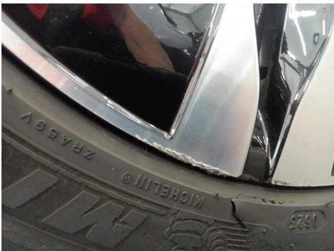
Damage 7: Wheel / tyres: Alloy rim - front right side (Mit Materialabtrag) - Scratch(es) - Replace
