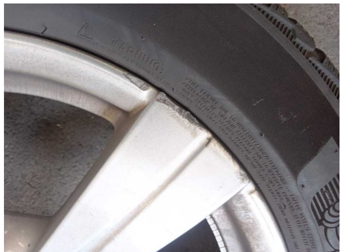
Damage 5: 2nd wheel set: 1 alloy rim (Mit Materialabtrag) - Scratched - Replace
