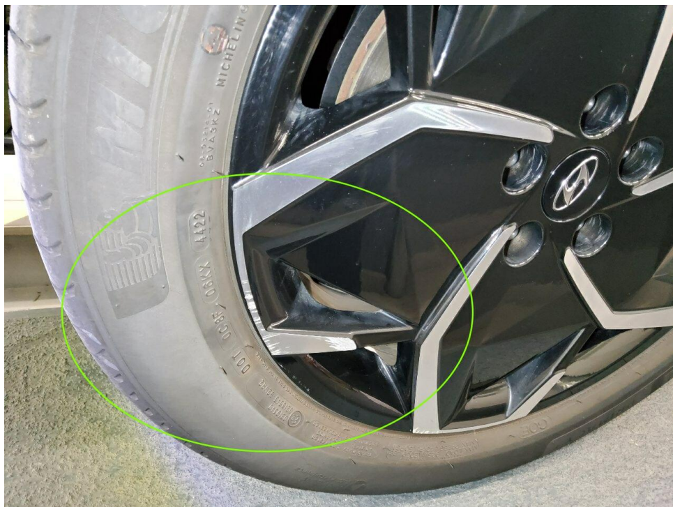
Bild 18 : Leichtmetallfelge glanzgedreht hinten rechts verschrammt
