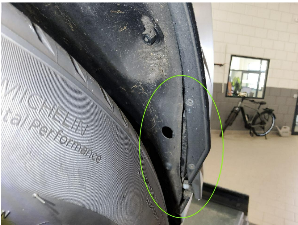
Bild 12 : Unfallschaden hinten links, Radhausschale, Stoßfänger hinten und Radlaufblende beschädigt
