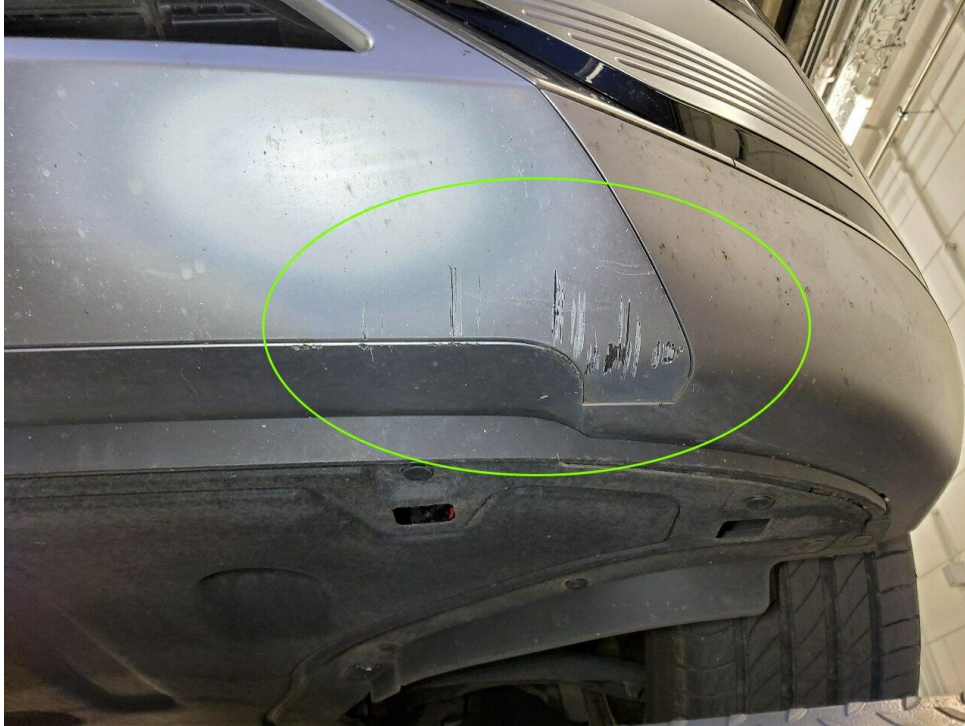
Bild 21 : Stoßfänger vorne unterhalb mehrfach verschrammt
