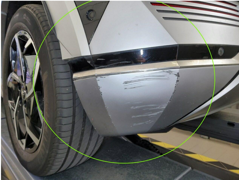
Bild 9 : Unfallschaden hinten links, Radhausschale, Stoßfänger hinten und Radlaufblende beschädigt
