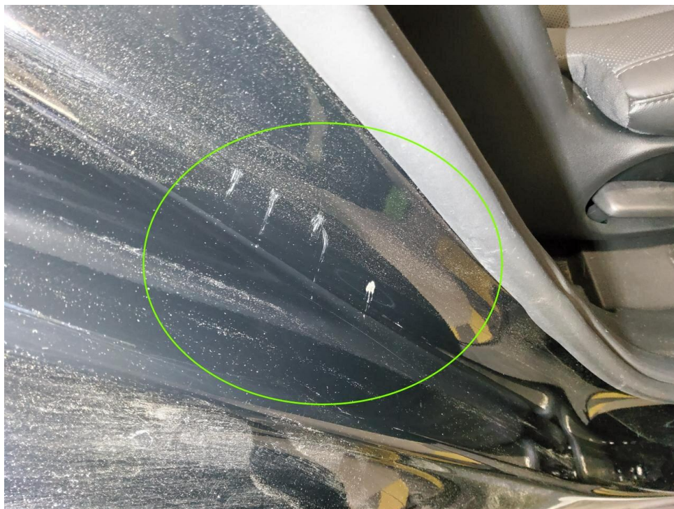
Bild 7 : Türeinstieg hinten rechts verschrammt
