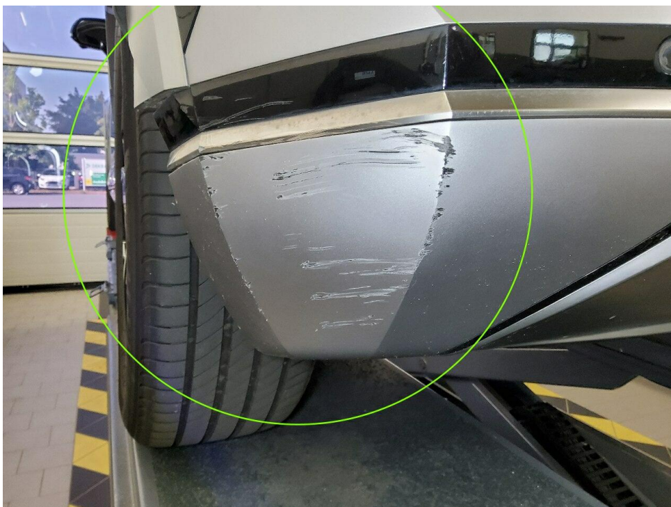
Bild 10 : Unfallschaden hinten links, Radhausschale, Stoßfänger hinten und Radlaufblende beschädigt
