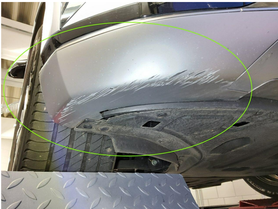
Bild 20 : Stoßfänger vorne unterhalb mehrfach verschrammt
