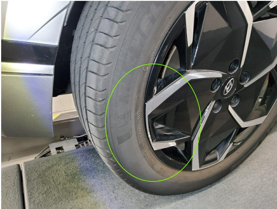
Bild 19 : Leichtmetallfelge glanzgedreht hinten rechts verschrammt
