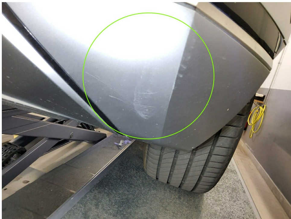
Bild 17 : Unfallschaden hinten rechts, Stoßfänger hinten deformiert
