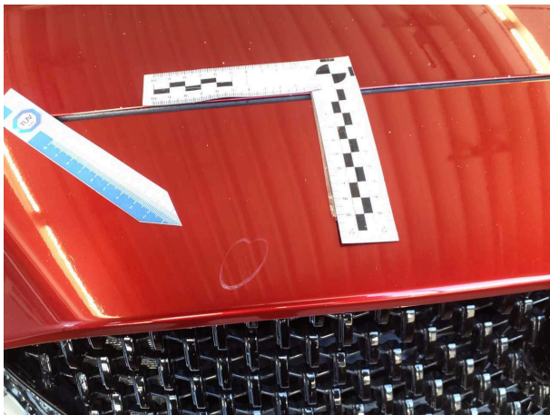
Beschädigung #10: Stossfänger vorn: Stossfänger vorn - Steinschla... lackieren
