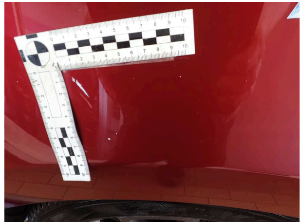
Beschädigung #6: Seitenwand rechts: Seitenwand - Steinschlag - lackieren
