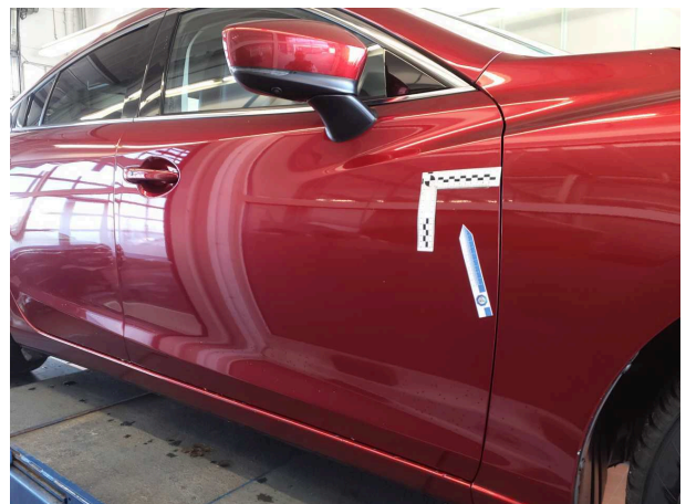
Beschädigung #9: Tür vorn rechts: Tür - Steinschlag - lackieren
