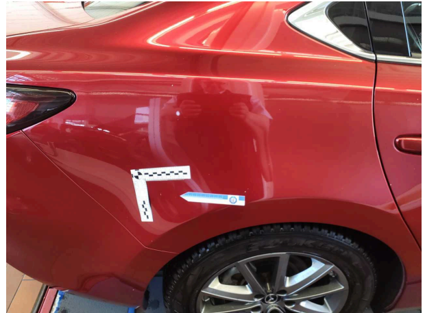
Beschädigung #6: Seitenwand rechts: Seitenwand - Steinschlag - lackieren
