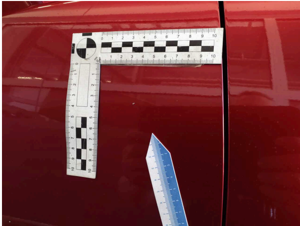
Beschädigung #9: Tür vorn rechts: Tür - Steinschlag - lackieren
