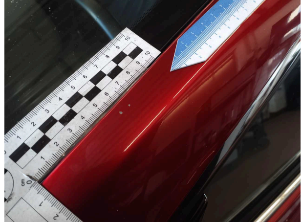
Beschädigung #1: Karosserie: A-Säule links - Steinschlag - Smart Repair
