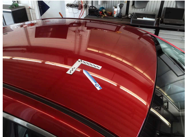
Beschädigung #11: Fahrzeugdach: Dach (Korrosion) - Steinschlag - lackieren
