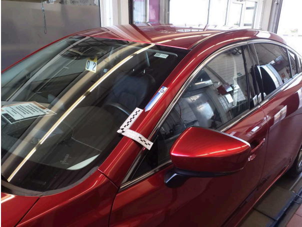
Beschädigung #1: Karosserie: A-Säule links - Steinschlag - Smart Repair
