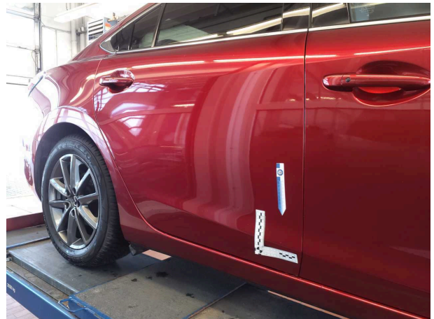
Beschädigung #8: Tür hinten rechts: Tür - Steinschlag - lackieren
