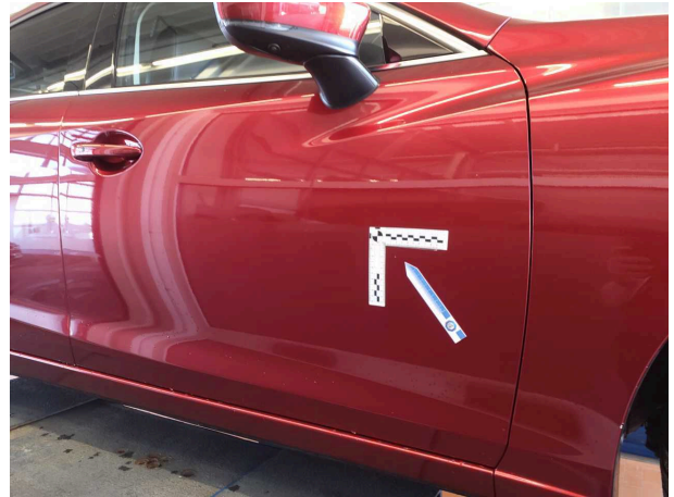
Beschädigung #9: Tür vorn rechts: Tür - Steinschlag - lackieren
