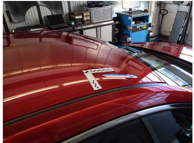
Beschädigung #11: Fahrzeugdach: Dach (Korrosion) - Steinschl... - lackieren
