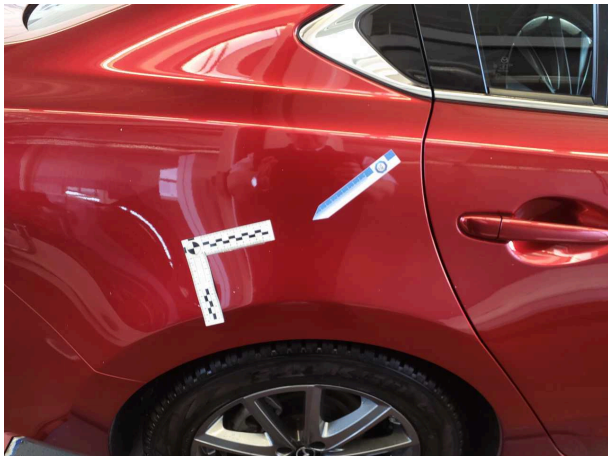
Beschädigung #6: Seitenwand rechts: Seitenwand - Steinschlag - lackieren
