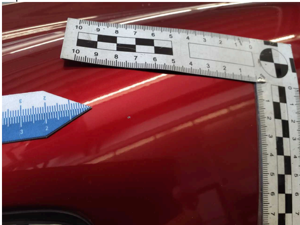
Beschädigung #4: Kotflügel links: Kotflügel links - Steinschlag - Smart Repair
