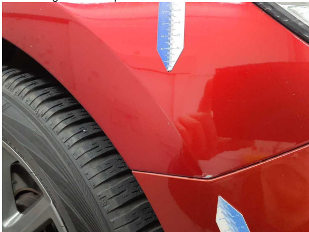
Beschädigung #3: Kotflügel rechts: Kotflügel rechts (Kratzer) - Steinschlag - Smart Repair
