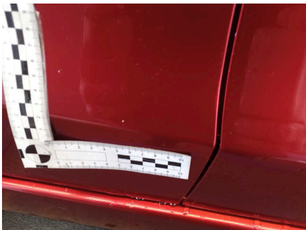
Beschädigung #8: Tür hinten rechts: Tür - Steinschlag - lackieren
