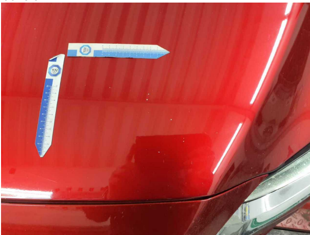
Beschädigung #12: Motorhaube: Motorhaube - Steinschlag - lackieren
