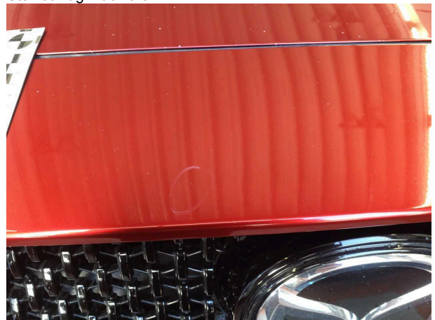
Beschädigung #10: Stossfänger vorn: Stossfänger vorn - Steinschlag - lackieren
