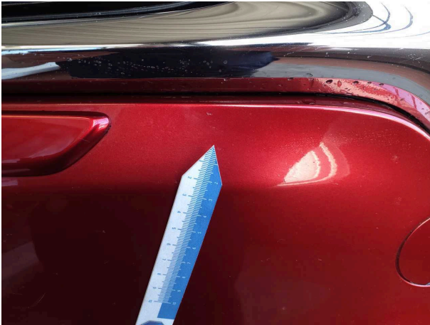
Beschädigung #10: Stossfänger vorn: Stossfänger vorn - Steinschla... lackieren
