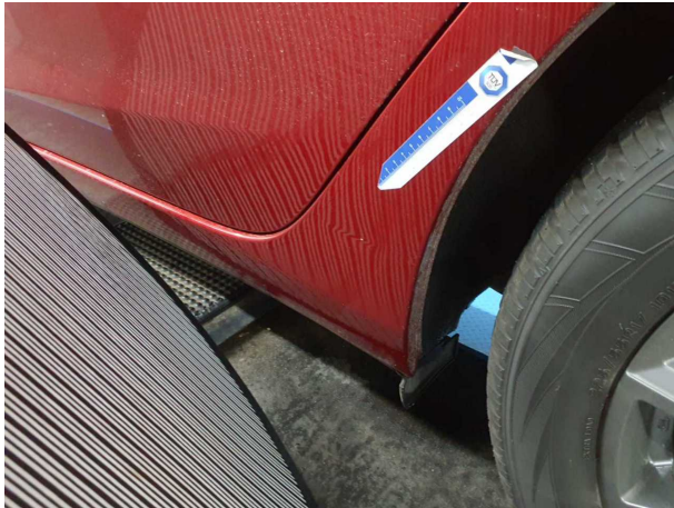
Beschädigung #7: Seitenwand links: Kniestück - Delle / Lackschade... instandsetzen und lackieren
