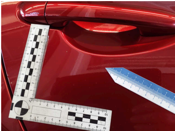
Beschädigung #8: Tür hinten rechts: Tür - Steinschlag - lackieren
