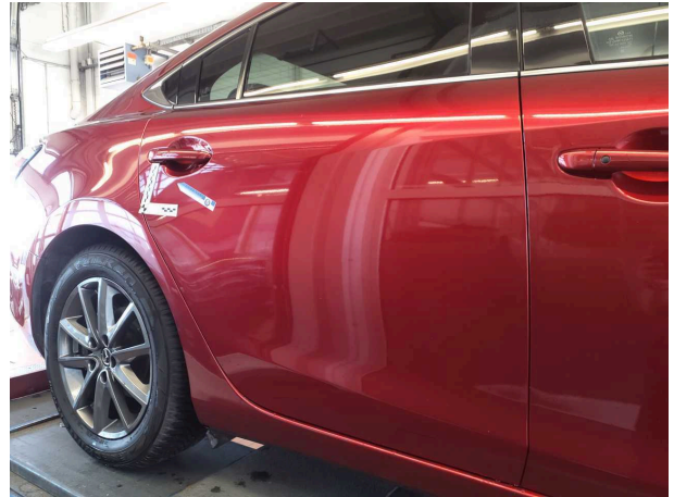
Beschädigung #8: Tür hinten rechts: Tür - Steinschlag - lackieren
