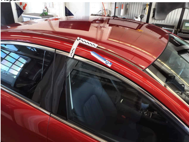
Beschädigung #2: Karosserie: A-Säule rechts - Steinschlag - Smart Repair
