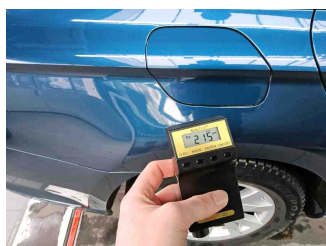
Lackstärke Seitenwand hinten rechts
