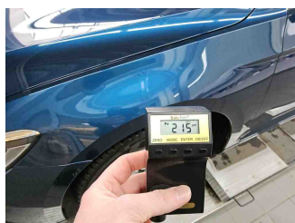
Lackstärke Kotflügel vorne links
