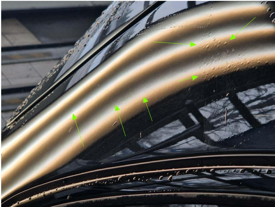
Bild 15 : Seitenwand hinten rechts Schleifspuren und Blasenbildung im Lack
