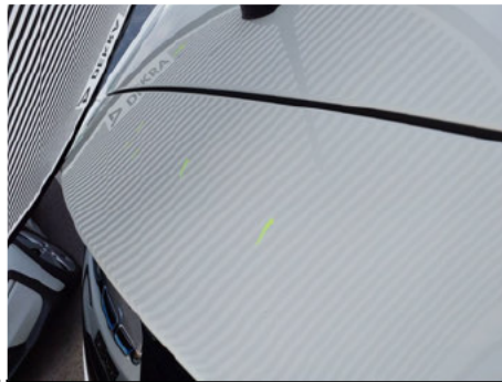
Heckklappe / Kofferraumtür / - / Hagelschaden
