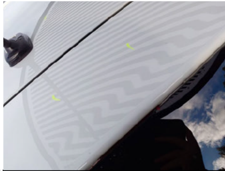
Heckklappe / Kofferraumtür / - / Hagelschaden
