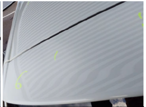
Heckklappe / Kofferraumtür / - / Hagelschaden
