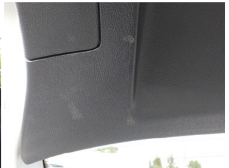
Heck-/Gepäckraumklappenverkleidung / Hinten / Kratzer
