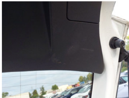
Heck-/Gepäckraumklappenverkleidung / Hinten / Kratzer
