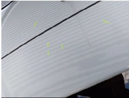
Heckklappe / Kofferraumtür / - / Hagelschaden
