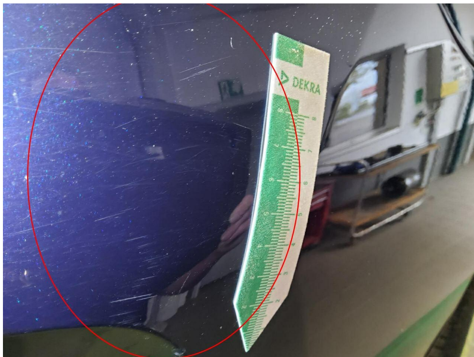
Bild 28 : Stoßfänger hinten, verformt, instandsetzen und lackieren mit Lackaufbau
