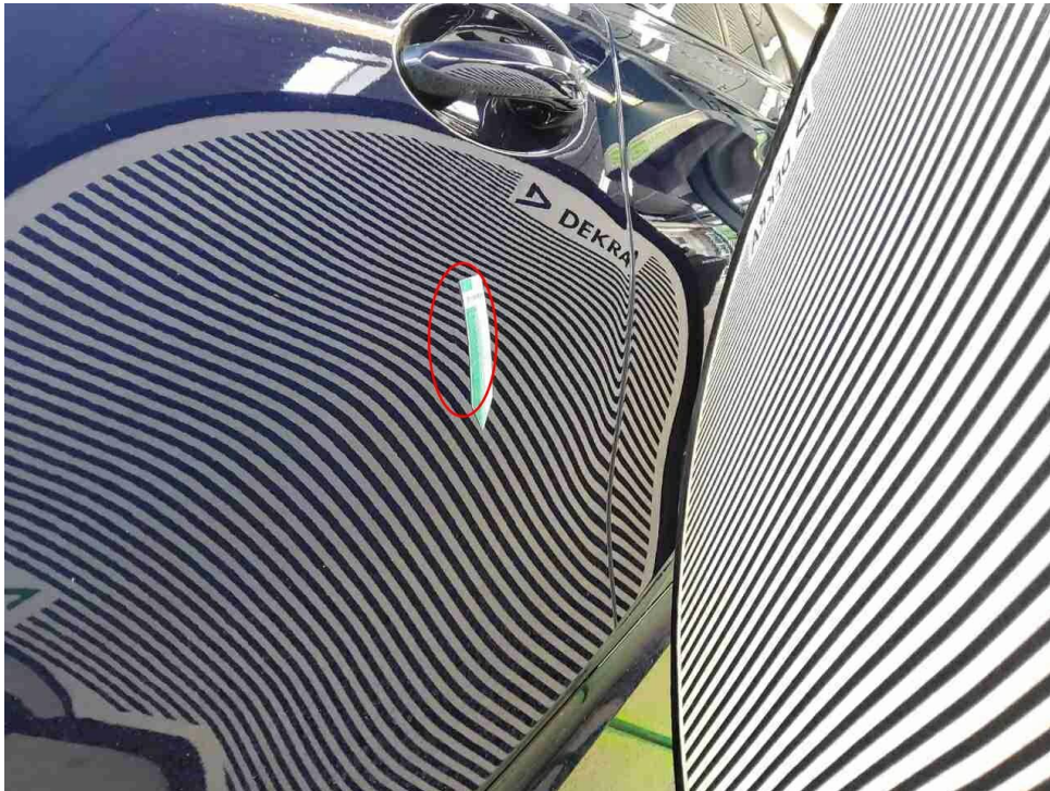
Bild 23 : Tür vorne links, mehrfach eingedellt, drücken
