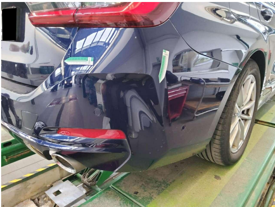
Bild 26 : Stoßfänger hinten, verformt, instandsetzen und lackieren mit Lackaufbau
