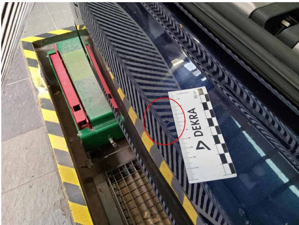
Bild 30 : Stoßfänger hinten, verformt, instandsetzen und lackieren mit Lackaufbau
