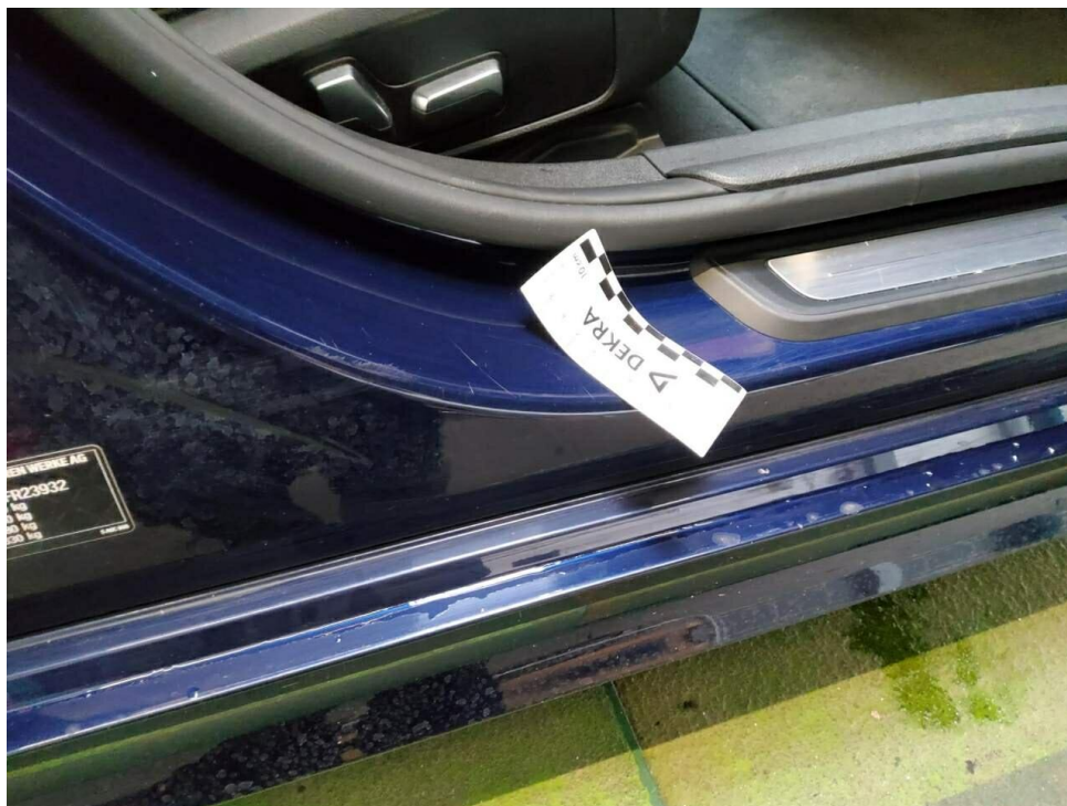
Bild 37 : Tür vorne rechts Einstieg Lackierung, verschrammt, Gebrauchsspur
