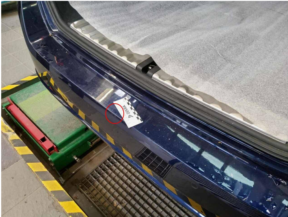
Bild 29 : Stoßfänger hinten, verformt, instandsetzen und lackieren mit Lackaufbau
