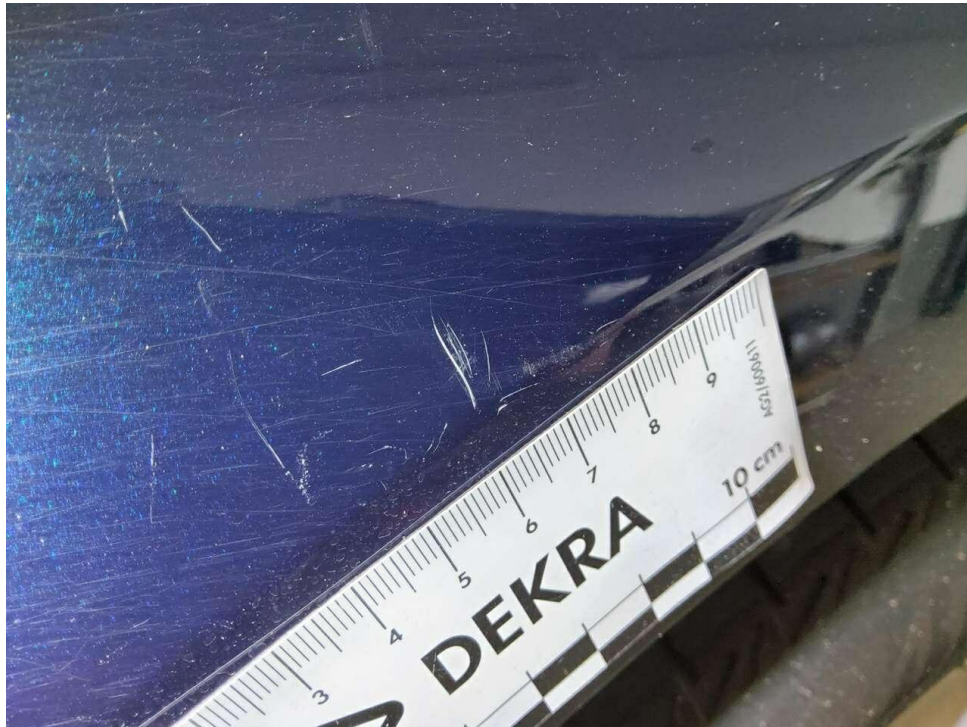
Bild 35 : Seitenteil hinten rechts Lackierung unterhalb, zerkratzt, lackieren
