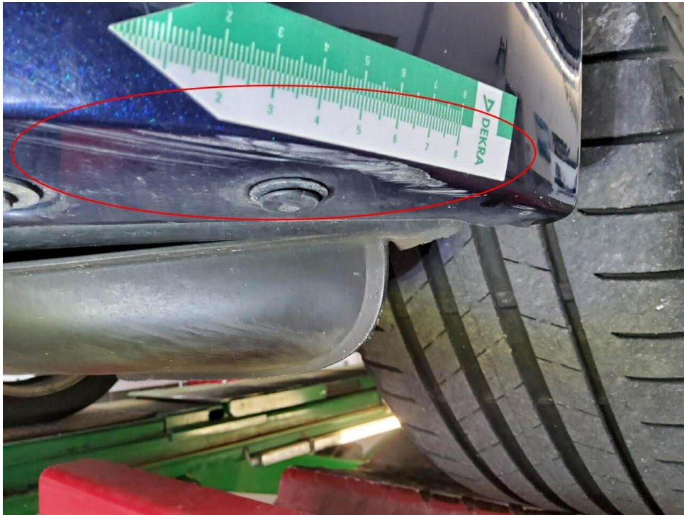
Bild 25 : Stoßfänger vorne Lackierung, zerkratzt, smart repair
