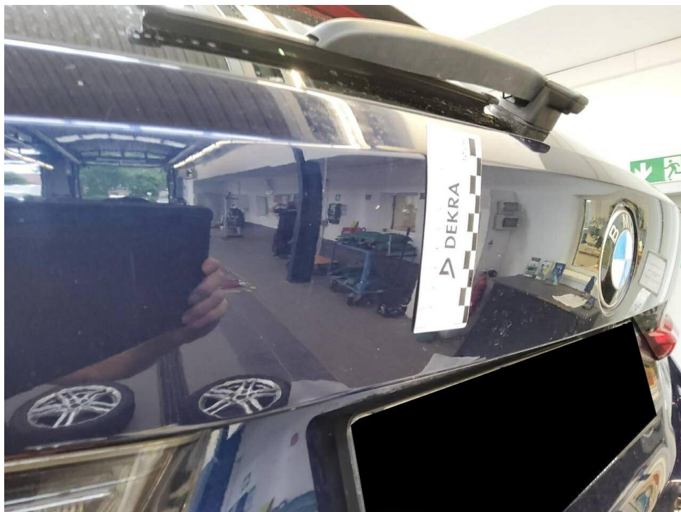
Bild 36 : Heckklappe Lackierung oberhalb, verschrammt, polieren
