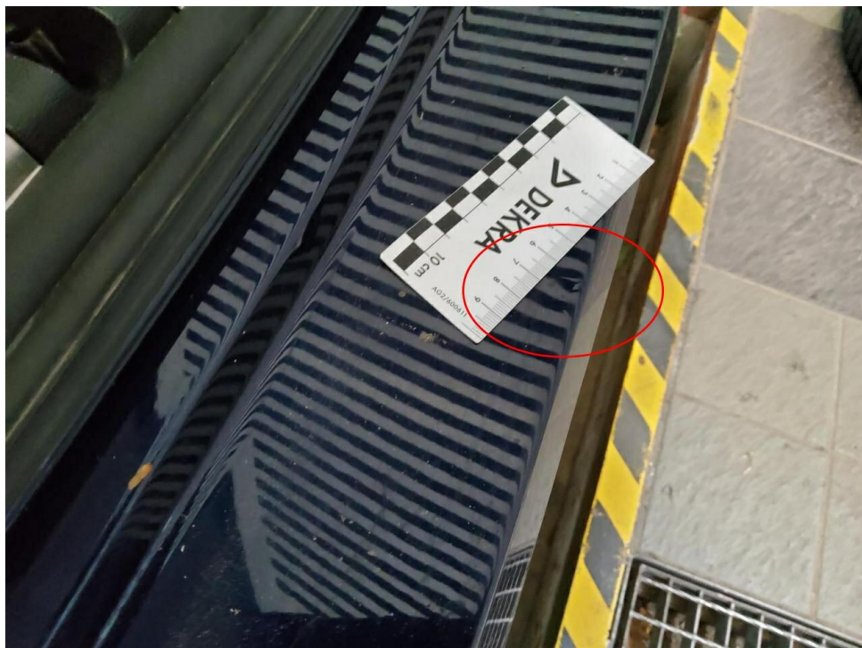
Bild 32 : Stoßfänger hinten, verformt, instandsetzen und lackieren mit Lackaufbau
