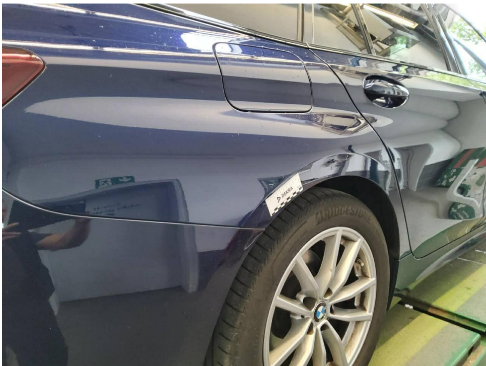
Bild 34 : Seitenteil hinten rechts Lackierung unterhalb, zerkratzt, lackieren
