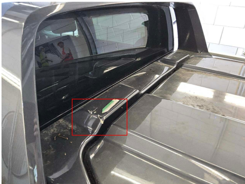
Bild 34 : Verdeck Ladefläche beschädigt
