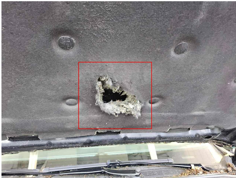
Bild 17 : T- Marderschaden im Motorraum
