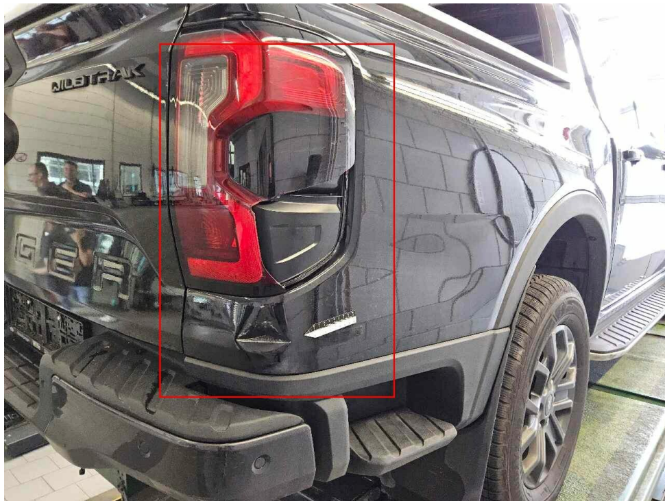
Bild 25 : Anfahrtschaden hinten rechts
