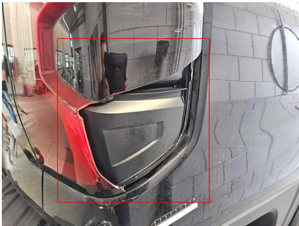
Bild 26 : Anfahrtschaden hinten rechts
