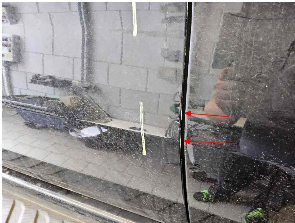
Bild 24 : Tür vorne links eingedellt, verschrammt
