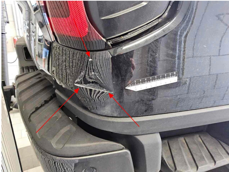
Bild 27 : Anfahrtschaden hinten rechts
