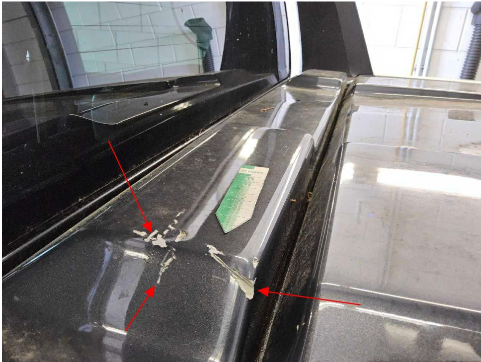
Bild 35 : Verdeck Ladefläche beschädigt
