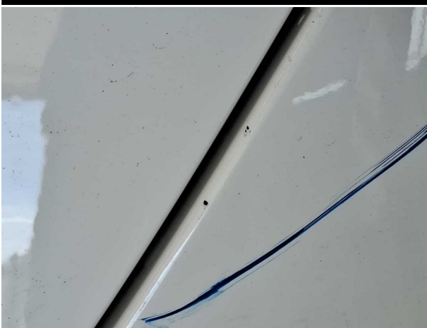
Beschädigung #7: Stossfänger hinten: Stossfänger hinten - verkratzt / verschürft - Smart Repair
