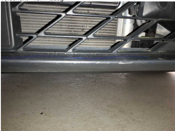
Beschädigung #4: Stossfänger vorn: Spoiler - verkratzt / verschürft - Wertminderung
