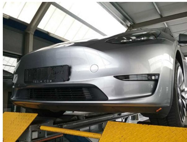
Beschädigung #2: Stossfänger vorn: Spoiler - verkratzt / versch... - erneuern
