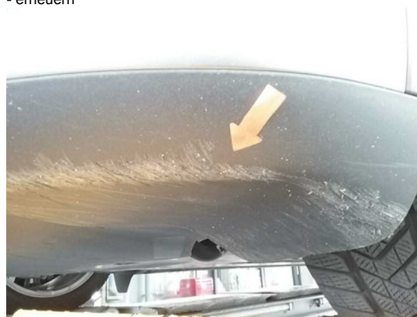
Beschädigung #2: Stossfänger vorn: Spoiler - verkratzt / versch... - erneuern
