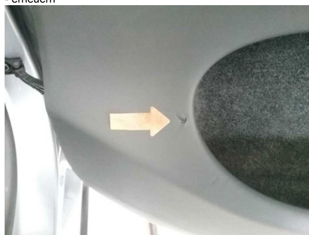
Beschädigung #3: Verkleidungen/Abdeckungen: Türverkleidung hinten rechts - beschädigt - erneuern
