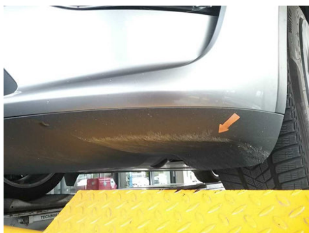
Beschädigung #2: Stossfänger vorn: Spoiler - verkratzt / verschürft - erneuern
