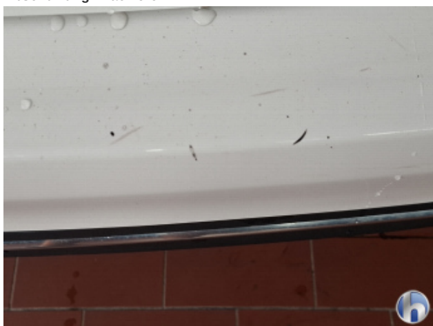
1. Stoßfänger Hinten Abschürfung - Lackieren
