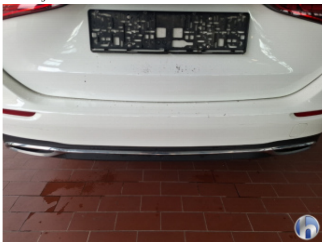
1. Stoßfänger Hinten Abschürfung - Lackieren
