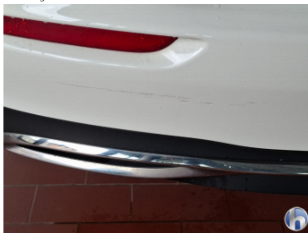
1. Stoßfänger Hinten Abschürfung - Lackieren
