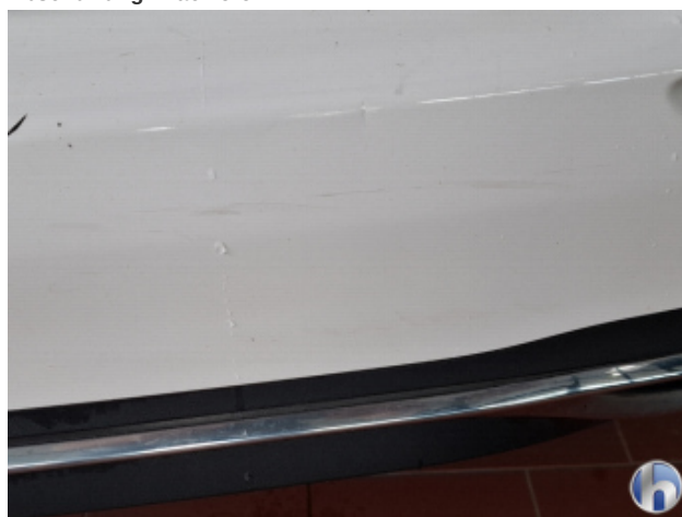
1. Stoßfänger Hinten Abschürfung - Lackieren
