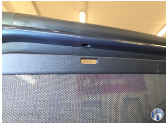
9. Haltehaken Sonnenrollo Fehlt - Erneuern
