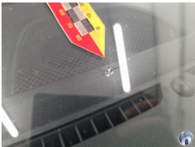
3. Windschutzscheibe Riss - Erneuern
