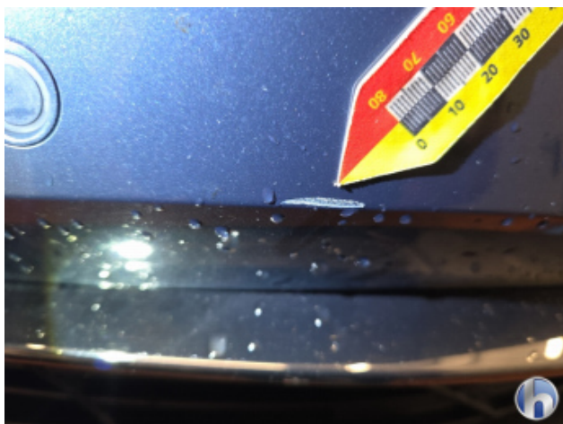
1. Stoßfänger Vorne Kratzer - Smart Repair
