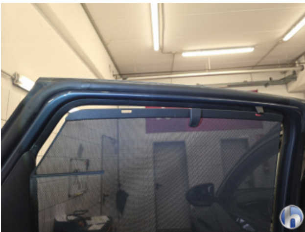
9. Haltehaken Sonnenrollo Fehlt - Erneuern
