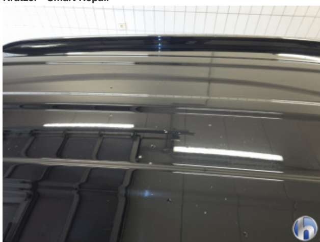
2. Dach Harz-/ Säureeinwirkung -
