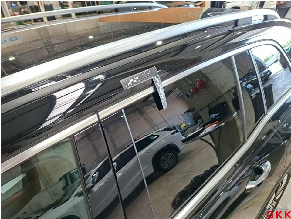
Bild 17. Dach, Holm links, beschädigt, kalt drücken
