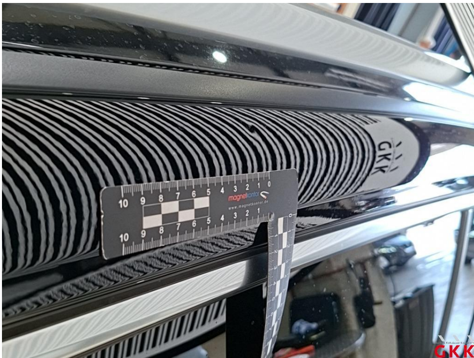
Bild 18. Dach, Holm links, beschädigt, kalt drücken
