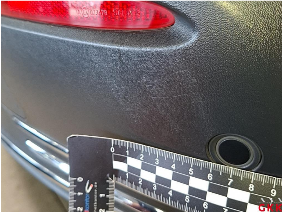
Bild 33. Stoßfänger hinten, Verkleidung unterhalb -unlackiert-, verkratzt, Smartrepair
