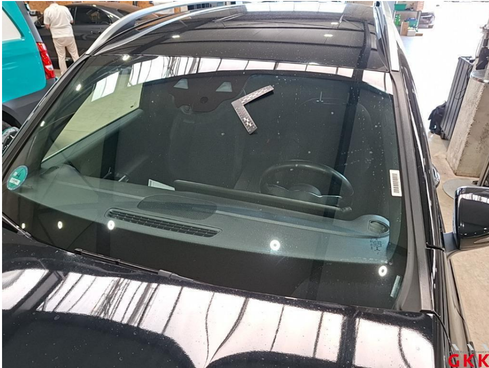
Bild 13. Frontscheibe, mit Regensensor und Frontkamera, gerissen, ersetzen
