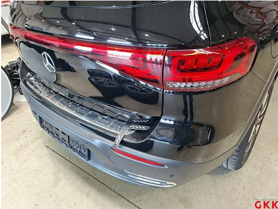
Bild 29. Stoßfänger hinten, Verkleidung oberhalb -lackiert-, verkratzt, lackieren
