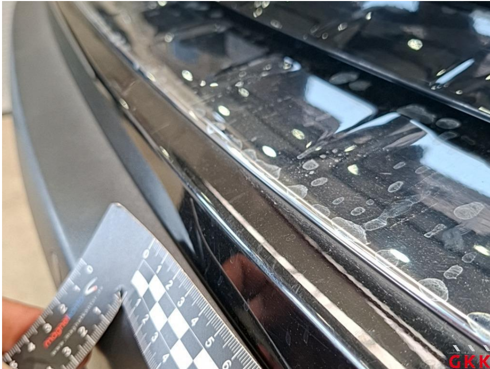
Bild 31. Stoßfänger hinten, Verkleidung oberhalb -lackiert-, verkratzt, lackieren
