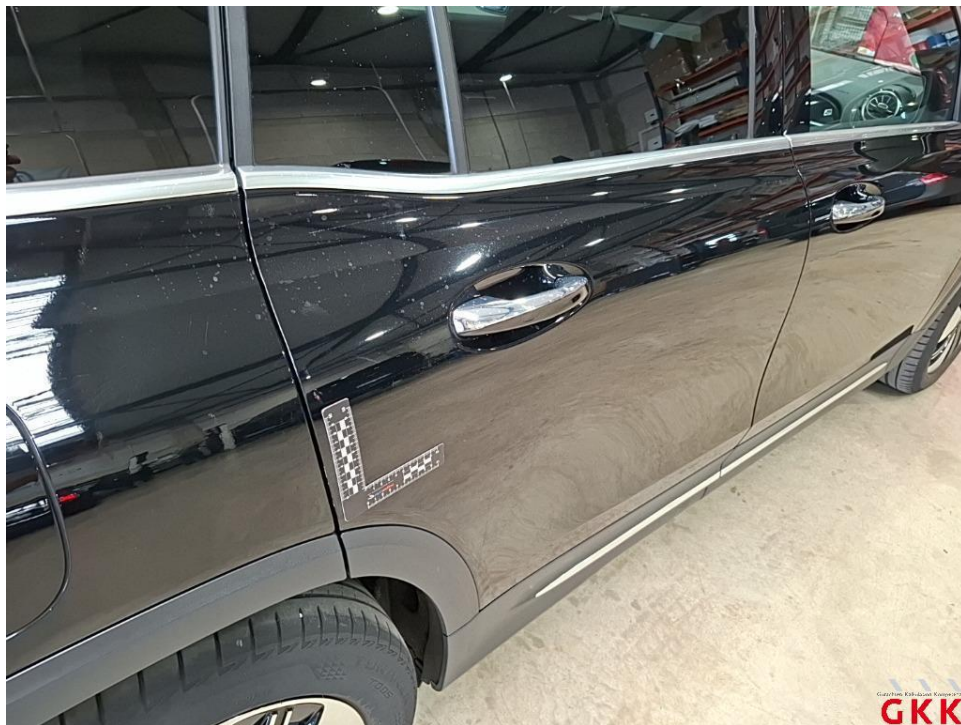
Bild 38. Tür hinten rechts, verkratzt, auslegen, schleifen, polieren
