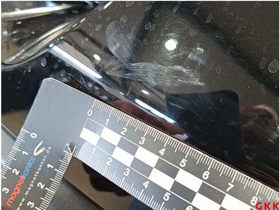
Bild 30. Stoßfänger hinten, Verkleidung oberhalb -lackiert-, verkratzt, lackieren
