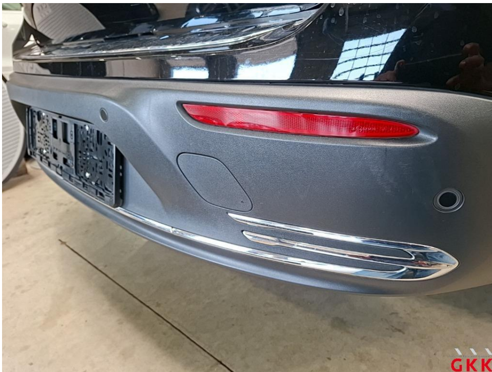
Bild 32. Stoßfänger hinten, Verkleidung unterhalb -unlackiert-, verkratzt, Smartrepair
