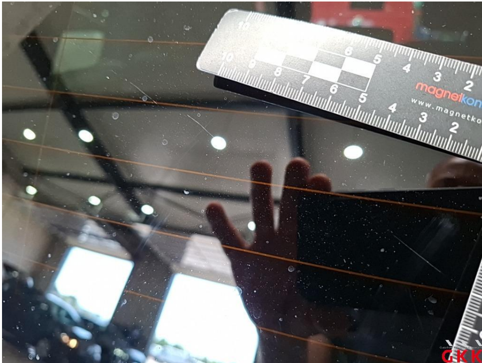
Bild 24. Heckscheibe, getönt, verkratzt, ersetzen
