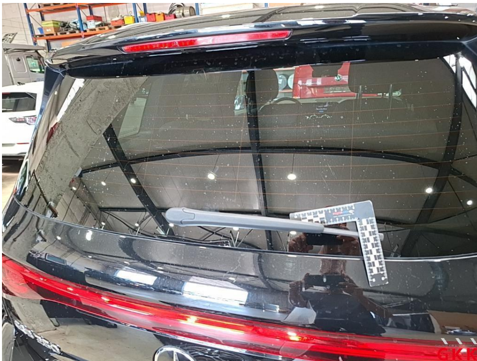
Bild 22. Heckscheibe, getönt, verkratzt, ersetzen
