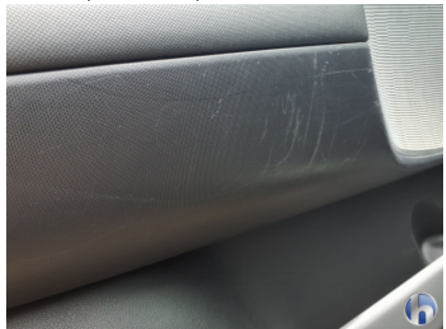
5. Verkleidung Verschmutzt - Reinigen
