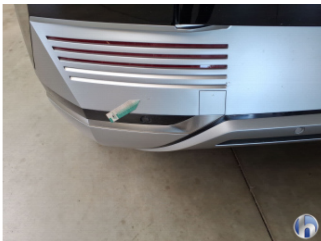
4. Stoßfänger Hinten Gebrauchsspuren - Ohne Reparatur
