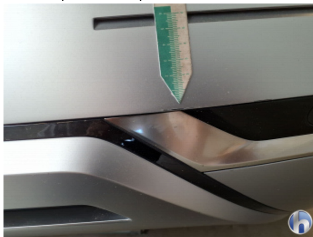
4. Stoßfänger Hinten Gebrauchsspuren - Ohne Reparatur
