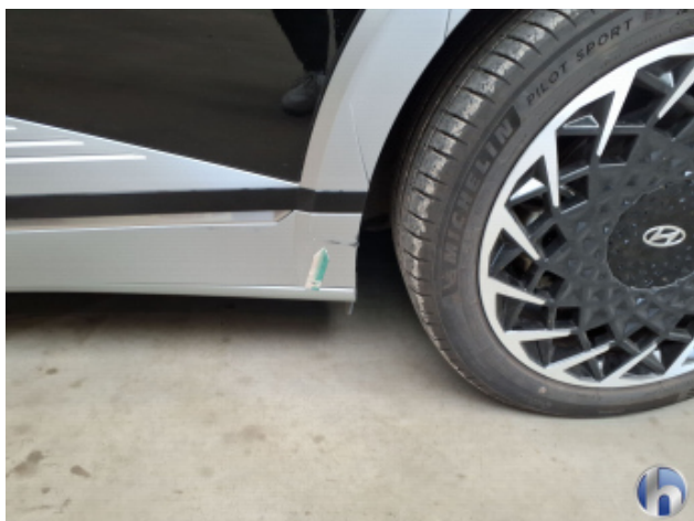
3. Schweller - Links Beschädigt - Erneuern
