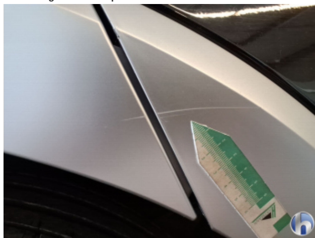
8. Zierleiste Beschädigt - Smart Repair
