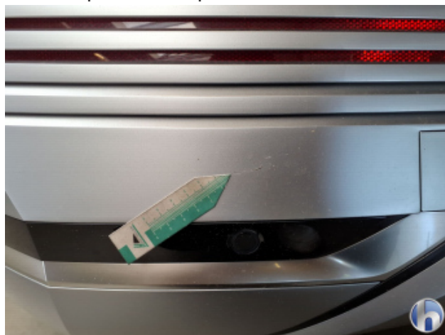
4. Stoßfänger Hinten Gebrauchsspuren - Ohne Reparatur
