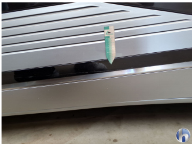
7. Türleisten I Beschädigt - Erneuern
