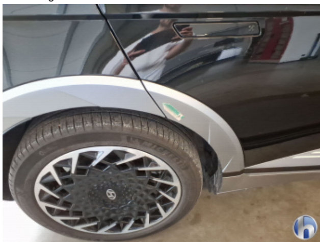
8. Zierleiste Beschädigt - Smart Repair
