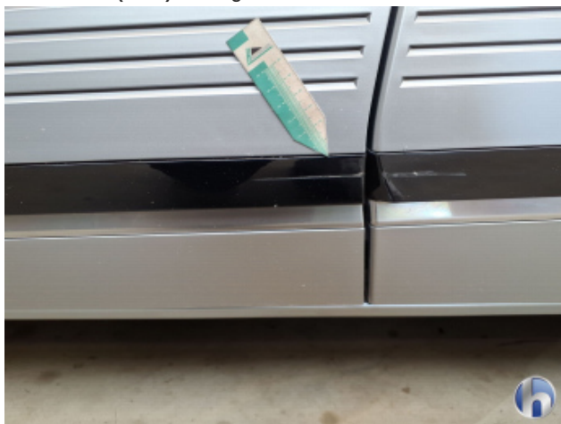
7. Türleisten I Beschädigt - Erneuern
