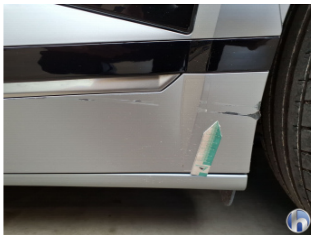
3. Schweller - Links Beschädigt - Erneuern
