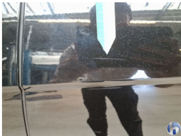
5. Tür Hinten - Links Oberflächenkratzer - Aufbereiten / Polieren
