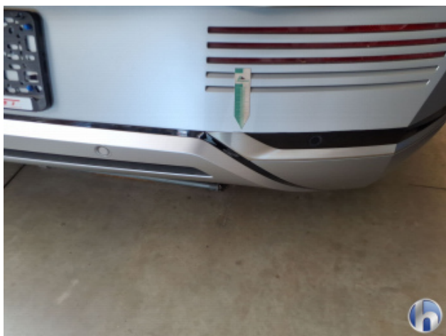
4. Stoßfänger Hinten Gebrauchsspuren - Ohne Reparatur
