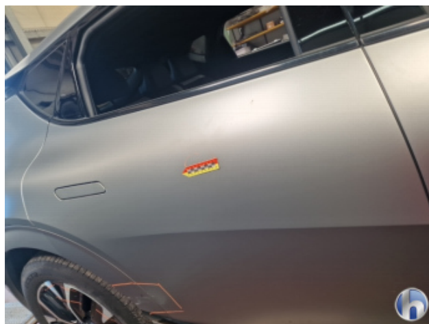
4. Tür Hinten - Rechts Kratzer - Sanft Instandsetzen
