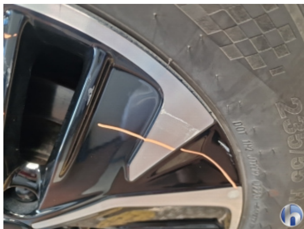
2. Felge Hinten - Rechts Beschädigt - Smart Repair
