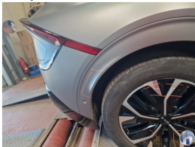
6. Seitenwand - Hinten - Rechts Kratzer - Smart Repair
