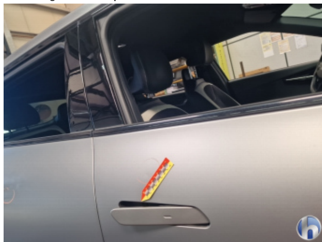
3. Tür Vorne - Rechts Delle - Sanft Instandsetzen
