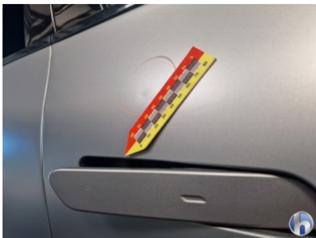
3. Tür Vorne - Rechts Delle - Sanft Instandsetzen
