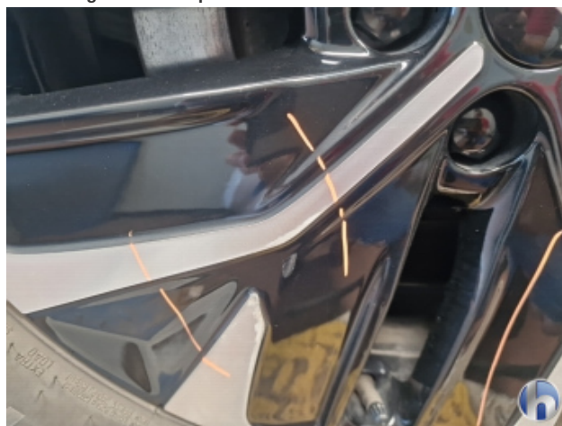
2. Felge Hinten - Rechts Beschädigt - Smart Repair
