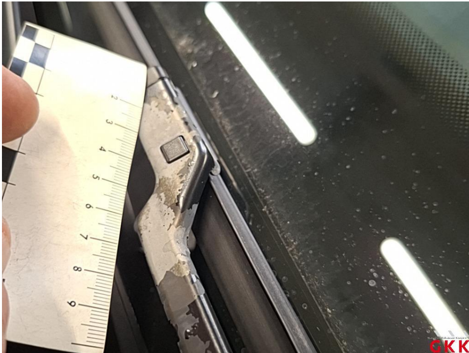
Bild 19 Scheibenwischer vorne, Arm links, beschädigt, ersetzen
