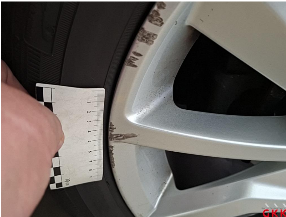
Bild 24 LM-Rad, hinten links, Materialabtrag, ersetzen
