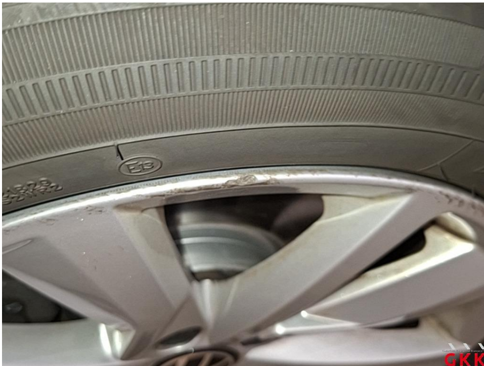
Bild 22 LM-Rad, vorne links, Materialabtrag, ersetzen
