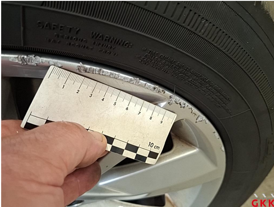
Bild 17 LM-Rad, vorne rechts, Materialabtrag, ersetzen
