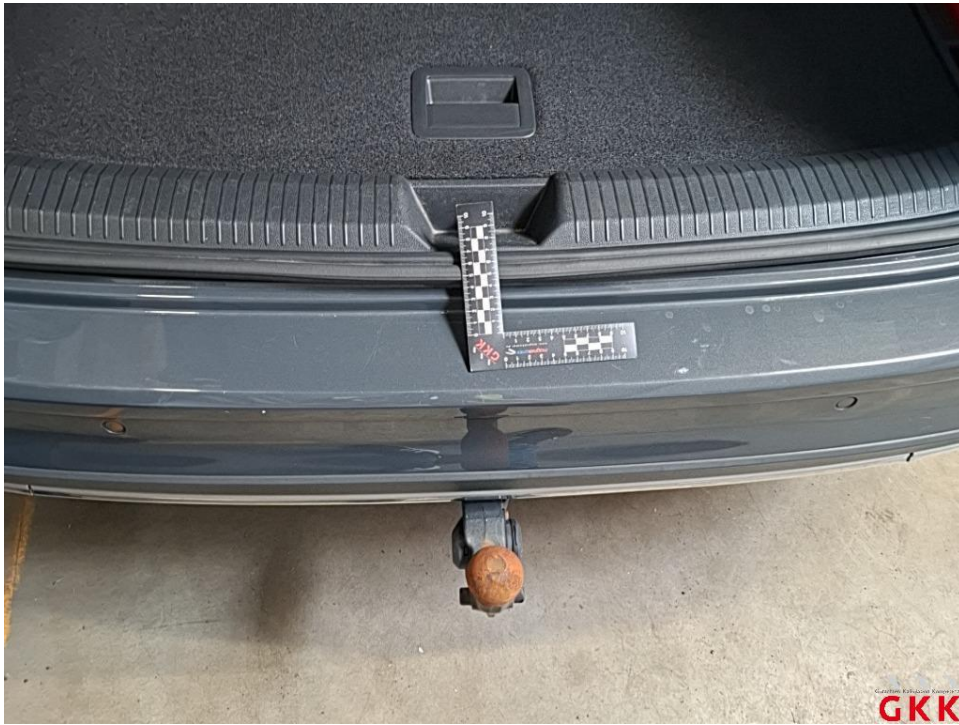
Bild 27 Stoßfänger hinten, Verkleidung -lackiert-, Reparaturmangel, lackieren
