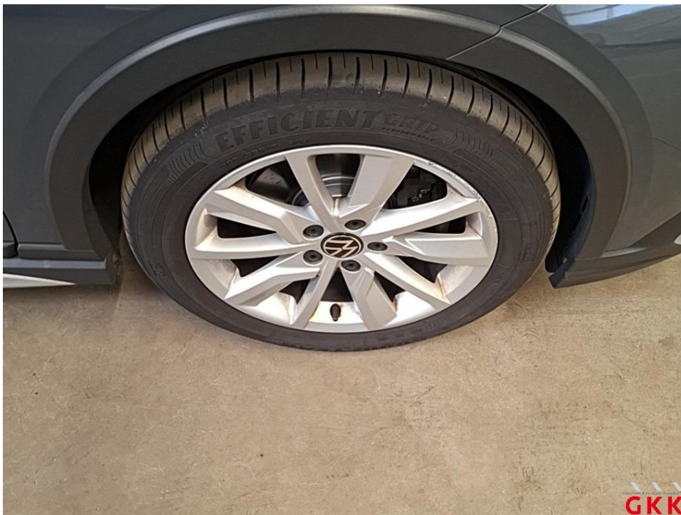
Bild 16 LM-Rad, vorne rechts, Materialabtrag, ersetzen
