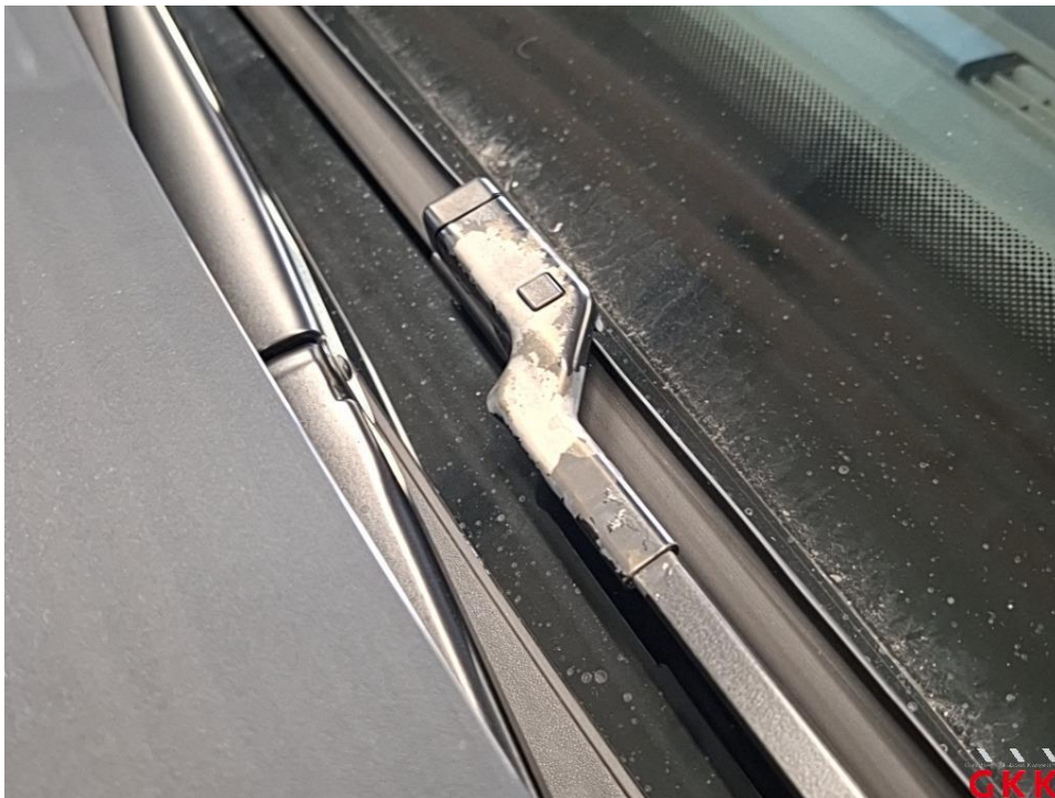
Bild 18 Scheibenwischer vorne, Arm links, beschädigt, ersetzen
