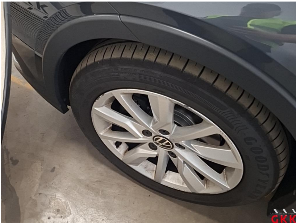
Bild 20 LM-Rad, vorne links, Materialabtrag, ersetzen
