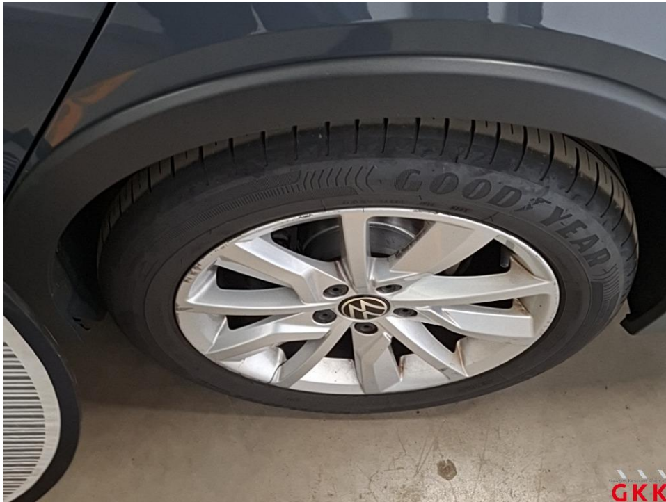
Bild 23 LM-Rad, hinten links, Materialabtrag, ersetzen
