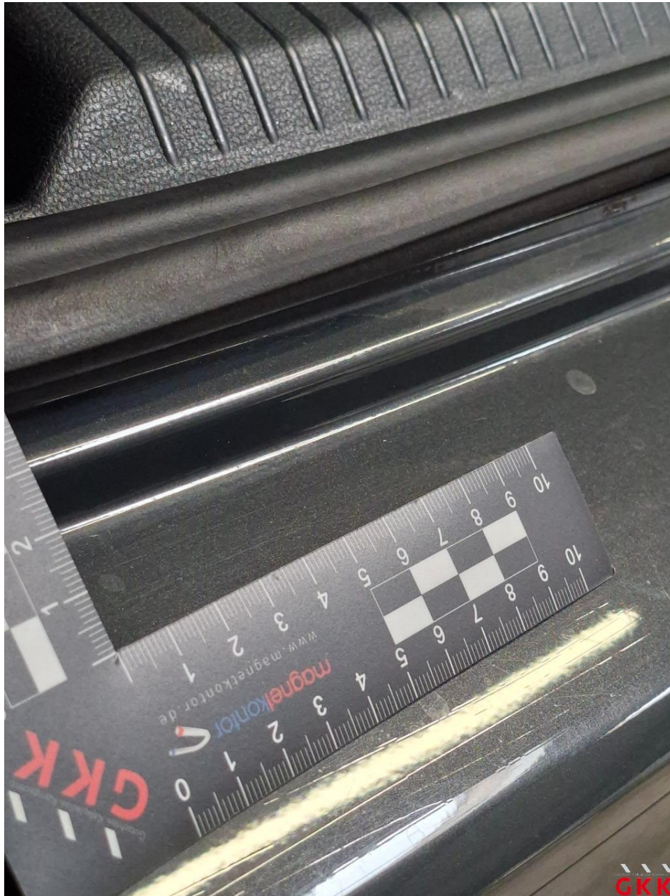
Bild 28 Stoßfänger hinten, Verkleidung -lackiert-, Reparaturmangel, lackieren
