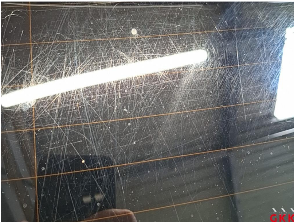
Bild 26 Heckscheibe, verkratzt, ersetzen
