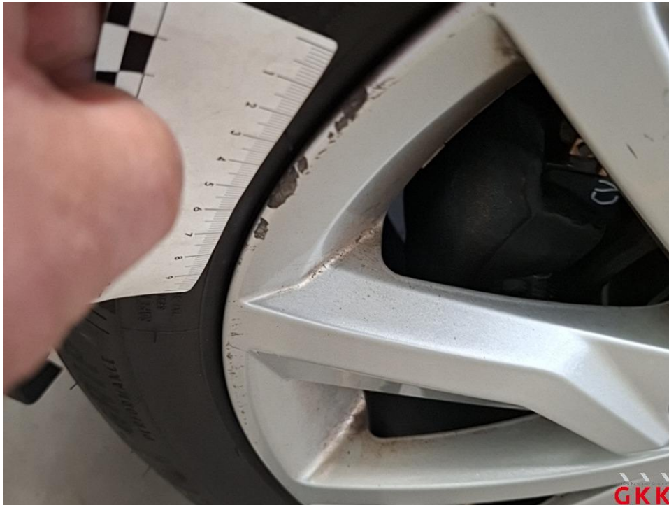
Bild 21 LM-Rad, vorne links, Materialabtrag, ersetzen
