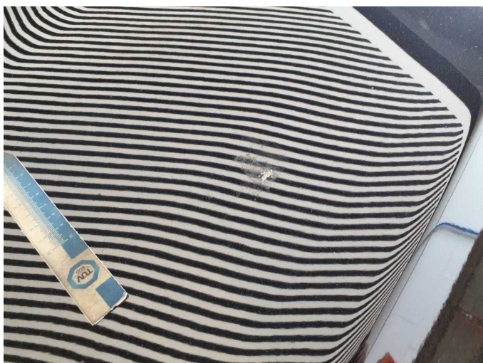
Damage 6: Bonnet: Bonnet (Anätzung-Mehrkosten möglich) - Paint defect - Conditioning
