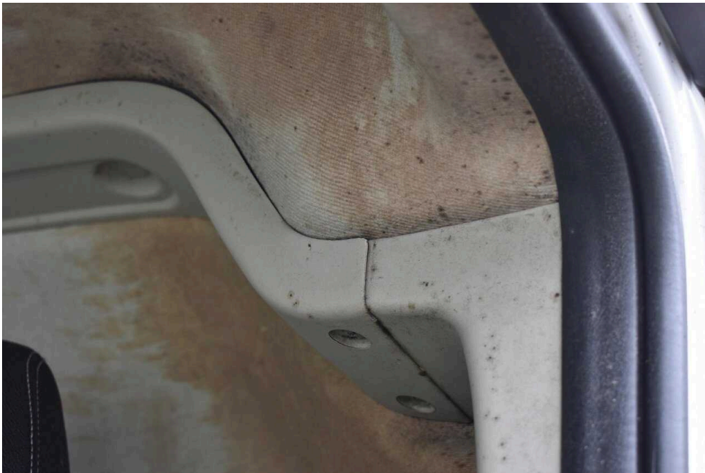
Bild 16 Innenraum Innenraum stark verschimmelt
