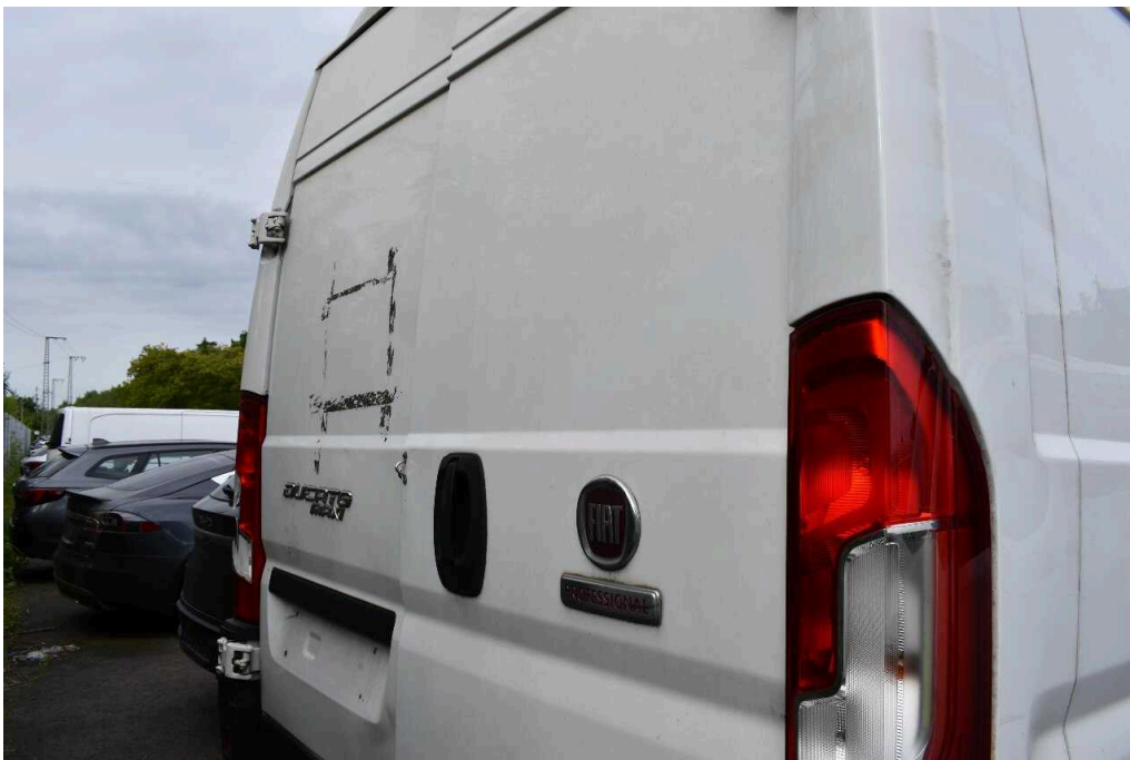
Bild 56 Fahrzeugheck Heckflügeltür rechts deformiert
