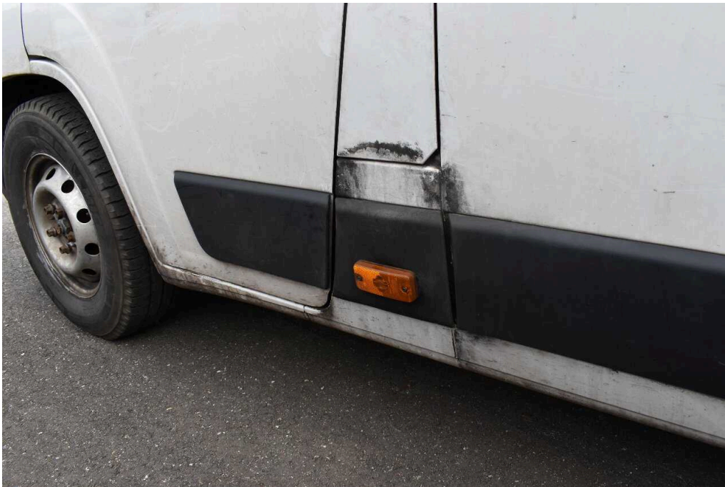
Bild 30 linke Seite B-Säule links Begrenzungsleuchte beschädigt
