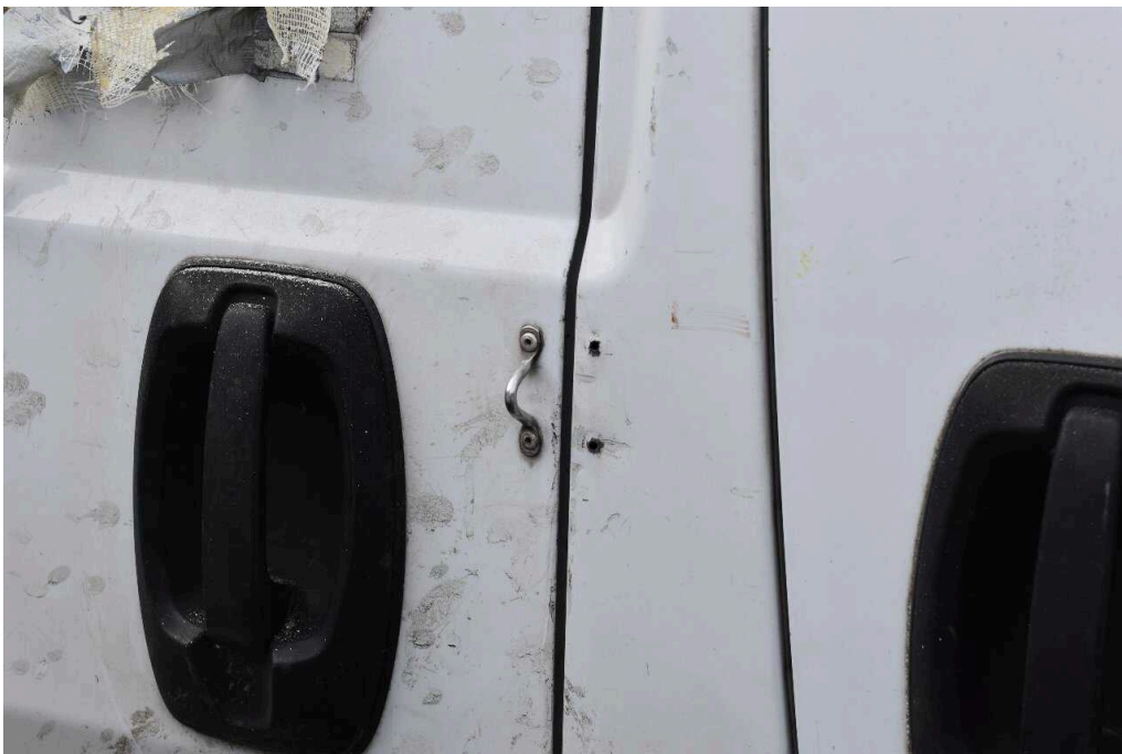
Bild 72 rechte Seite B-Säule rechts beschädigt
