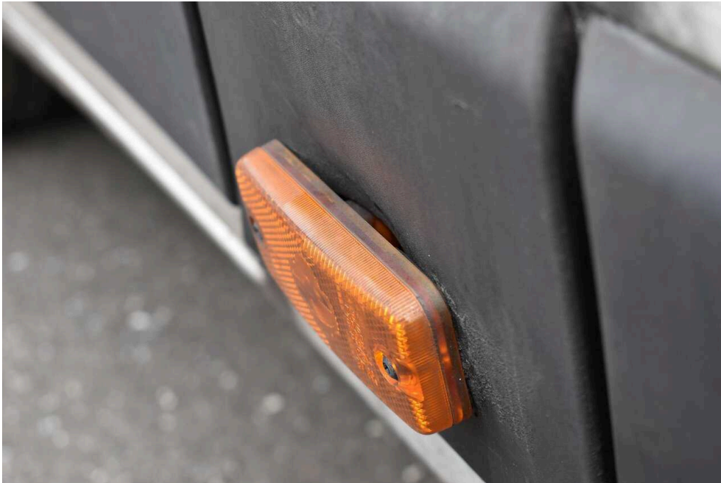
Bild 31 linke Seite B-Säule links Begrenzungsleuchte beschädigt
