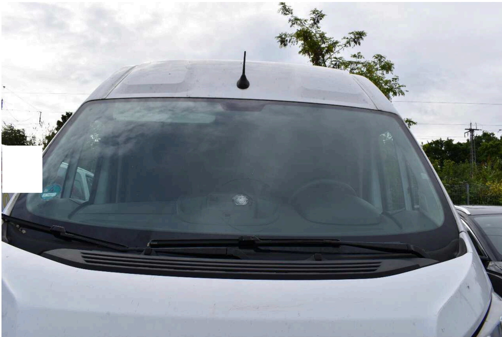
Bild 24 Fahrzeugfront Frontscheibe Steinschlag
