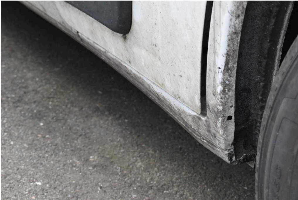
Bild 77 rechte Seite Tür vorne rechts deformiert,erneuern+lackieren,Kotflügel vo.re.deformiert,erneuern+lackieren
