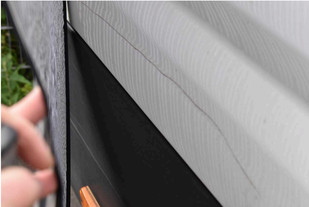
Bild 63 Fahrzeugheck Ecksäule hinten rechts deformiert, instandsetzen+lackieren, Seitenwand hi.re.deformiert, instandsetzen+lackieren, Schiebetüre re.deformiert, erneuern+lackieren
