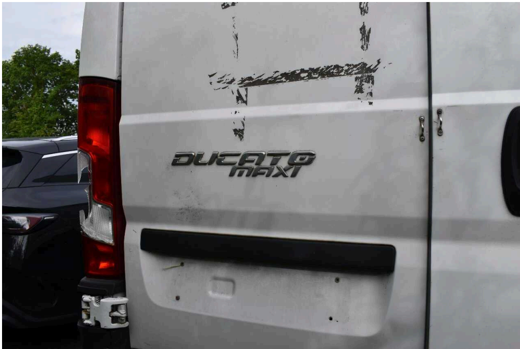
Bild 53 Fahrzeugheck Heckflügeltür links deformiert
