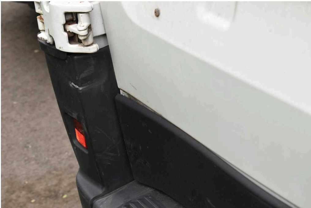
Bild 55 Fahrzeugheck Heckflügeltür links deformiert
