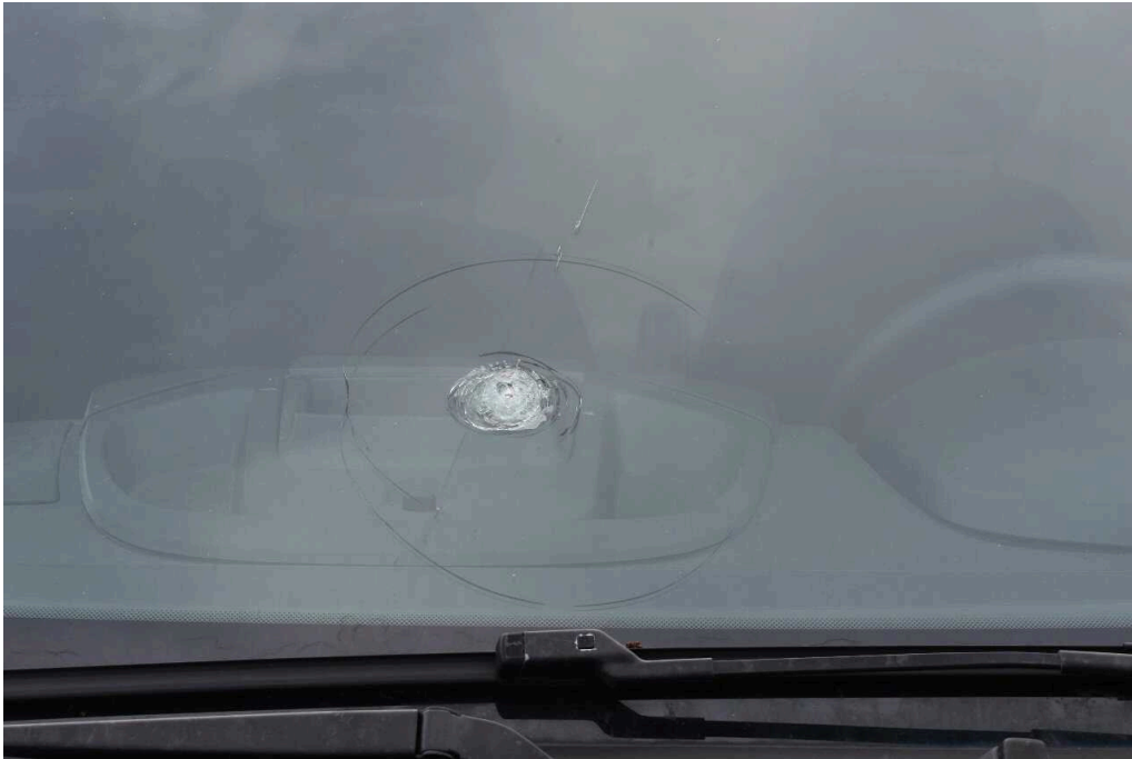
Bild 25 Fahrzeugfront Frontscheibe Steinschlag
