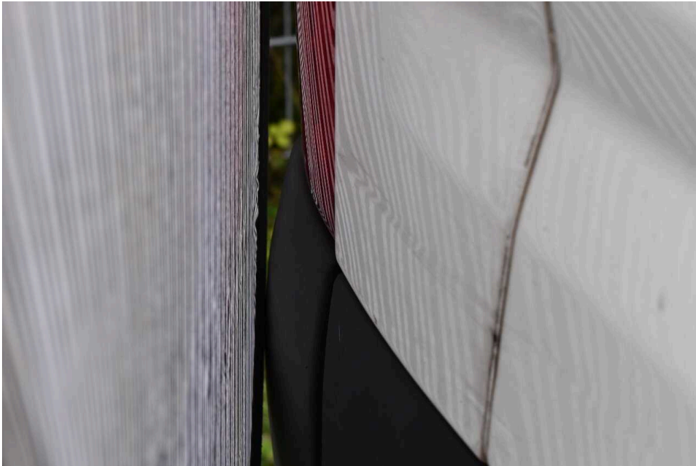
Bild 59 Fahrzeugheck Ecksäule hinten rechts deformiert, instandsetzen+lackieren, Seitenwand hi.re.deformiert, instandsetzen+lackieren, Schiebetüre re.deformiert, erneuern+lackieren
