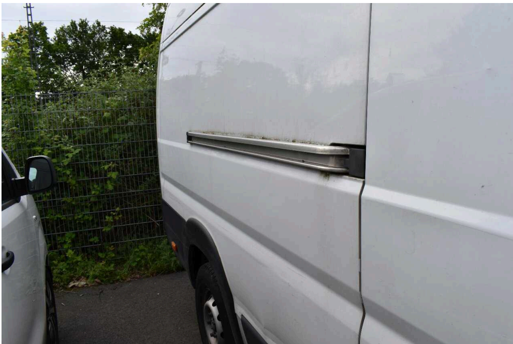
Bild 60 Fahrzeugheck Ecksäule hinten rechts deformiert, instandsetzen+lackieren, Seitenwand hi.re.deformiert, instandsetzen+lackieren, Schiebetüre re.deformiert, erneuern+lackieren
