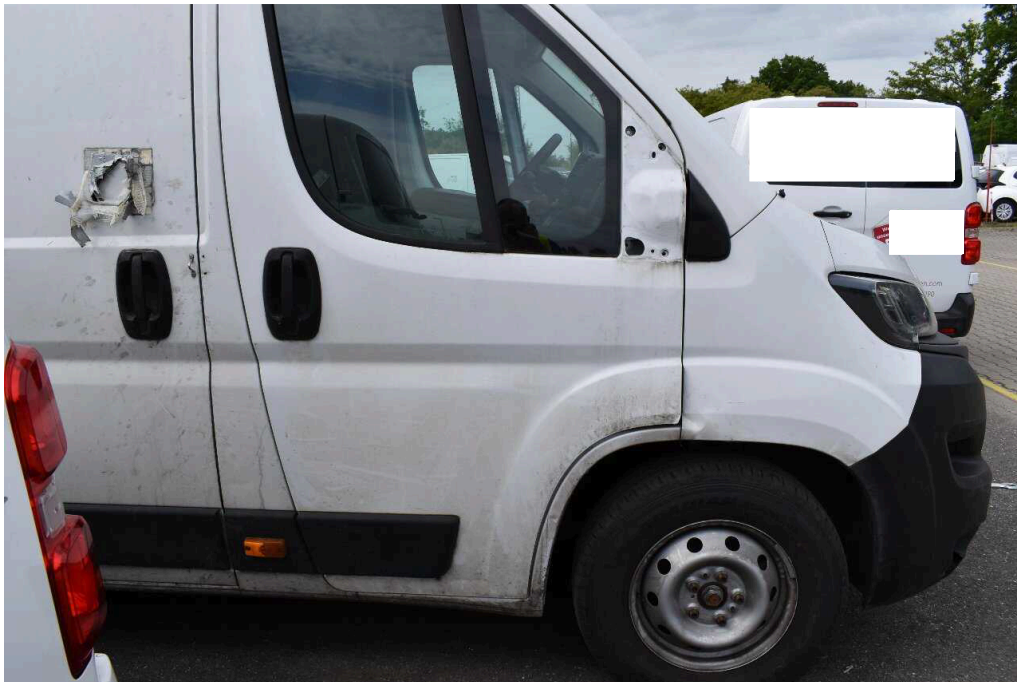
Bild 75 rechte Seite Tür vorne rechts deformiert,erneuern+lackieren,Kotflügel vo.re.deformiert,erneuern+lackieren
