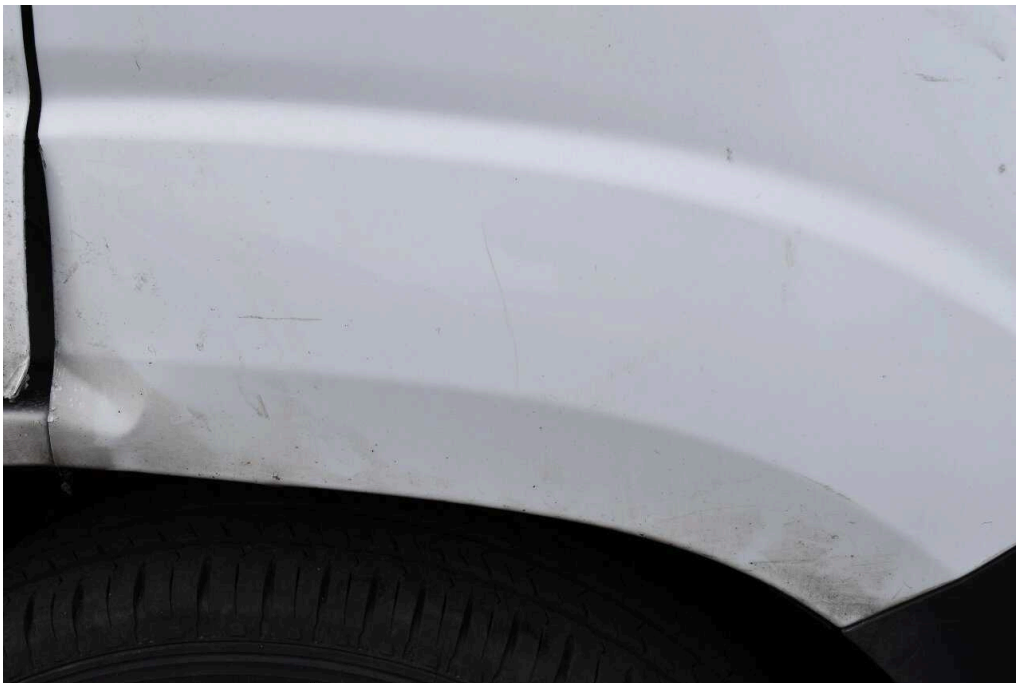
Bild 78 rechte Seite Tür vorne rechts deformiert,erneuern+lackieren,Kotflügel vo.re.deformiert,erneuern+lackieren
