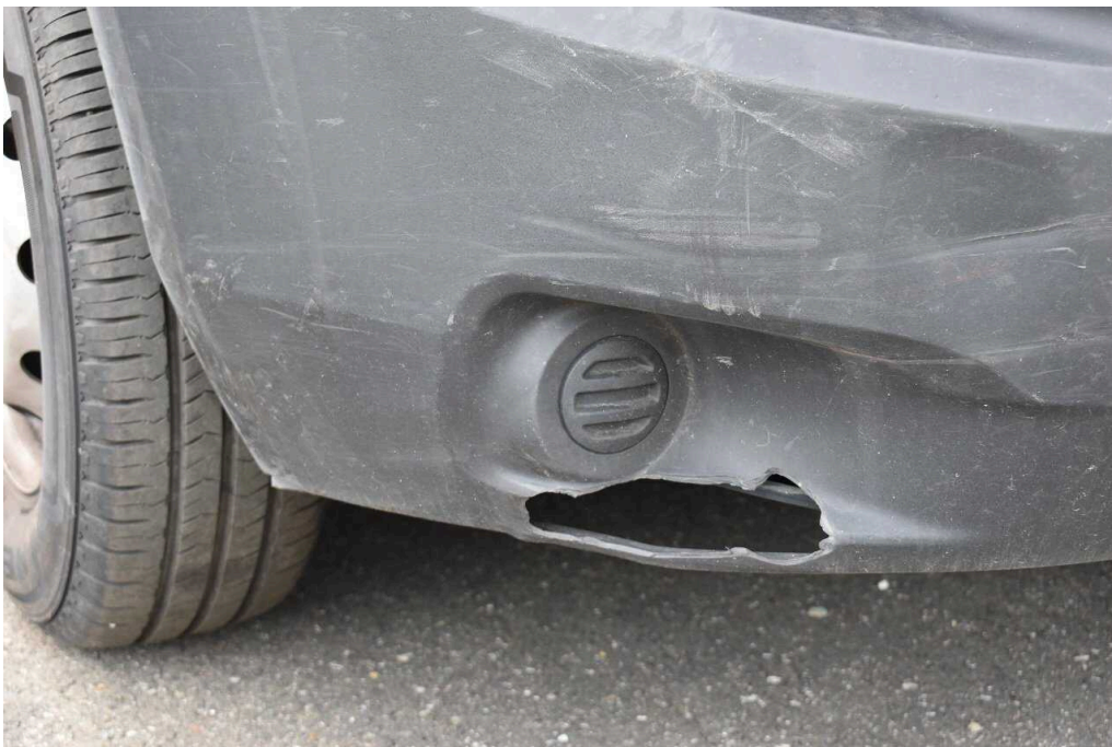
Bild 22 Fahrzeugfront Stoßfänger vorne gerissen / eingerissen
