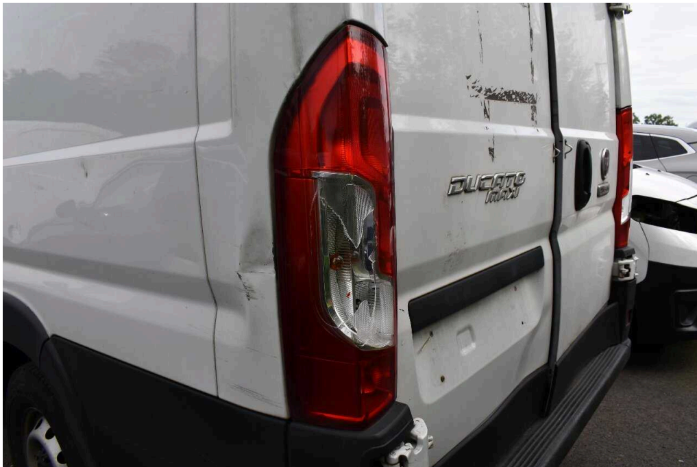
Bild 47 Fahrzeugheck Ecksäule hinten links deformiert, instandsetzen+lackieren, Rückleuchte li. gebrochen, erneuern
