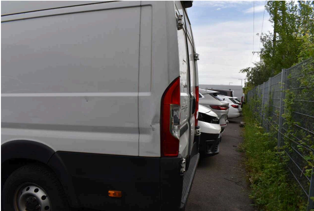
Bild 45 Fahrzeugheck Ecksäule hinten links deformiert, instandsetzen+lackieren, Rückleuchte li. gebrochen, erneuern
