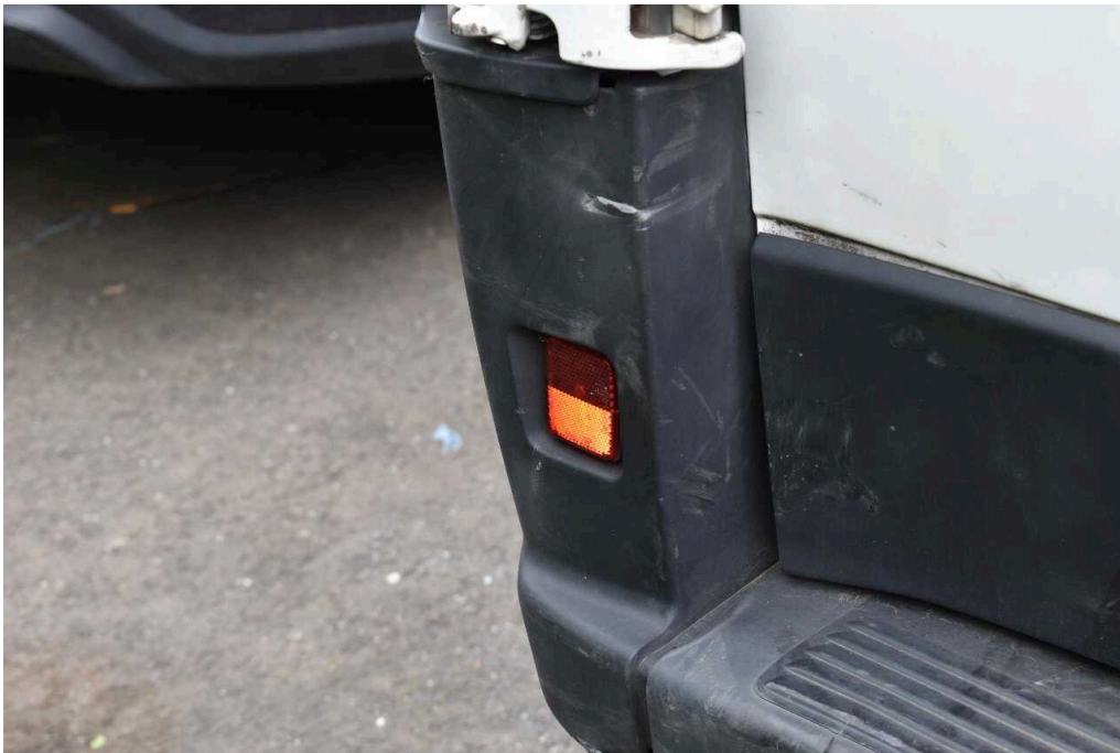
Bild 50 Fahrzeugheck Stoßfänger hinten deformiert
