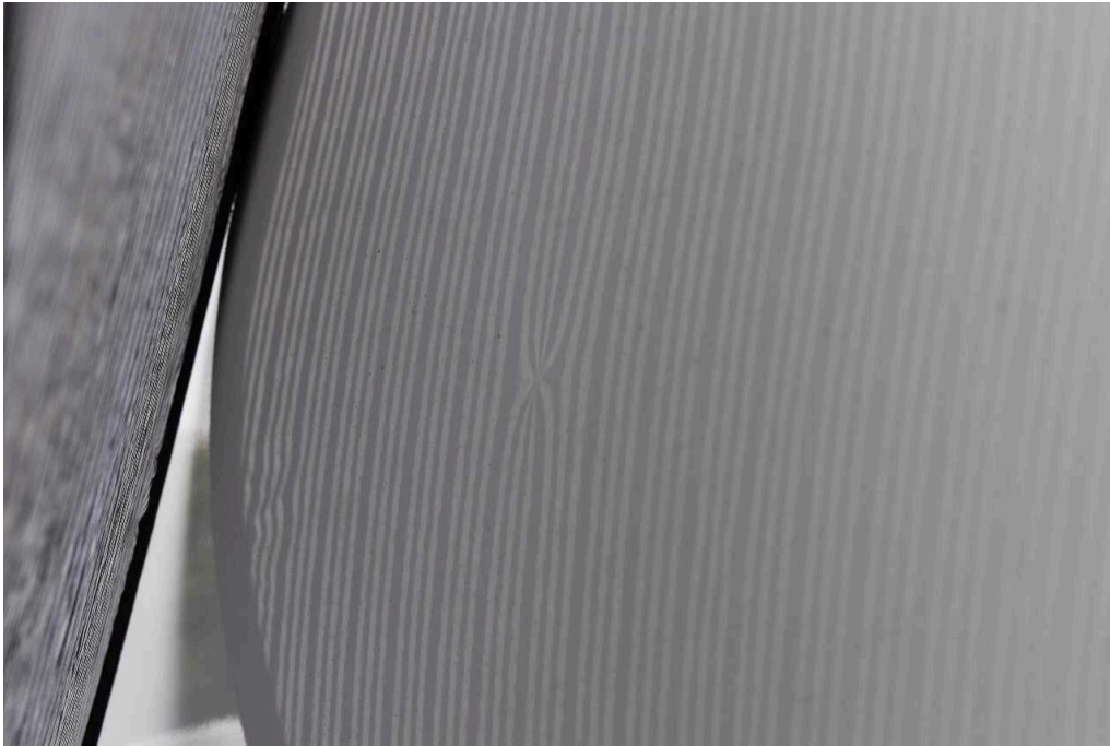
Bild 39 linke Seite Seitenwand hinten links deformiert
