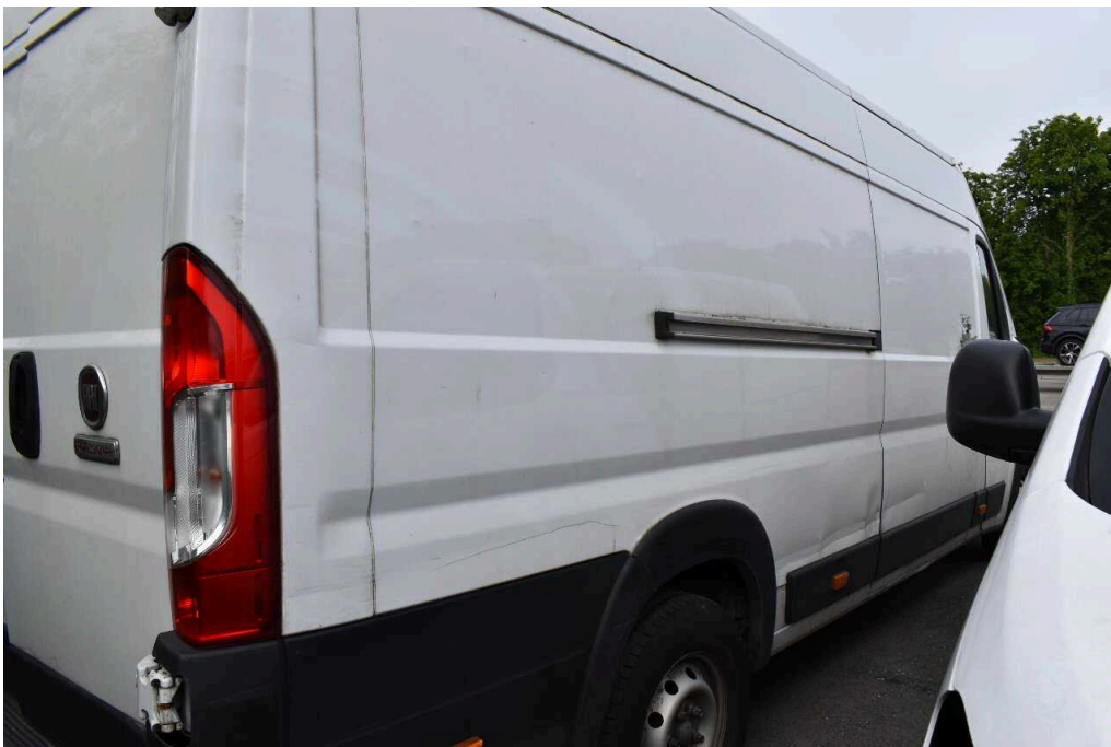
Bild 58 Fahrzeugheck Ecksäule hinten rechts deformiert, instandsetzen+lackieren, Seitenwand hi.re.deformiert, instandsetzen+lackieren, Schiebetüre re.deformiert, erneuern+lackieren
