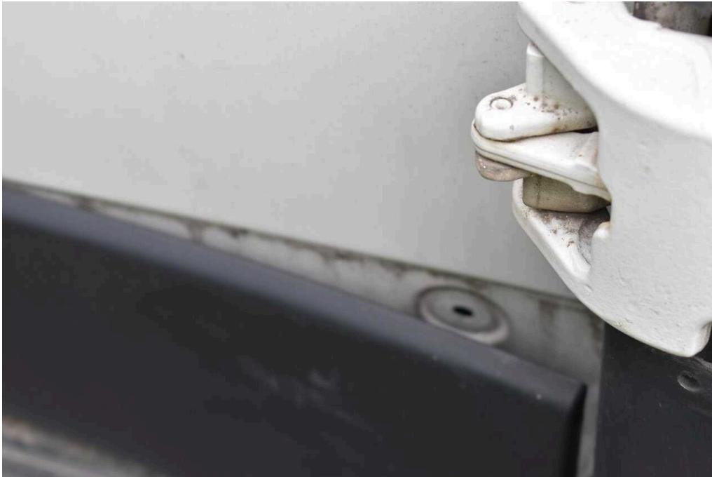
Bild 57 Fahrzeugheck Heckflügeltür rechts deformiert
