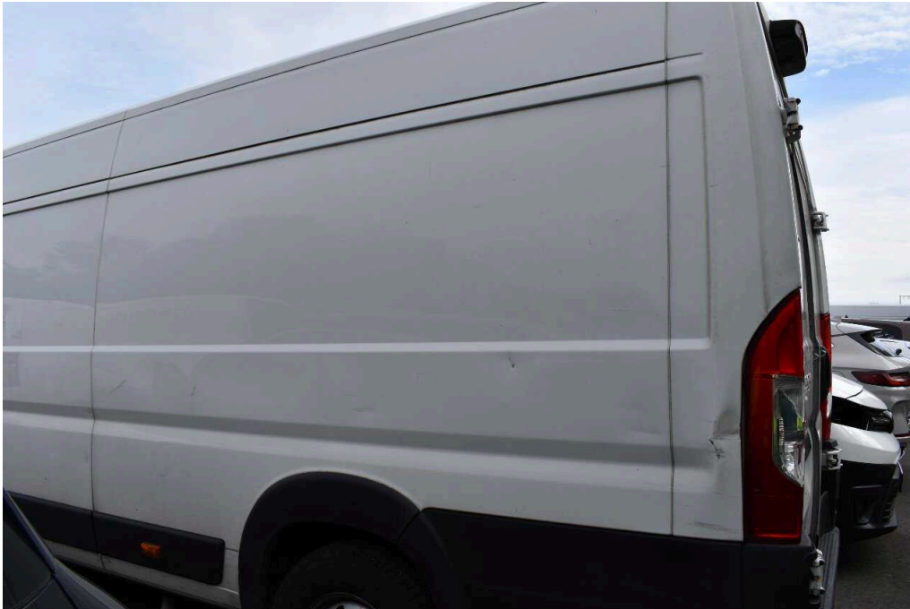
Bild 37 linke Seite Seitenwand hinten links deformiert
