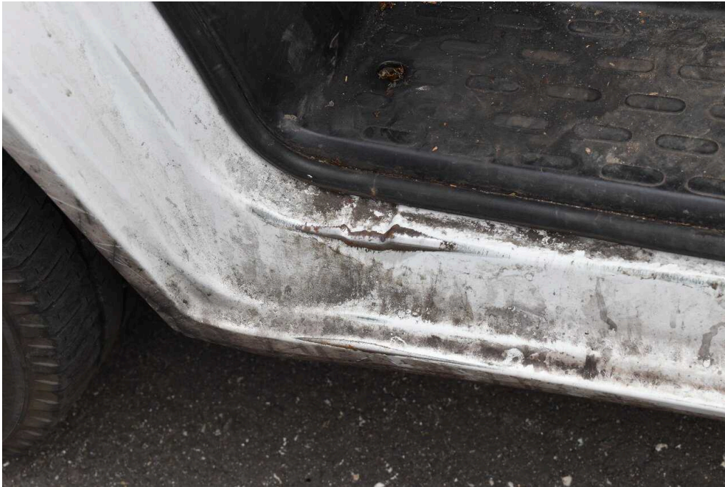
Bild 29 Innenraum Einstieg vorne links Kratzer
