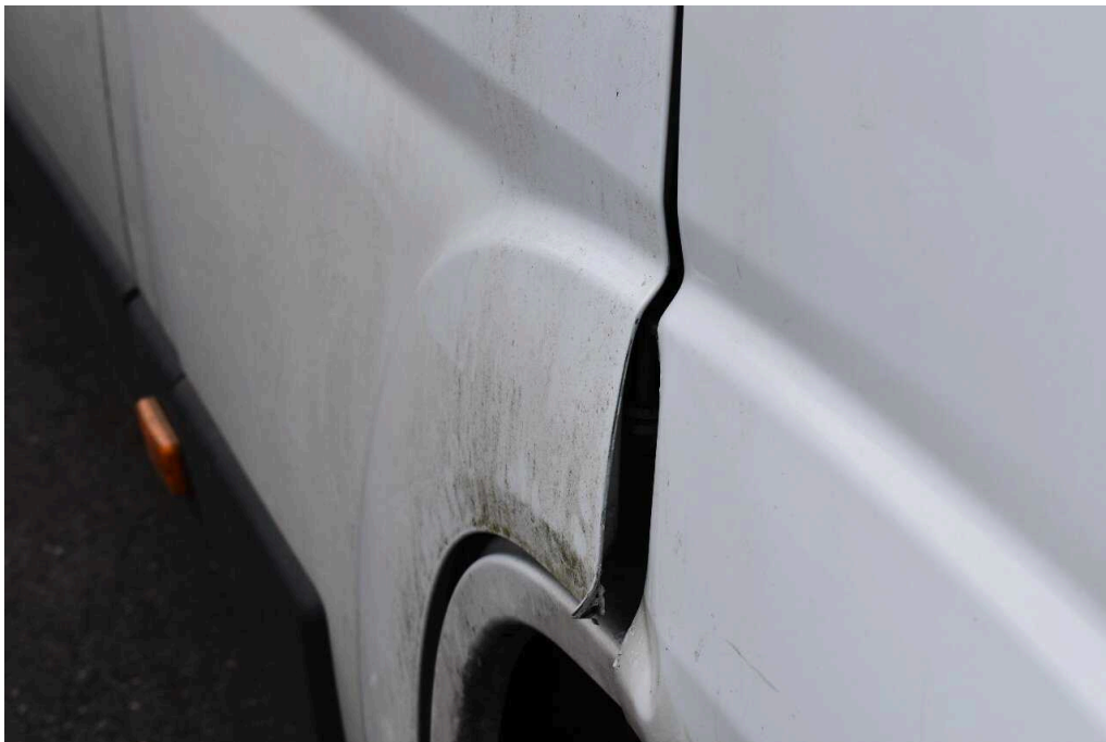
Bild 76 rechte Seite Tür vorne rechts deformiert,erneuern+lackieren,Kotflügel vo.re.deformiert,erneuern+lackieren
