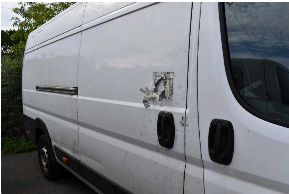
Bild 68 Fahrzeugheck Ecksäule hinten rechts deformiert, instandsetzen+lackieren, Seitenwand hi.re.deformiert, instandsetzen+lackieren, Schiebetüre re.deformiert, erneuern+lackieren
