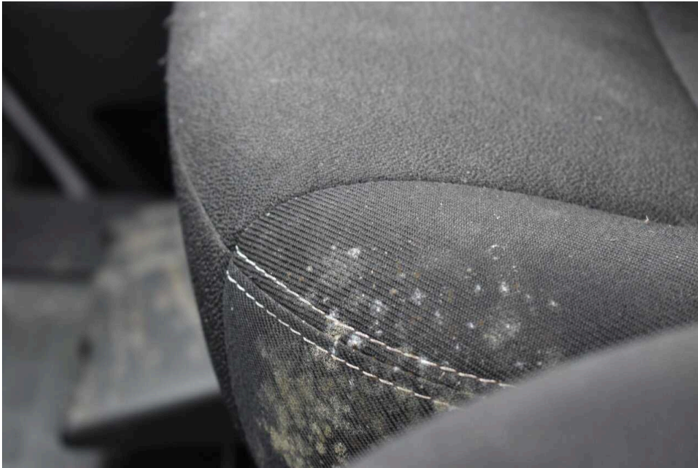
Bild 15 Innenraum Innenraum stark verschimmelt
