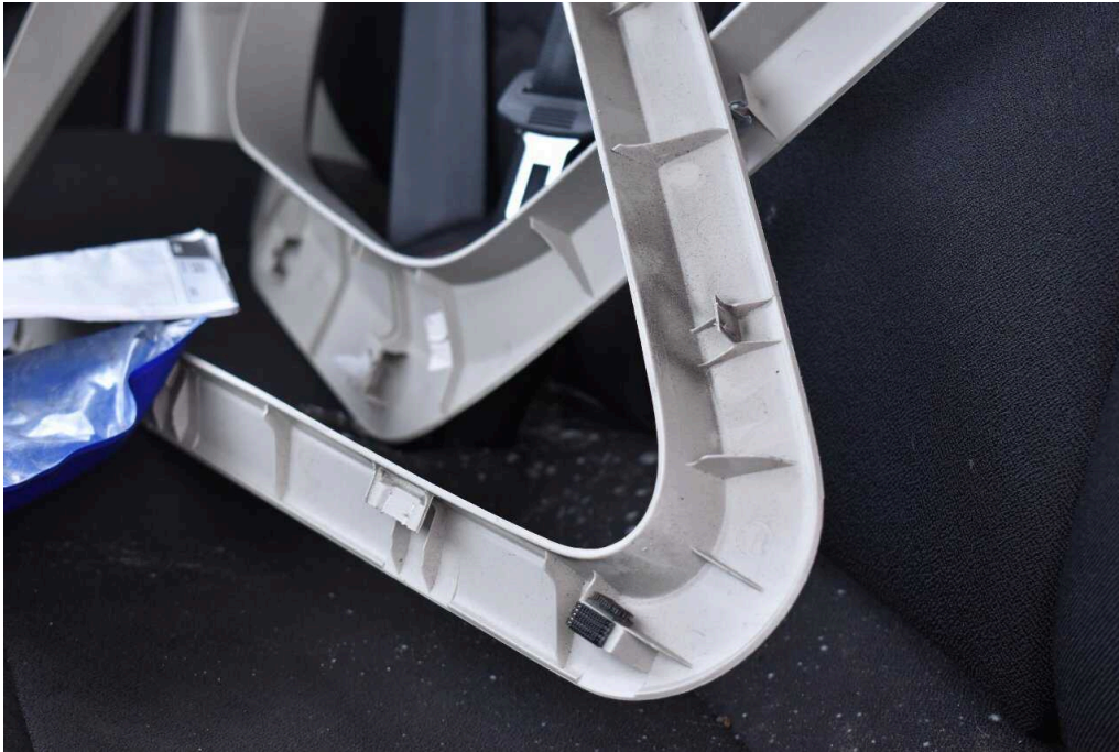
Bild 19 Innenraum Innenraum stark verschimmelt
