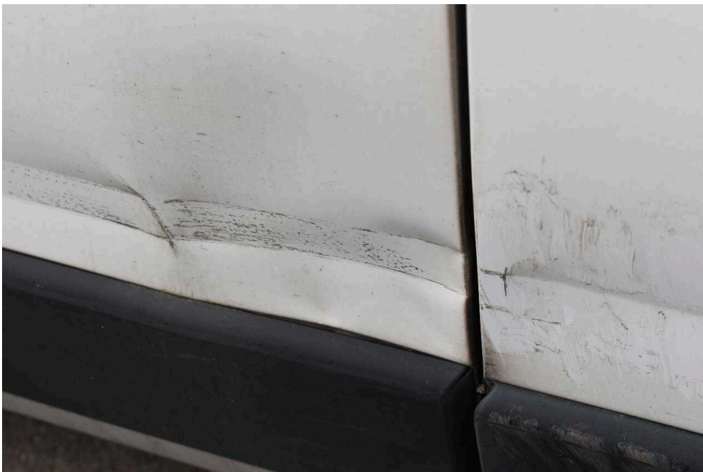
Bild 66 Fahrzeugheck Ecksäule hinten rechts deformiert, instandsetzen+lackieren, Seitenwand hi. re. deformiert, instandsetzen+lackieren, Schiebetüre re. deformiert, erneuern+lackieren
