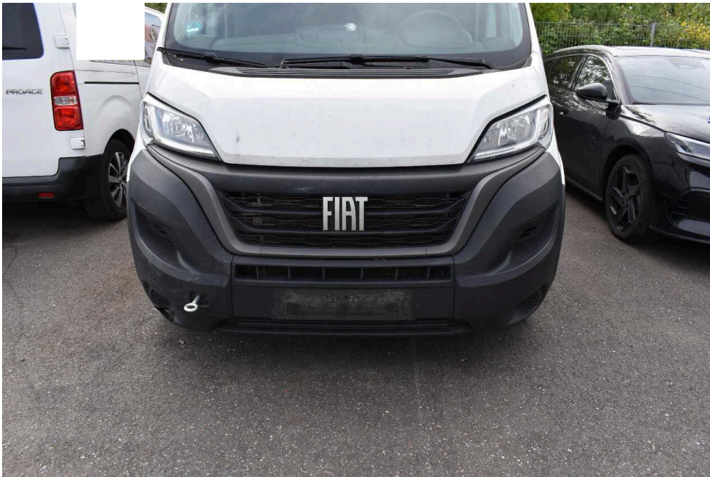
Bild 21 Fahrzeugfront Stoßfänger vorne gerissen / eingerissen
