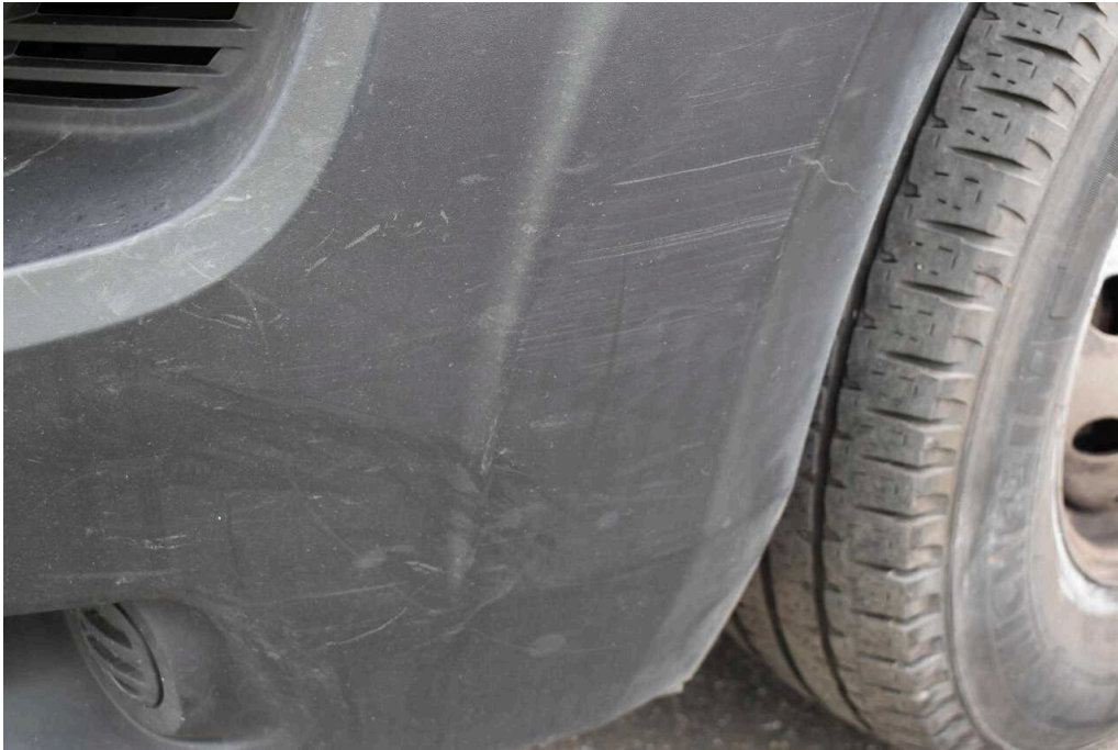
Bild 23 Fahrzeugfront Stoßfänger vorne gerissen / eingerissen
